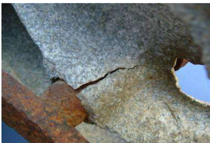
Slika 9. Lom steznog zatvarača (Alar, 2015.)
