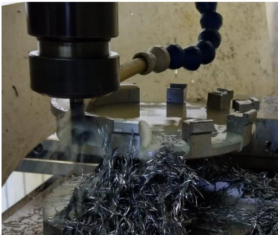
Slika 47. Glodanje poklopca korpe spojke
