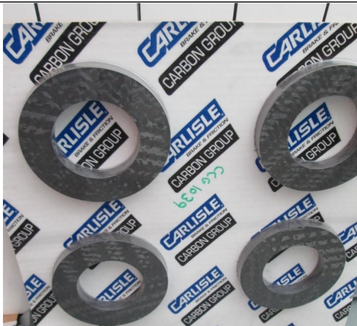
Slika 57. Sirove pločice od ugljičnih vlakana
