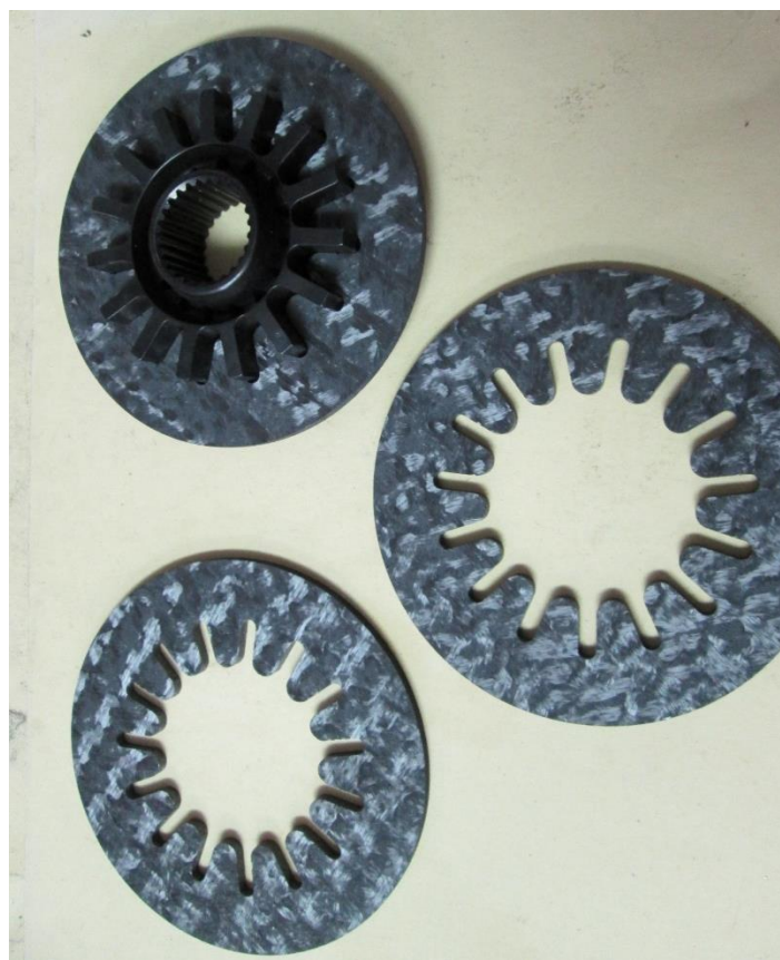
Slika 58. Proba unutarnje lamele s jezgrom spojke
