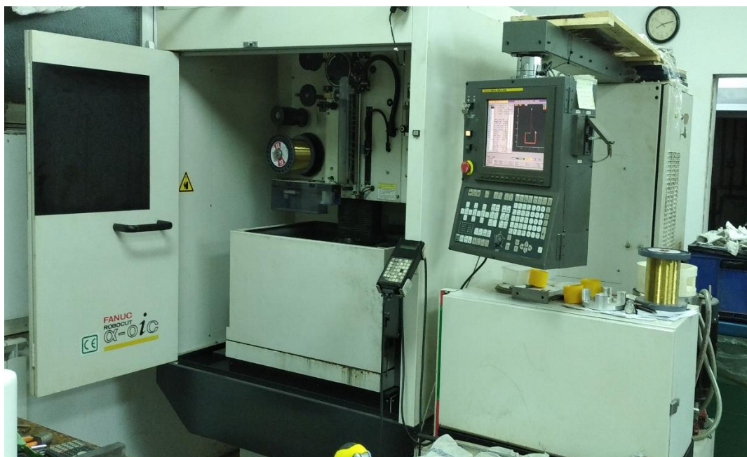
Slika 51. EDM Fanuc RoboCut
