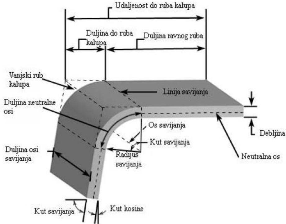
Slika 4: Prikaz parametara obrade pri savijanju limova [8]
