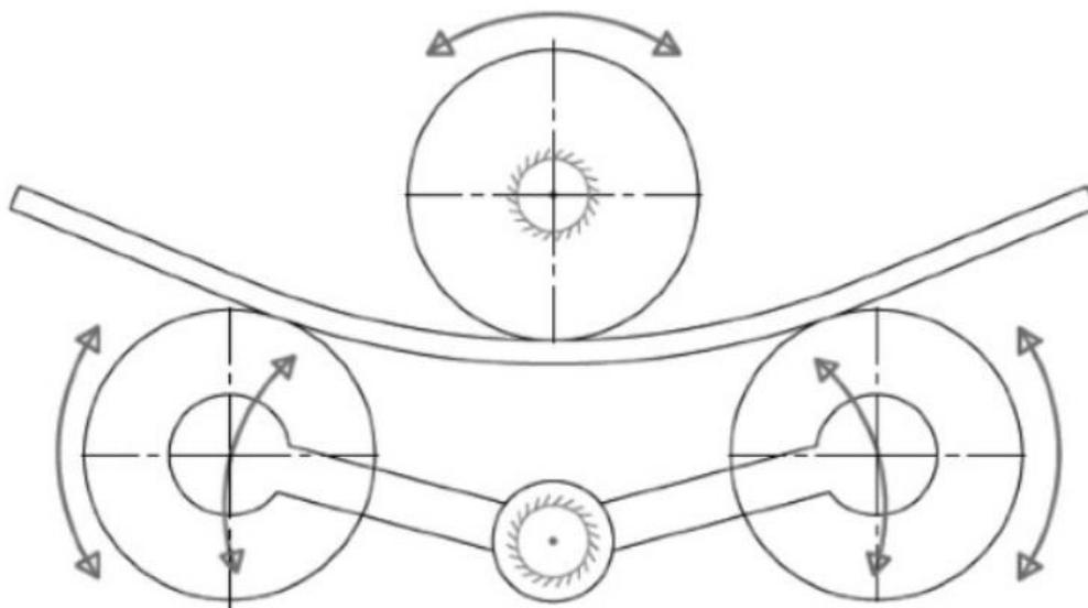
Slika 7: Shematski prikaz savijačice s 3 valjka [16]
