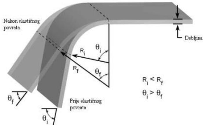
Slika 5: Elastični povrat lima nakon savijanja [8]
