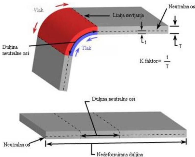
Slika 3: Prikaz naprezanja pri savijanju lima [8]
