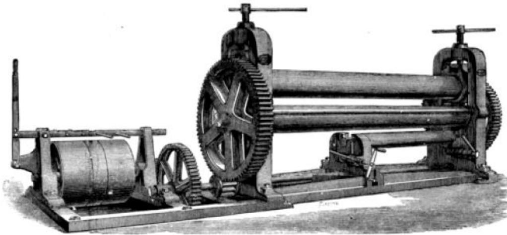
Slika 6: Muzejski primjerak savijačice s 3 valjka [14]
