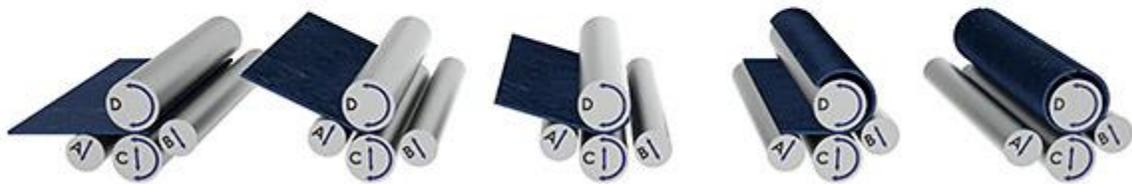
Slika 8: Prikaz rada na savijačici s 4 valjka [15]
