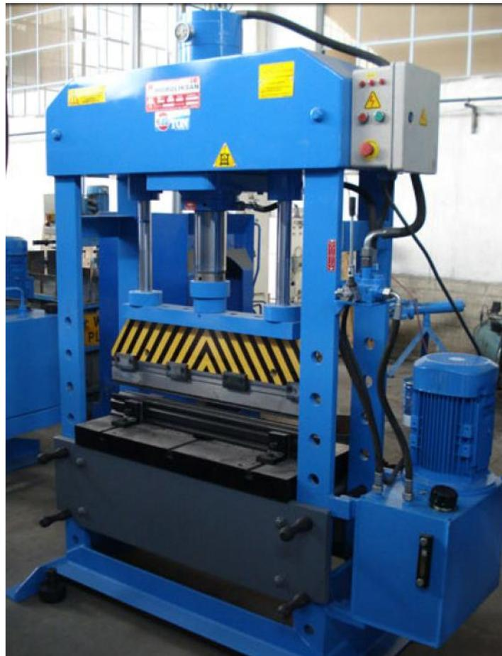
Slika 12: Hidraulička savijačica [14]
