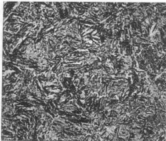
*Slika 3. Visokopopušteni martenzit u mikrostukturi poboljšanog čelika
