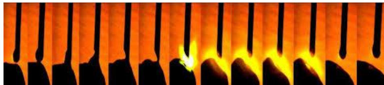
Slika 25. Odvajanje kaplice električnim lukom kod FastROOT postupka [24]
