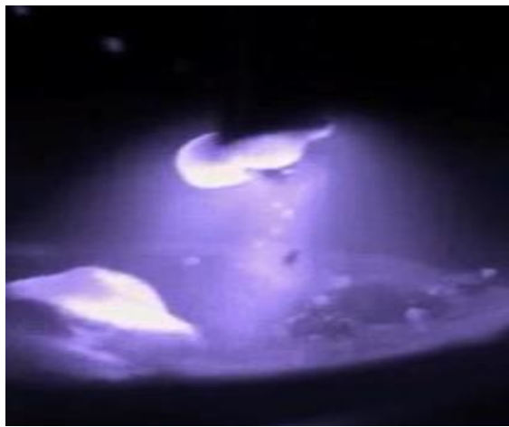
Slika 8. Realni prikaz prijenosa metala kratkim spojem [9]
