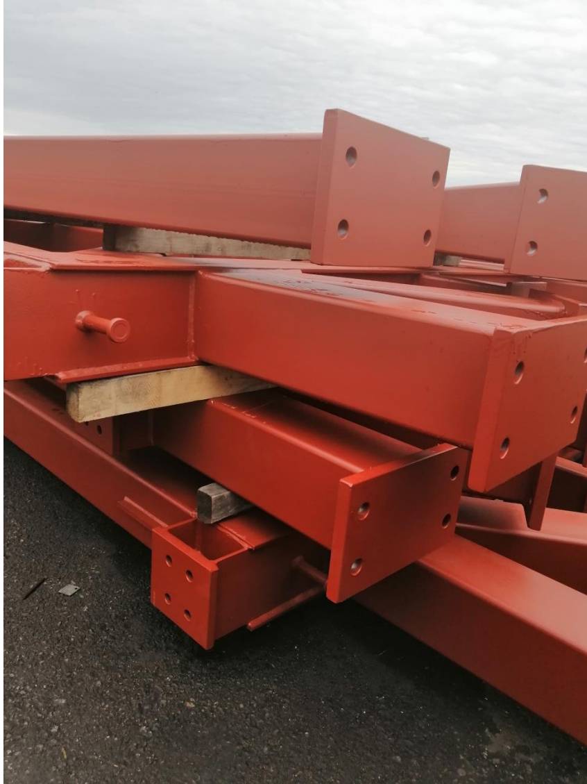
Slika 64. Odloženi sklopovi spremni za transport
