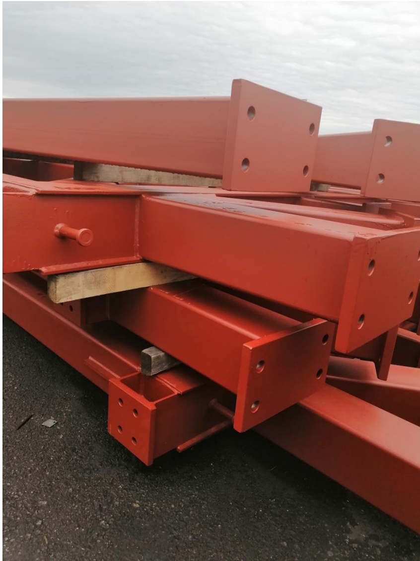
Slika 64. Odloženi sklopovi spremni za transport
