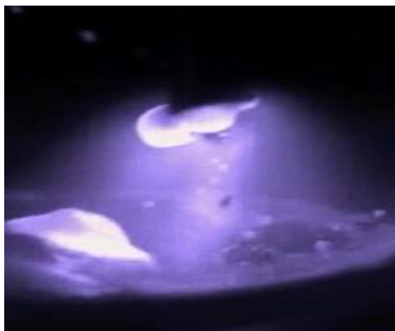
Slika 8. Realni prikaz prijenosa metala kratkim spojem [9]
