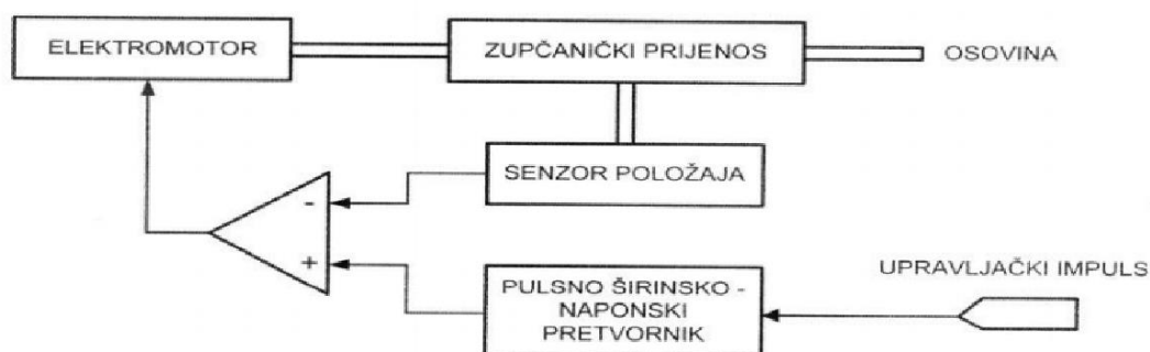
Slika 17. Blok dijagram sustavnih dijelova servo motora.
