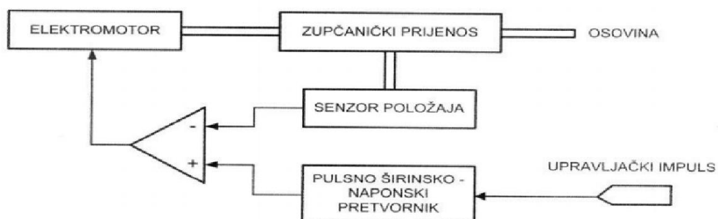
Slika 17. Blok dijagram sustavnih dijelova servo motora.
