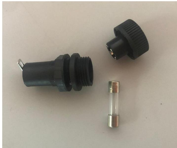
Slika 19. Korišteni fuse 3.15A sa kućištem
