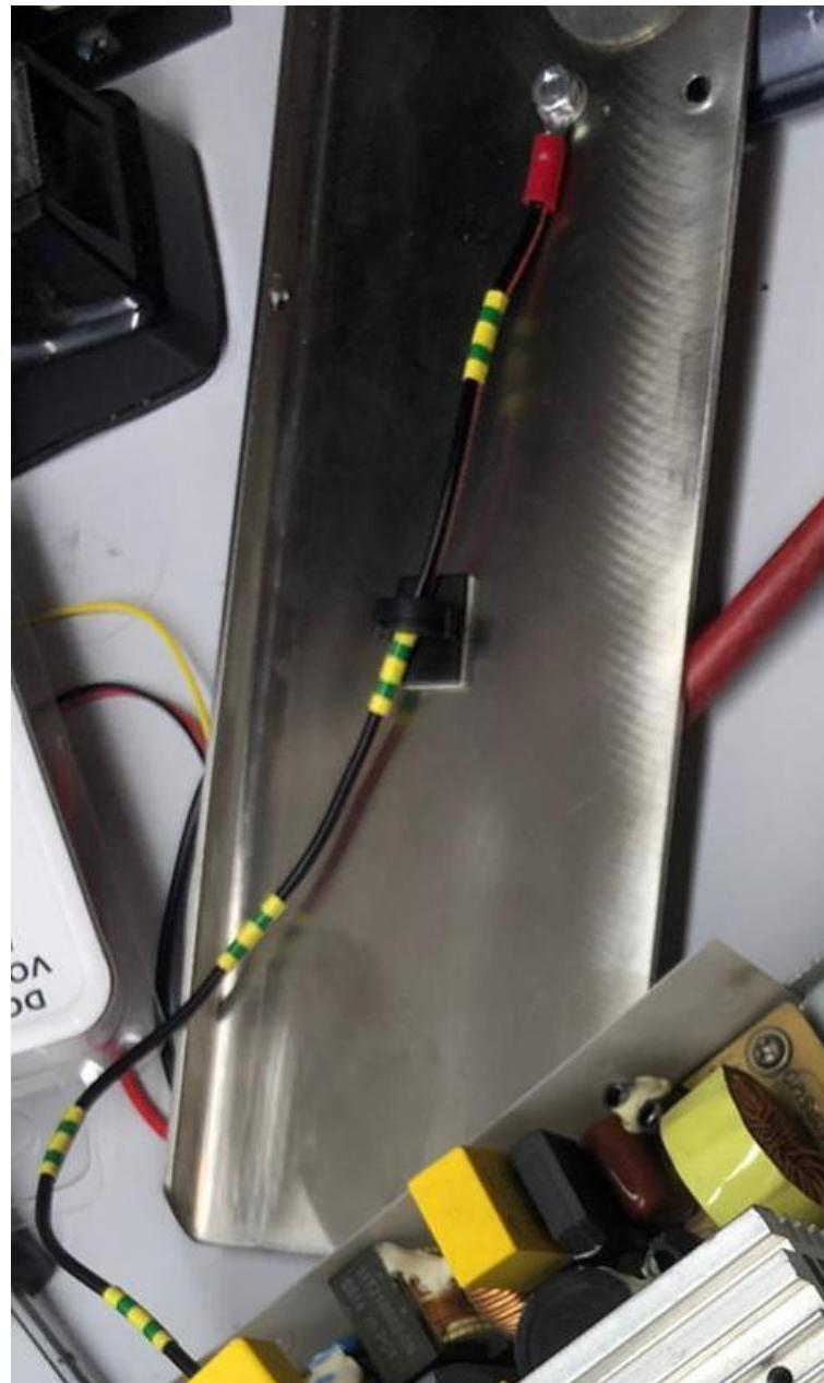
Slika 28. Provjedba uzemljenja kućišta
