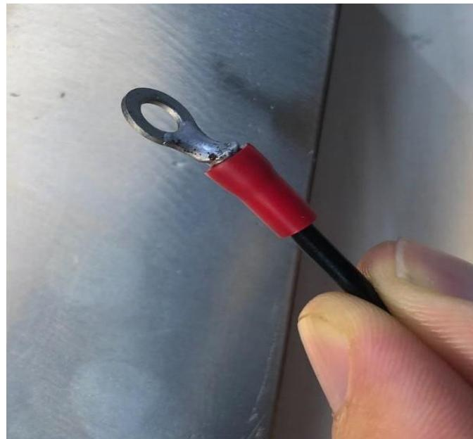
Slika 22. Korištena stopica (okasta) u svrhu uzemljenja kućišta
