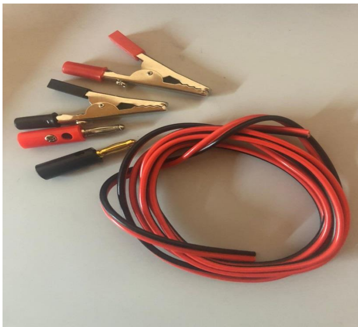
Slika 20. Kabel za napajanje 2x0.75
