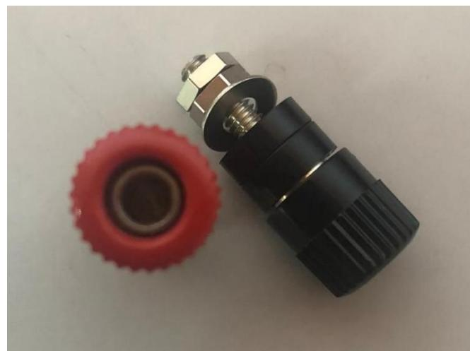
Slika 18. Korištene priključnice 6mm
