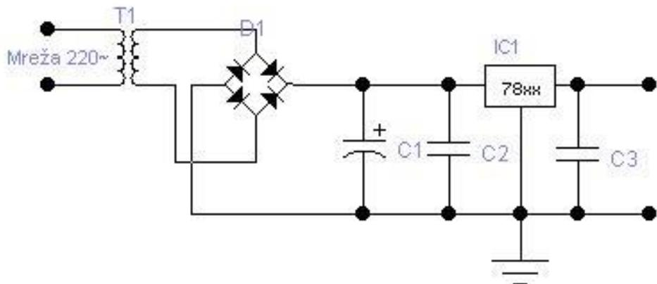
Slika 2. Shema istosmjernog napajanja [1]
