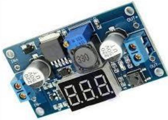
Slika 8. Modul regulatora napona sa LCD prikazom
