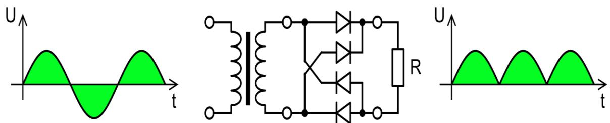
Slika 6. Diode u Graetz-ovom spoju
