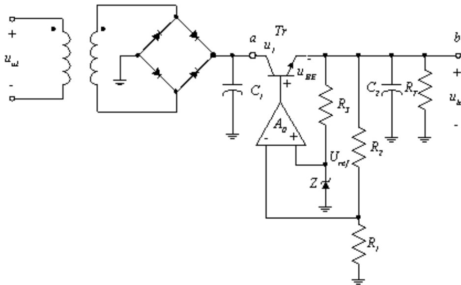
Slika 9. Izvor napajanja sa serijskim regulatorom i punovalnim ispravljačem
