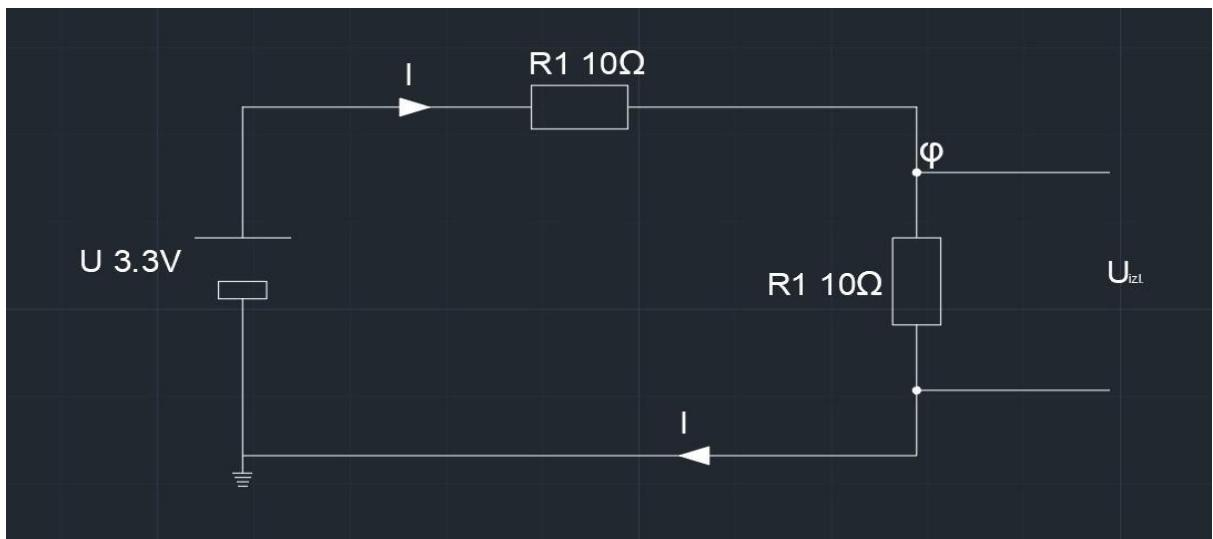
Slika 30. Dijelilo napona potrebnih za napajanje komponente
