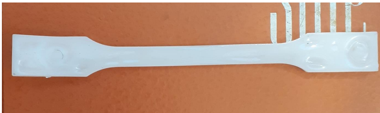
Slika 54. Izgled ispitnog uzorka sa previsokim indeksom tečenja
