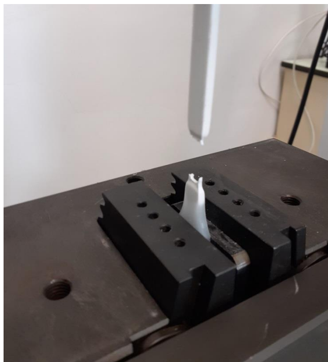
Slika 45. Kidanje ispitnog uzorka
