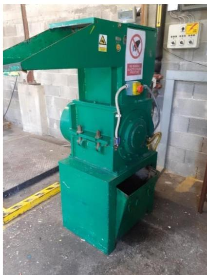
Slika 47. Mlin za usitnjavanje polimernih masa MG – 200
