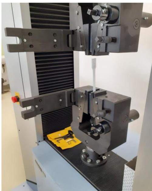
Slika 43. Postavljanje ispitnog uzorka u čeljusti kidalice
