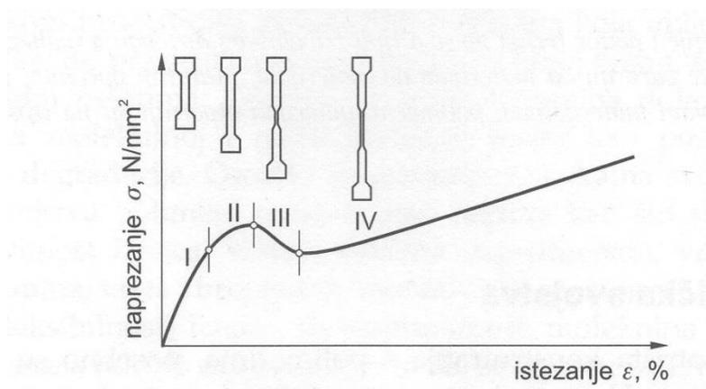
Slika 19. Dijagram naprezanje - istezanje kristalastih plastomera [14]
