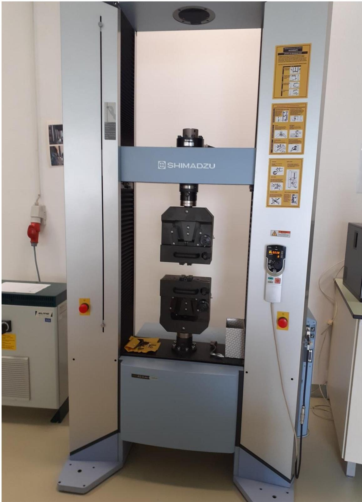
Slika 49. Kidalica Schimadzu AG – X plus
