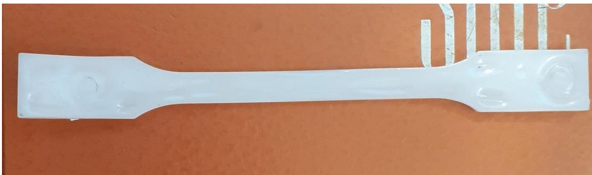
Slika 54. Izgled ispitnog uzorka sa previsokim indeksom tečenja
