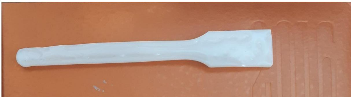
Slika 55. Izgled ispitnog uzorka sa pre niskim indeksom tečenja
