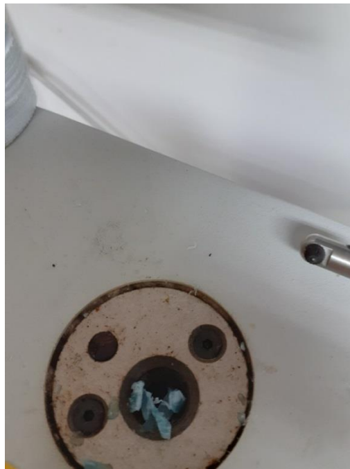
Slika 41. Utiskivanje polimera u otvor uređaja za mjerenje MFR-a
