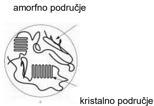
Slika 15. Makromolekularna struktura kristalastih plastomera [21]
