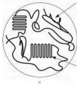
Slika 15. Makromolekularna struktura kristalastih plastomera [21]
