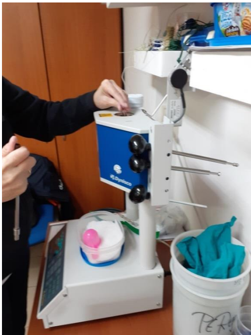
Slika 41. Utiskivanje polimera u otvor uređaja za mjerenje MFR-a
