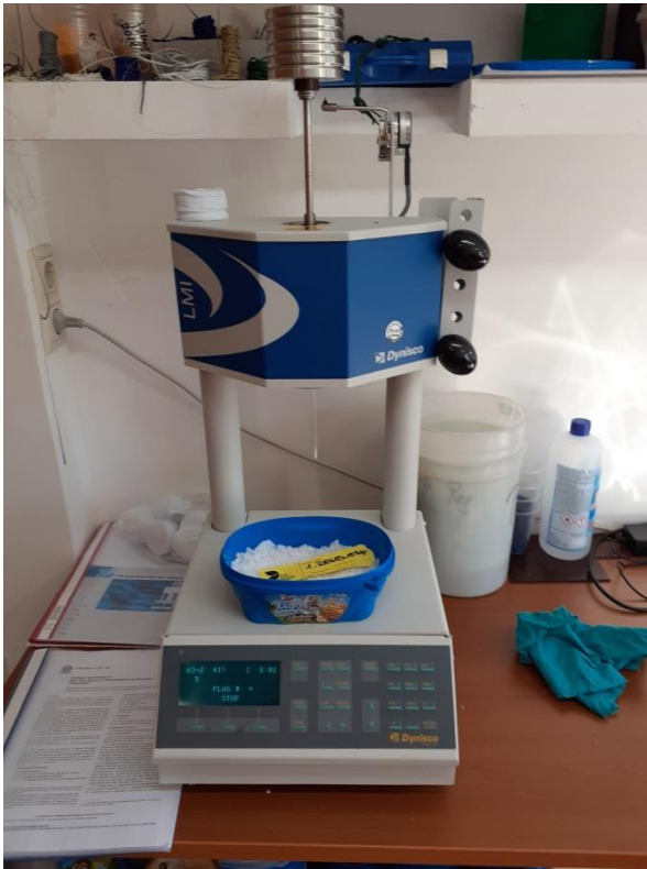
Slika 39. Uređaj za mjerenje indeksa tečenja Slika 40. Shema mjerenja MFR [39]
