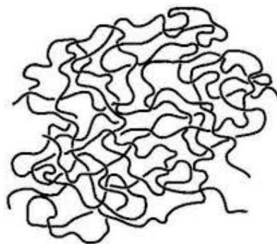
Slika 14. Makromolekularna struktura amornih plastomera [20]
