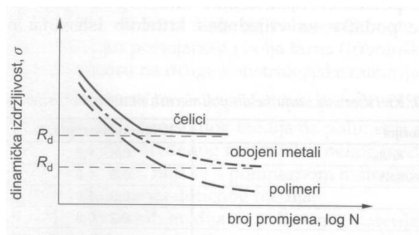
Slika 22. Ponašanje polimernih materijala pri dinamičkom opterećenju [14]
