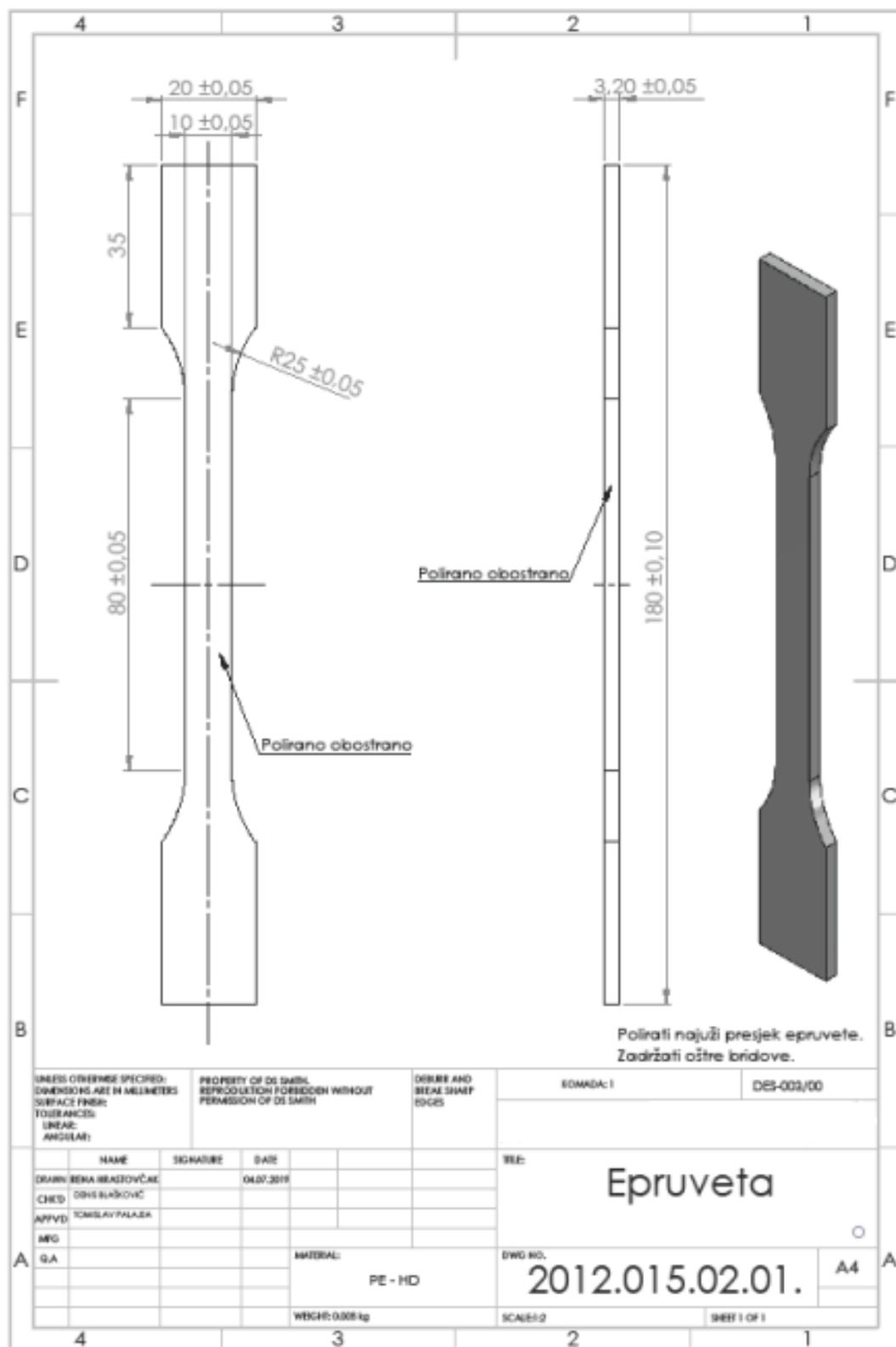
Slika 35. Standard za izradu epruveta ISO 527-2
