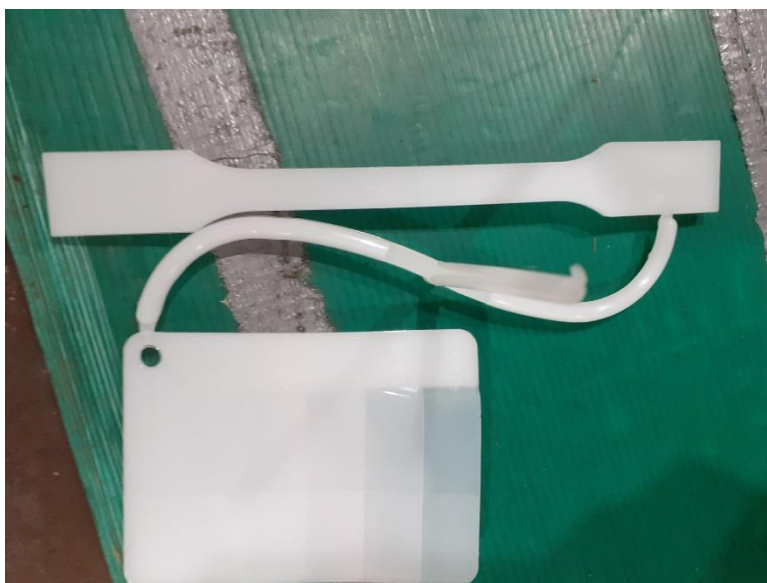
Slika 34. Epruveta – ispitni uzorak polipropilena
