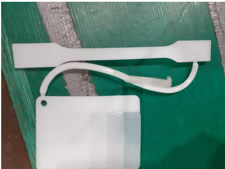
Slika 34. Epruveta – ispitni uzorak polipropilena
