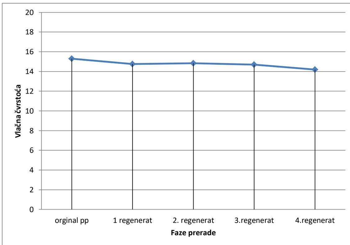
Slika 52. Grafički prikaz vlačne čvrstoće za polipipilen
