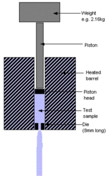
Slika 39. Uređaj za mjerenje indeksa tečenja      Slika 40. Shema mjerenja MFR [39]
