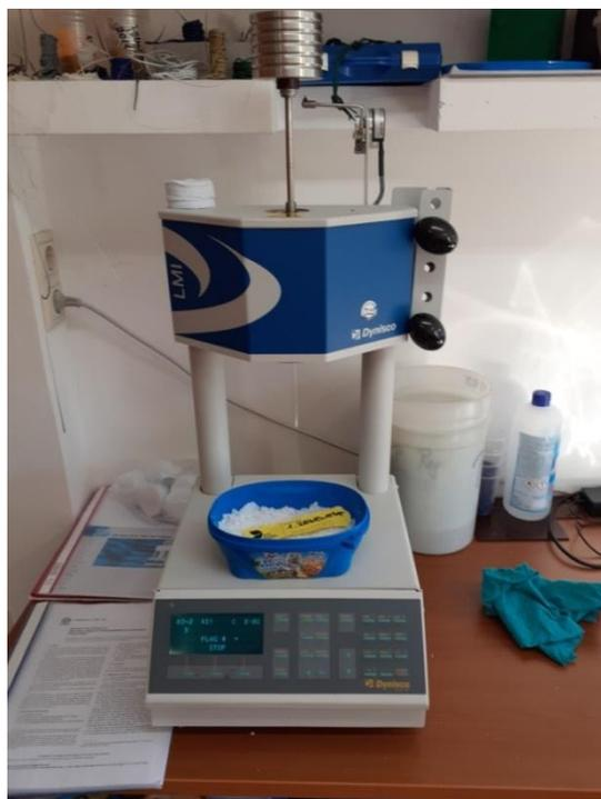
Slika 48. Uređaj za ispitivanje indeksa tečenja Dynisco LMI 4000
