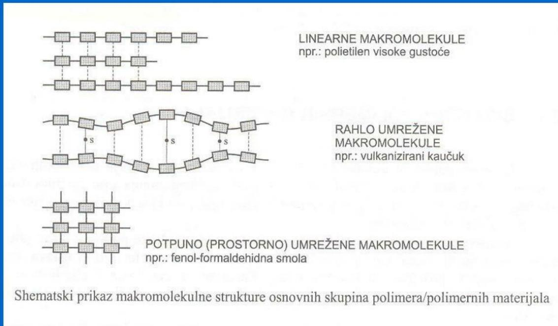
Slika 9. Shematski prikaz makromolekularne strukture osnovnih skupina polimernih materijala [15]
