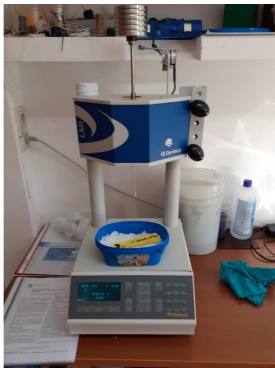
Slika 48. Uređaj za ispitivanje indeksa tečenja Dynisco LMI 4000
