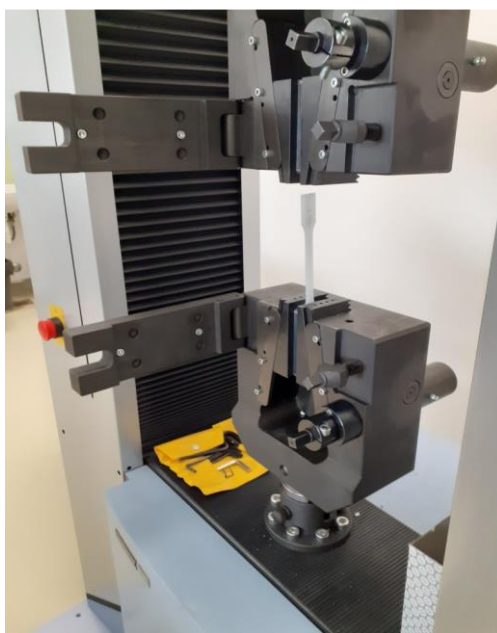
Slika 43. Postavljanje ispitnog uzorka u čeljusti kidalice
