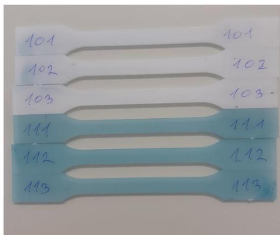
Slika 36. Označavanje ispitnih uzoraka - epruveta iste faze prerade
