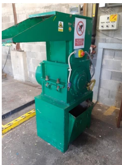
Slika 47. Mlin za usitnjavanje polimernih masa MG – 200
