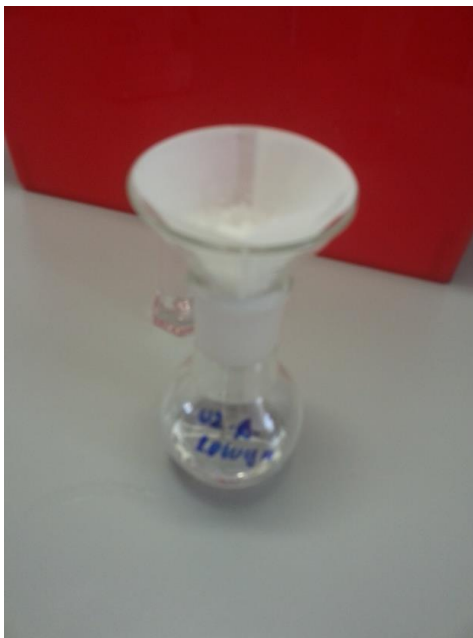
Slika 7: Filtracija uzorka s natrijevim sulfatom
