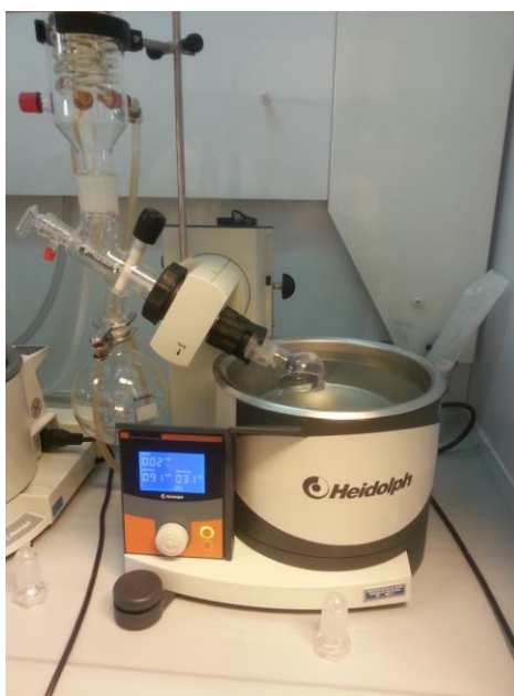
Slika 8: Uparavanje uzorka na Rotavapor-u
