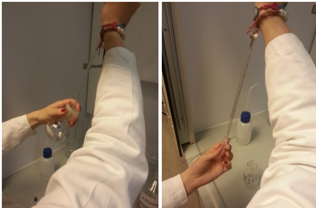
Slika 9: Pipetiranje uparenog uzorka, Slika 10: Ispuštanje uparenog uzorka u bočicu za analizu
