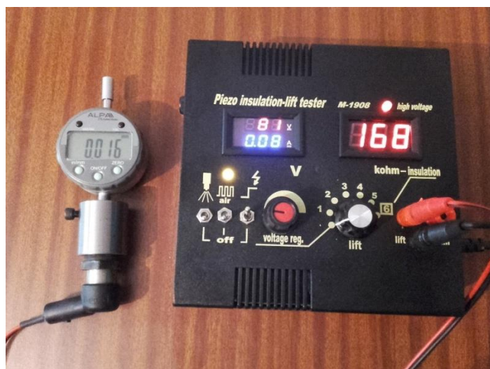
Slika 41 Mjerenje snage piezo magneta
