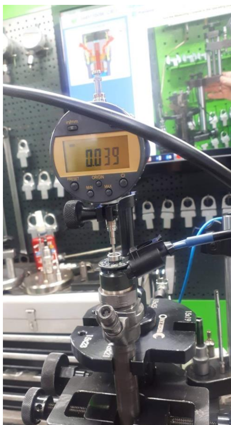
Slika 28 Ispitivanje hoda kugle ventila
