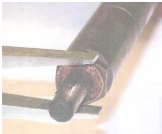
Slika 21 Demontaža bakrene podloške
