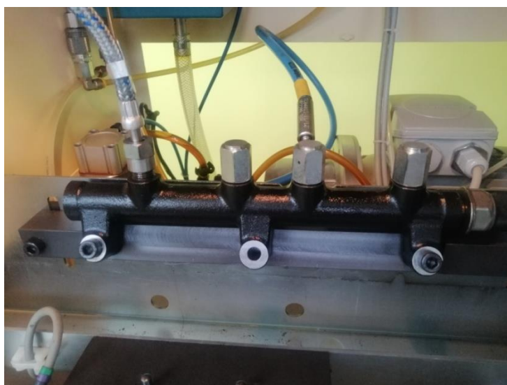
Slika 19 Zajednička cijev (Common rail)
