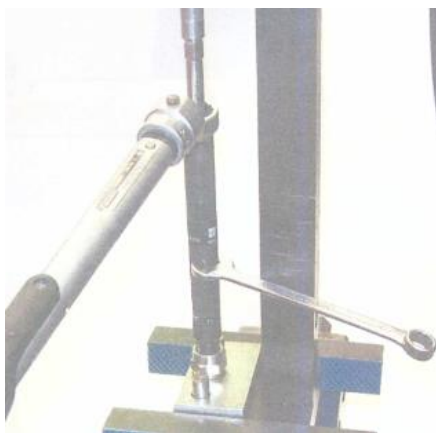
Slika 22 Demontaža držača sapnice
