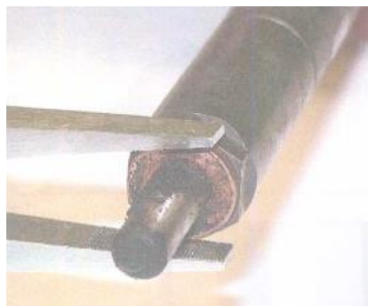
Slika 21 Demontaža bakrene podloške
