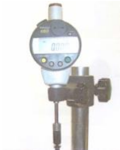
Slika 26 Mjerenje istrošenosti dosjeda ventila
