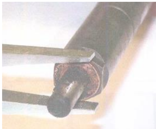
Slika 21 Demontaža bakrene podloške
