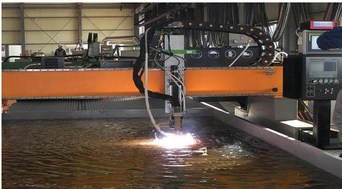
Slika 16. Postupak rezanja plazmenim mlazom pod vodom
