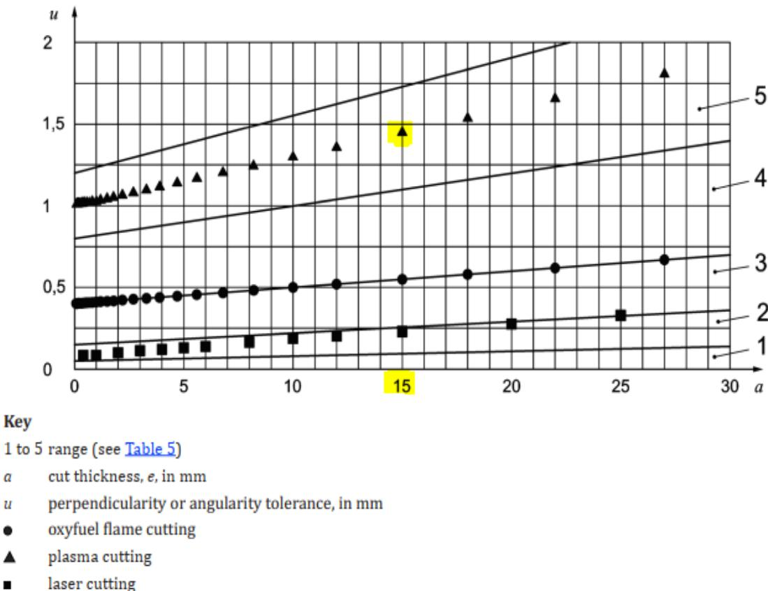
Slika 33. Tipične kvalitete reza koje se mogu postići tolerancijom okomitosti ili kutnosti - debljina radnog komada do 30 mm
