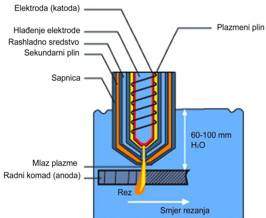
Slika 13. Plazma rezanje sa sekundarnim plinom u vodi
