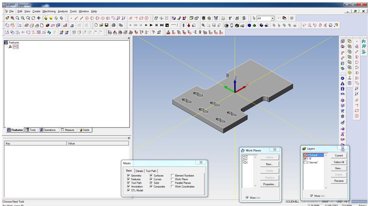
Slika 40. 3D model pozicioniran u Espritu za obradu
