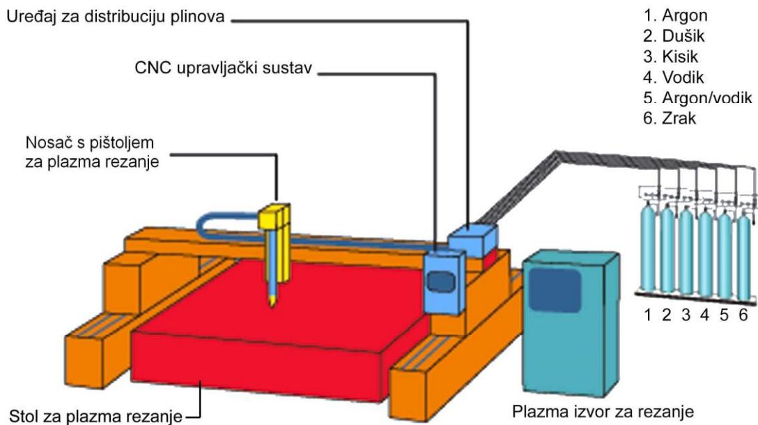
Slika 18. Sustav strojnog plazma rezanja
