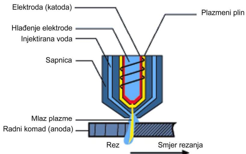
Slika 14. Plazma rezanje s injektiranim vodom
