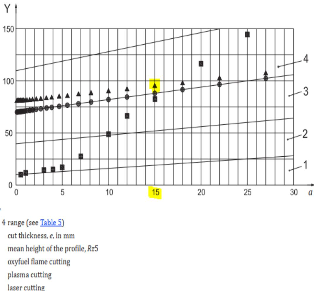
Slika 32. Tipične kvalitete rezanja koje se mogu postići sa srednjom visinom profila debljina radnog komada do 30 mm
