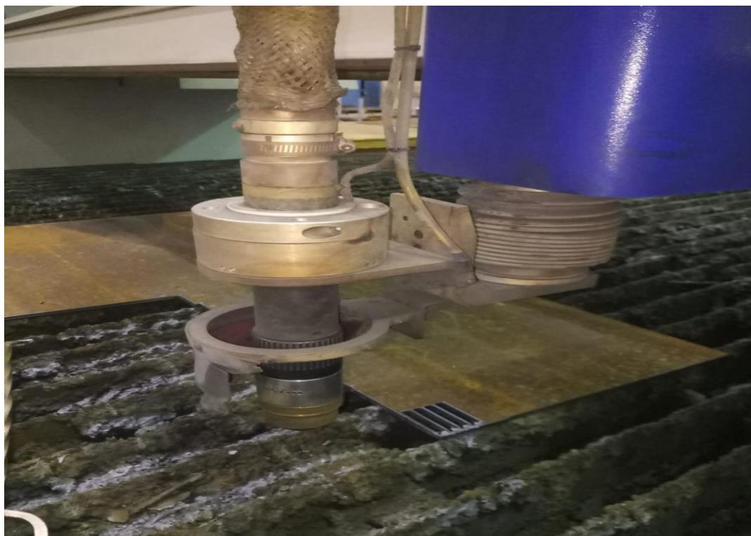
Slika 29. Stroj za CNC plinsko / plazma rezanje – gorionik
