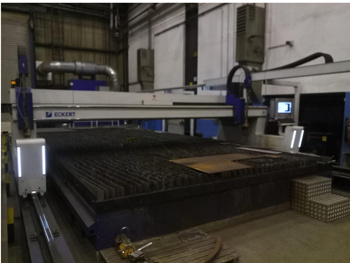
Slika 27. Stroj za CNC plinsko / plazma rezanje je marke ECKERT (Poljska)
