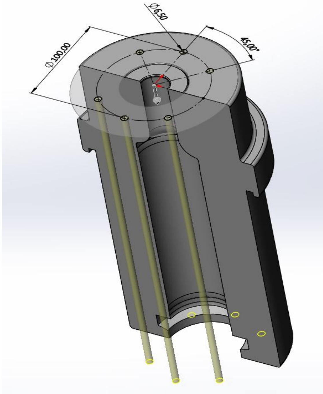
Slika 34. Bušenje ravnih vakuum rupa
