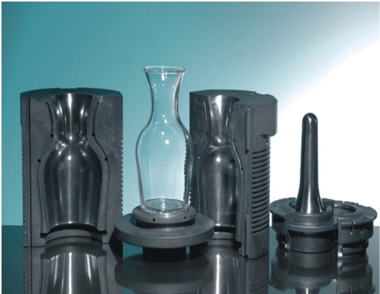
Slika 22. Prikaz alata sa gotovim proizvodom [3]
