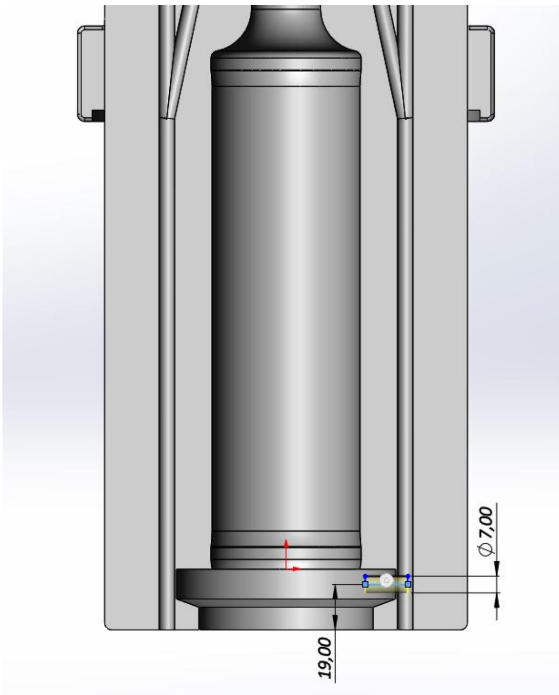
Slika 36. Spoj vakuum ravnih rupa i prizme kalupa
