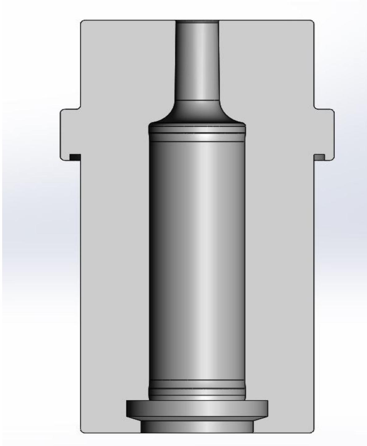
Slika 32. Oduzimanje kalupne šupljine od kalupa
