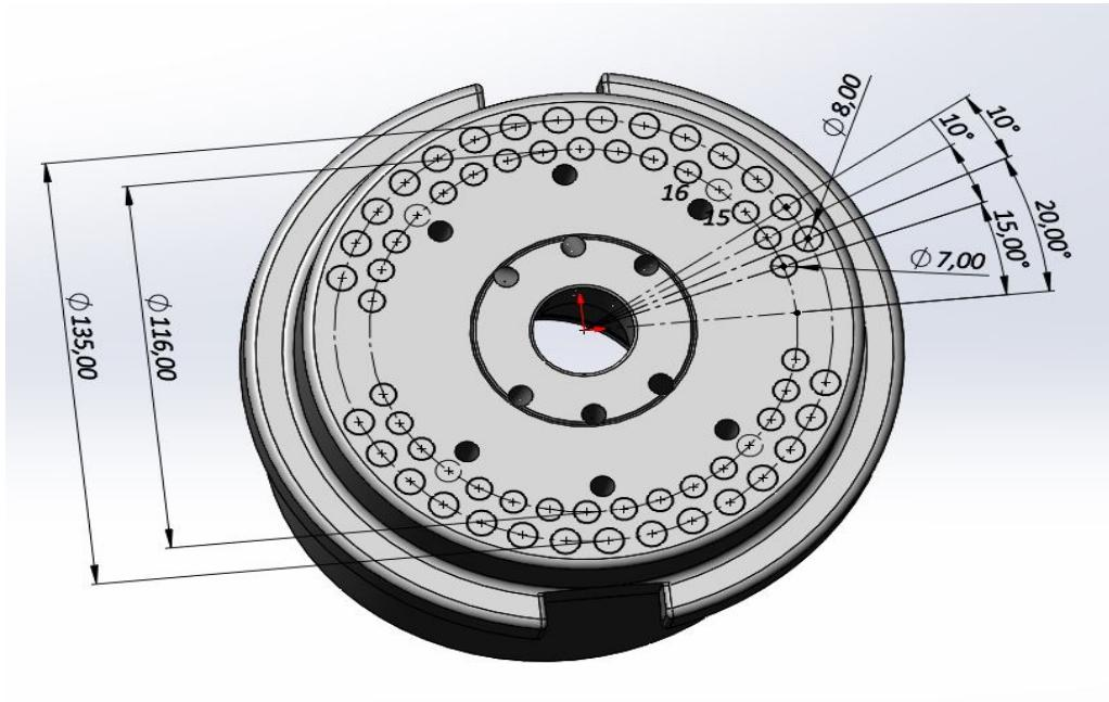
Slika 40. Bušenje VertiFlow rupa
