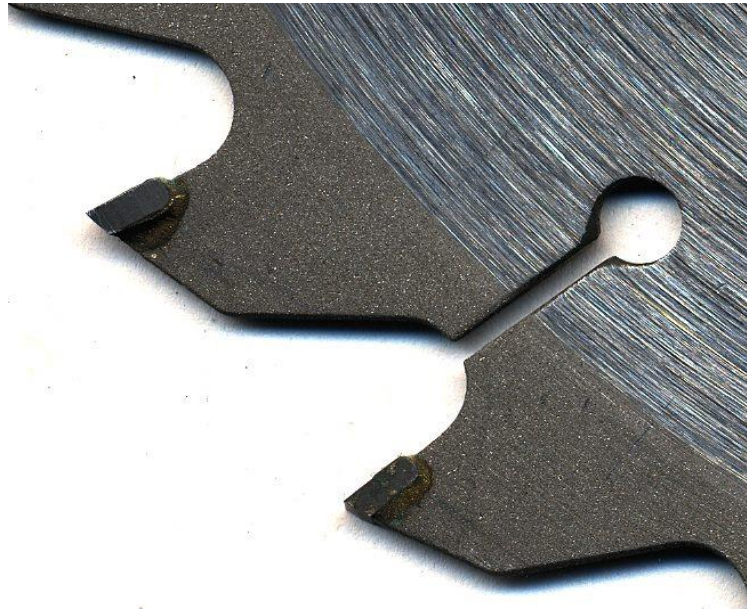
Slika 14. Volframov karbid se koristi za tvrde prevlake na alatima kružnih pila
