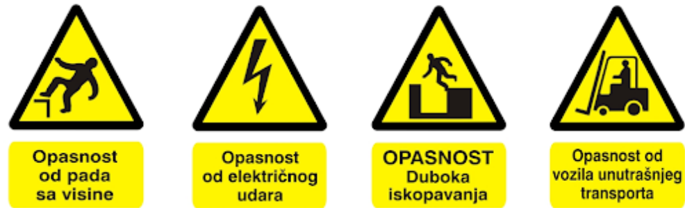
Slika 6.: Ploča rizika na gradilištu i preventivne mjere [6]
