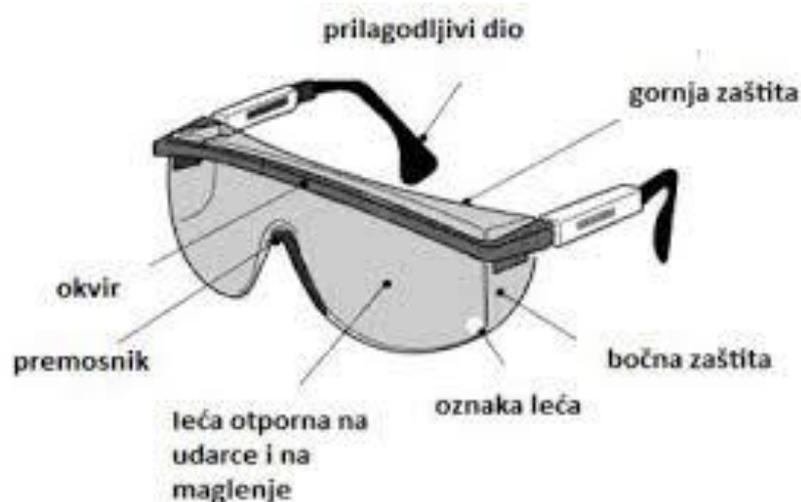
Slika 15. Dijelovi zaštitnih naočala [15]
