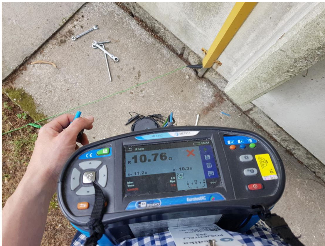
Slika 20. Predodžba ispitivanje otpora uzemljenja [14]
