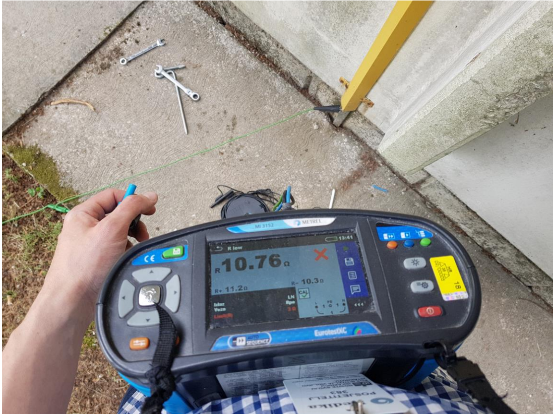
Slika 20. Predodžba ispitivanje otpora uzemljenja [14]
