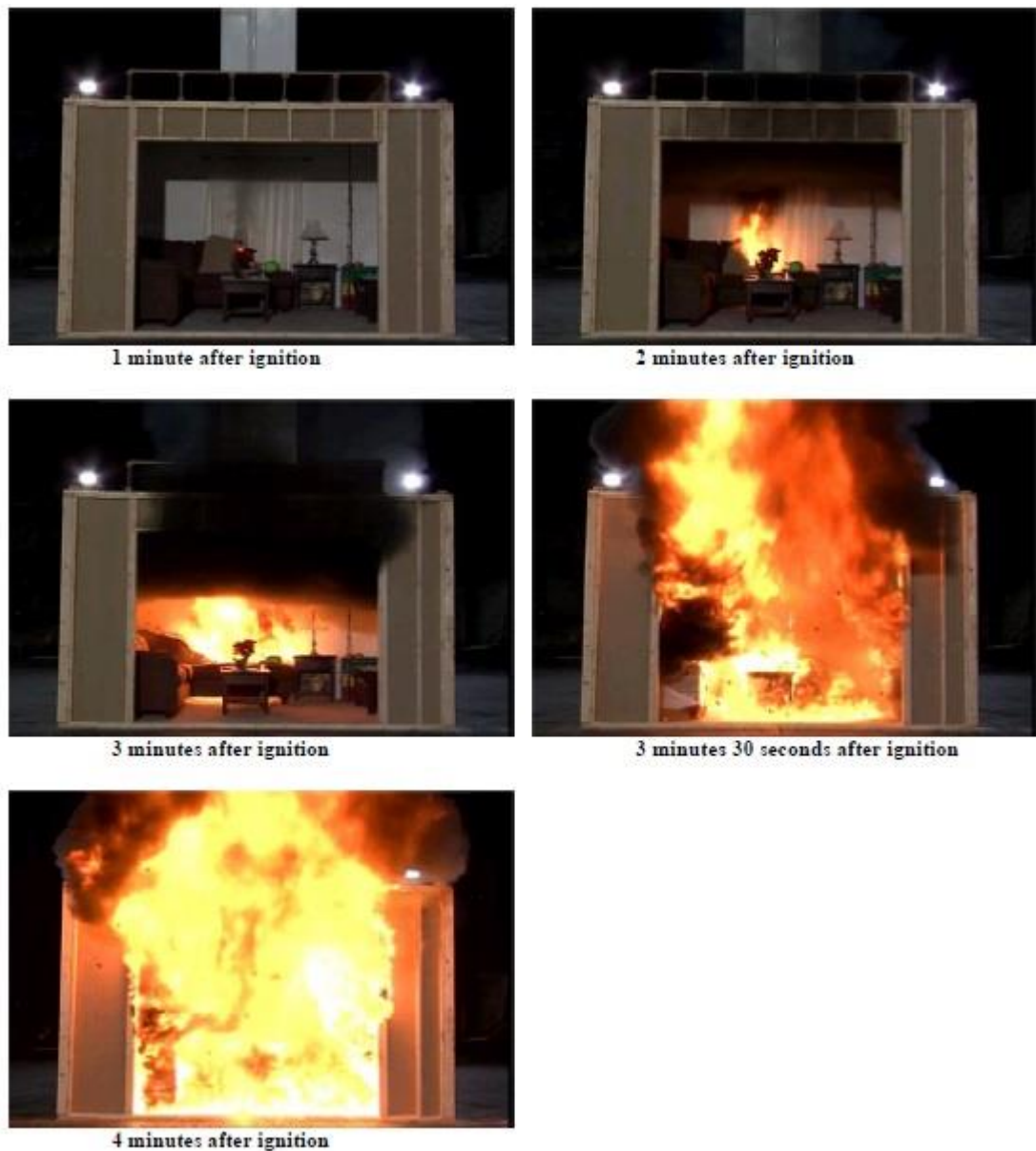
Slika 5. Razvoj požara u modernoj sobi.[19]
