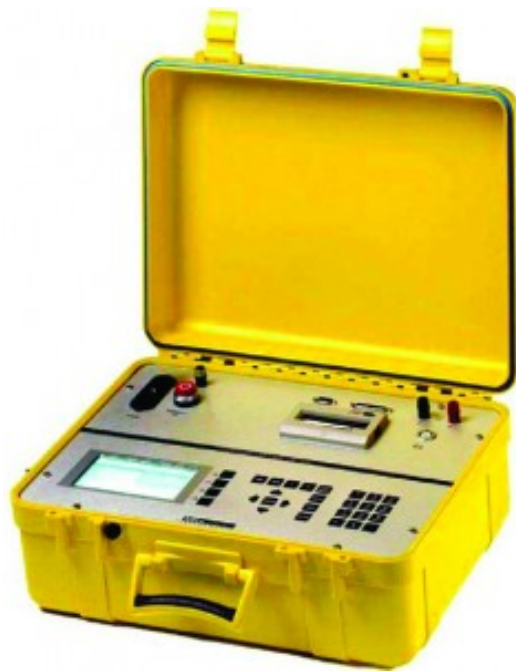
Slika 6. Uređaj za mjerenje napona RVM metodom [14]
