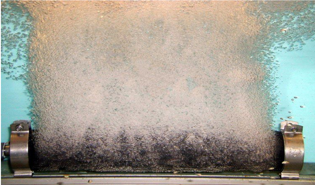
Slika 8. Postupak aeracije tj. otplinjavanja vode
