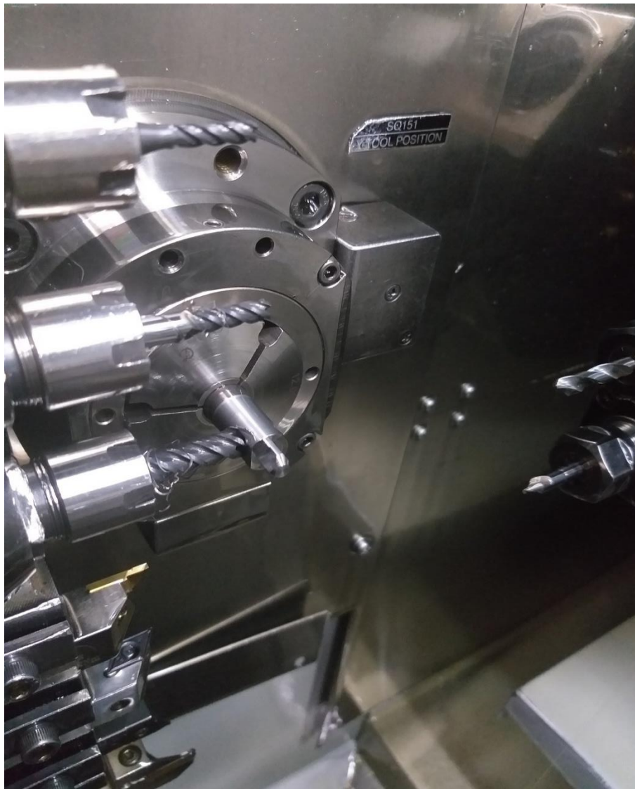
Slika 25 Glodanje tijela zatika naprave
