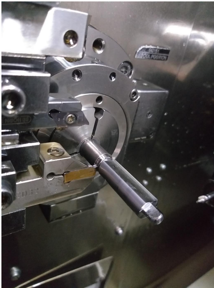
Slika 28 Operacija oslobodenja i natražno tokarenje
