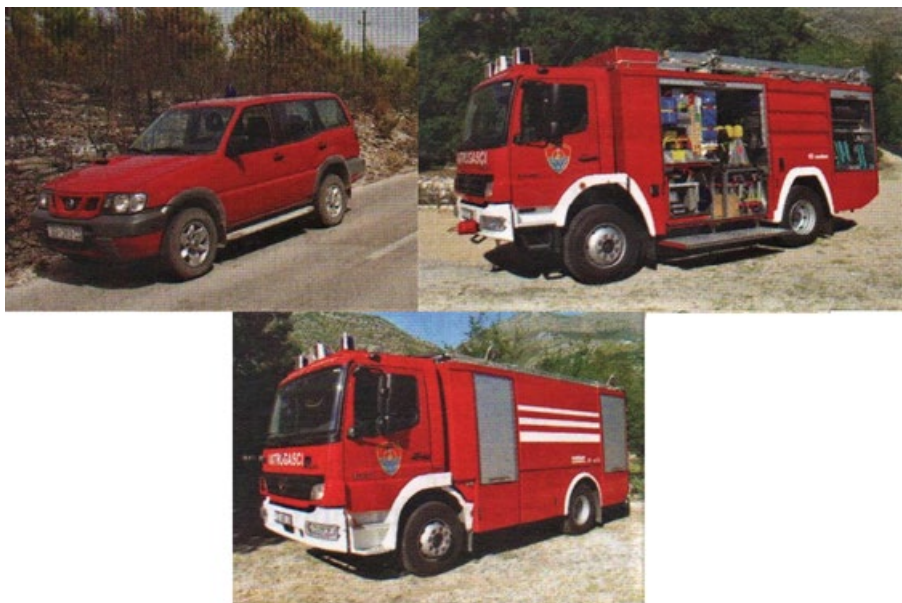
Sl. 36. Zapovjedno vozilo, Navalno vozilo i Autocisterna [10]
