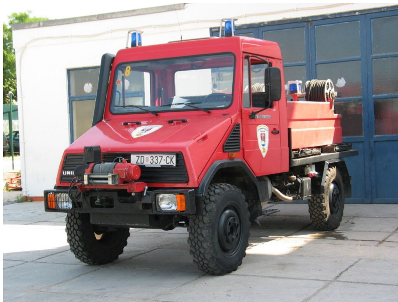
Sl. 34. Unimog U 100L za gašenje šumskih požara [23]
