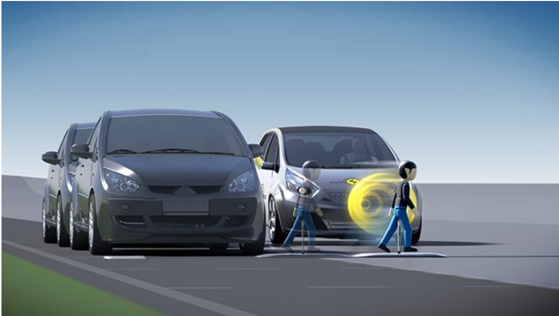
Slika 44. Ispitivanje izbjegavanja naleta vozila na djecu prilikom iznenadnog prelaska ceste iza parkiranog vozila, izvor: www.euroncap.com/en/vehicle-safety/the-ratings-explained/vulnerable-road-user-vru-protection/aeb-pedestrian/ [43]
