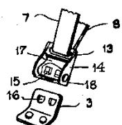
Slika 20. Patent Nilsa Ivara Bohlina koji je izmislio sigurnosni pojaz sa tri točke vezanja za Volvo AB, izvor: U. S. 3 043 625 [23]
