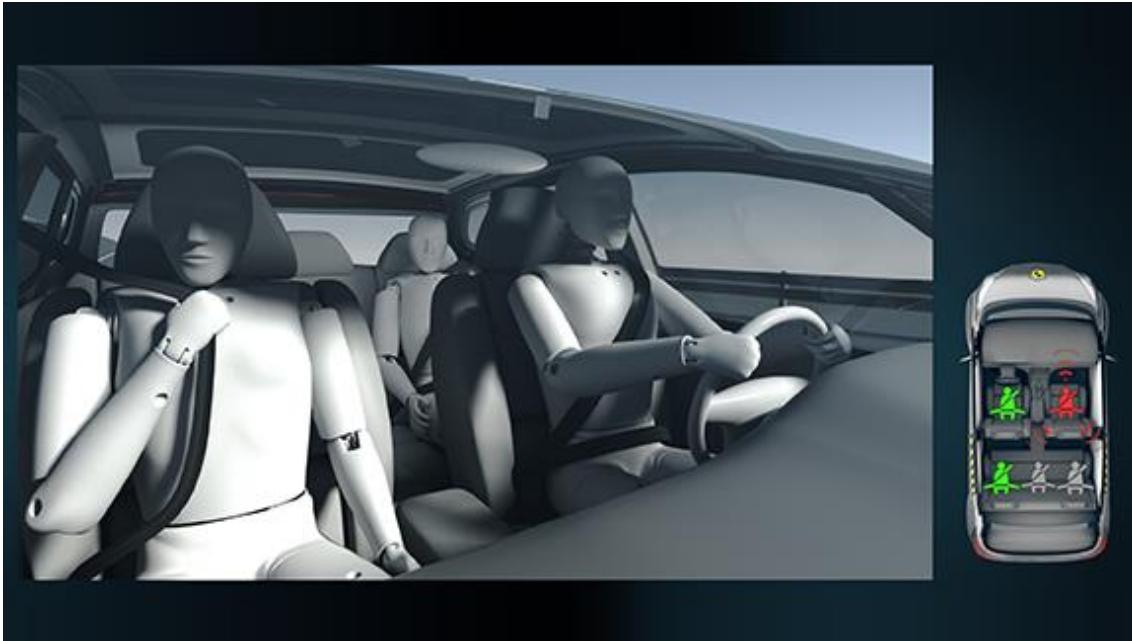
Slika 52. Predodžba SBR sustava, upozoravanje na vezanje sigurnosnim pojasom, izvor: euroncap
