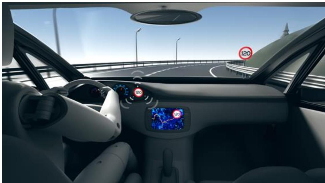
Slika 53. Predodžba korištenja SAS tehnologije automatskog postavljanja brzine preko očitanja znaka sa ceste ili kartografskih digitalnih podataka, izvor: [www.euroncap.com/en/vehicle-safety/the-ratings-explained/safety-assist/speed-assistance/](http://www.euroncap.com/en/vehicle-safety/the-ratings-explained/safety-assist/speed-assistance/) [47]
