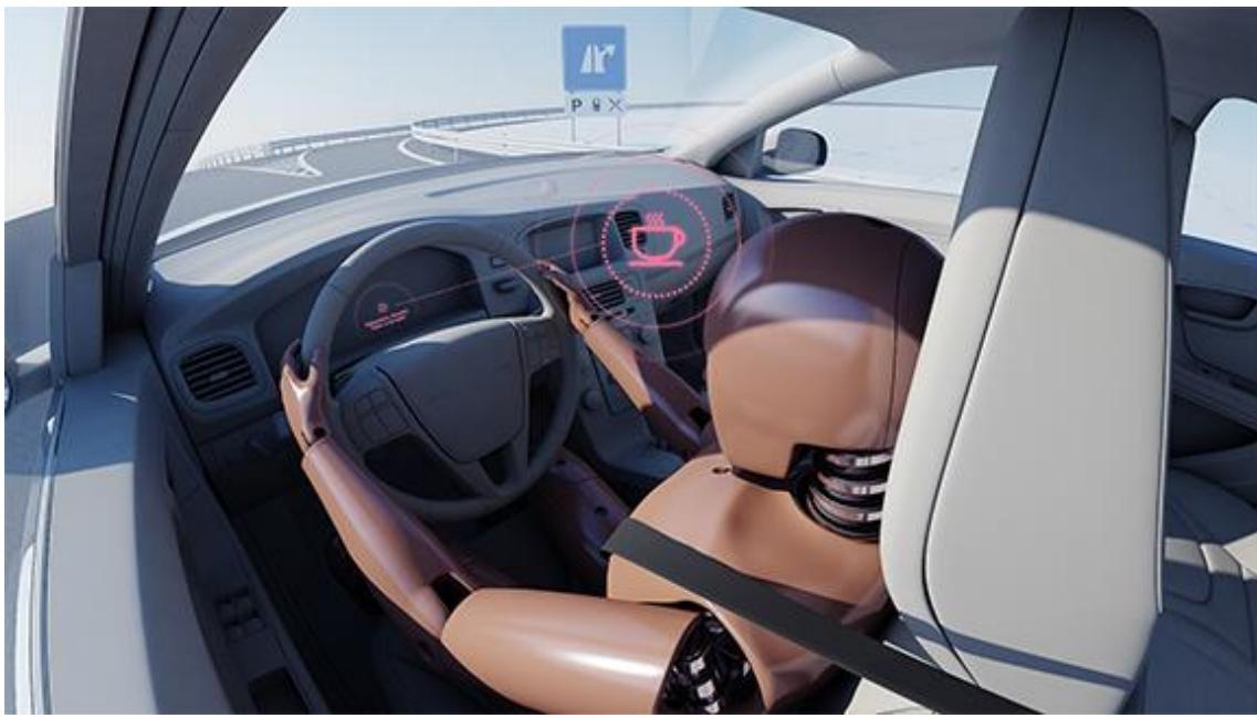
Slika 51. Predodžba sustav praćenja stanja vozača koji prepoznae umor vozača npr. nakon duge vožnje, te mu predlaže odlazak na odmorište, izvor: euroncap
