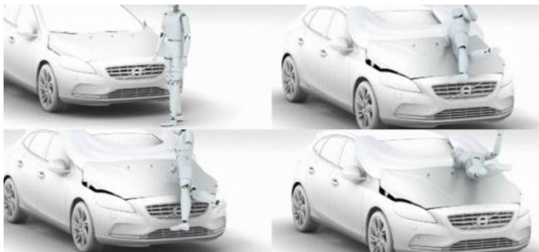
Slika 37. Predodžba rada vanjskog zračnog jastuka na Volvu V40, prvom automobilu koji je njime opremljen, izvor: [volvocars.com](http://volvocars.com) (2013.) [40]
