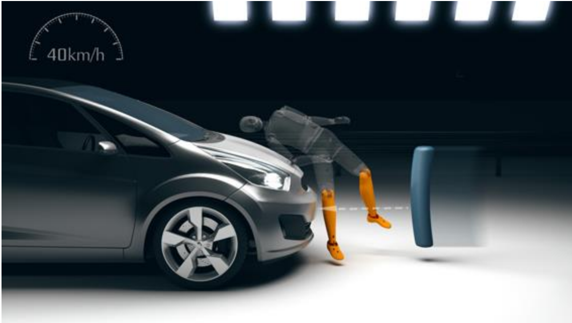
Slika 39. Simulacija naleta vozila na donji dio nogu pješaka, izvor: www.euroncap.com/en/vehicle-safety/the-ratings-explained/vulnerable-road-user-vru-protection/lower-leg-impact/ [42]
