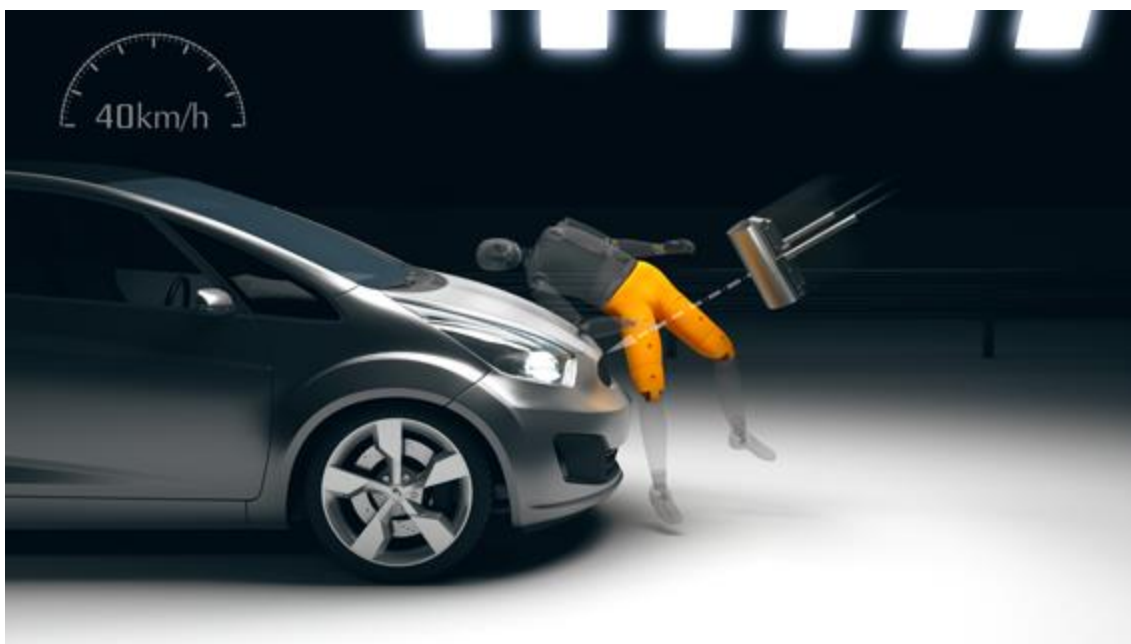
Slika 38. Predodžba Simulacije naleta vozila na gornji dio nogu pješaka, izvor: www.euroncap.com/en/vehicle-safety/the-ratings-explained/vulnerable-road-user-vru-protection/upper-leg-impact/ [41]
