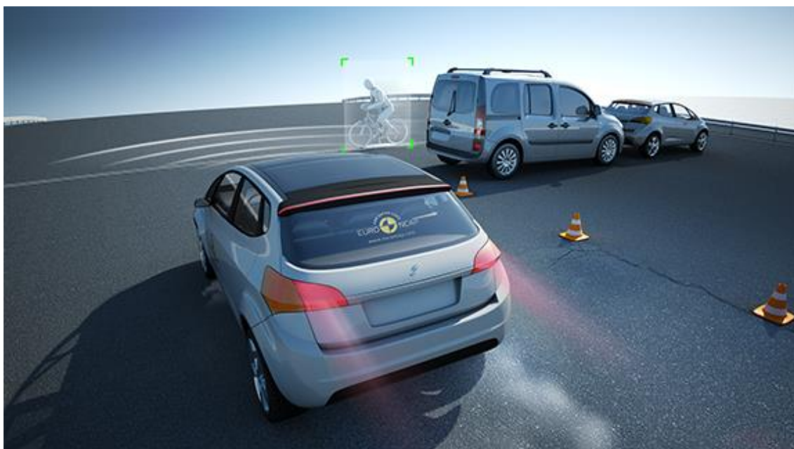
Slika 45. Predložba ispitivanje izbjegavanja naleta vozila na biciklista zaklonjenog parkiranim vozilima, izvor: www.euroncap.com/en/vehicle-safety/the-ratings-explained/vulnerable-road-user-vru-protection/aeb-cyclist/ [44]
