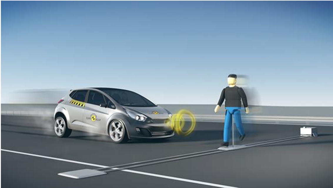
Slika 42. Ispitivanja izbjegavanja naleta vozila prilikom prelaska pješaka preko ceste, izvor: www.euroncap.com/en/vehicle-safety/the-ratings-explained/vulnerable-road-user-vru-protection/aeb-pedestrian/ [43]
