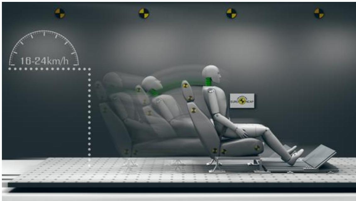
Slika 28. Predodžba testiranja trzajne ozljede vrata, izvor:
