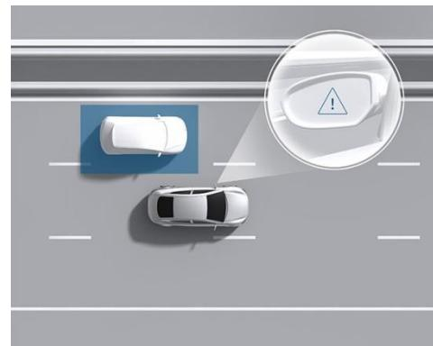
Slika 57. Način rada Boschovog BSM sustava, izvor: Bosch [50]
