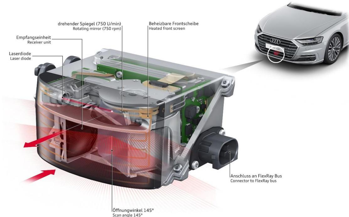
Slika 5. Predodžba laserskog senzora na Audiju A8, izvor:
