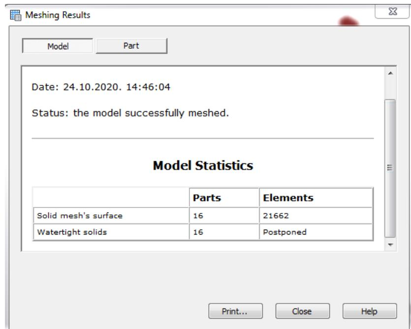
**Slika 35. Rezultat podjele nosača na konačne elemente**
