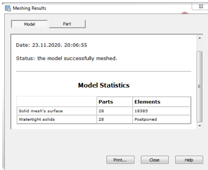
**Slika 51. Rezultat podjele nosača na konačne elemente**
