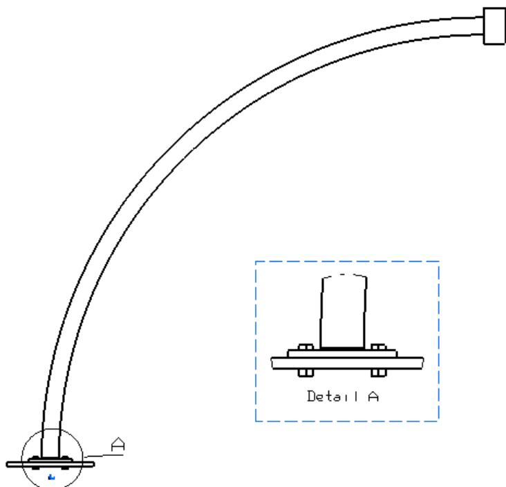
Slika 6. Skica nosača sa uvećanim detaljem uklještenja
