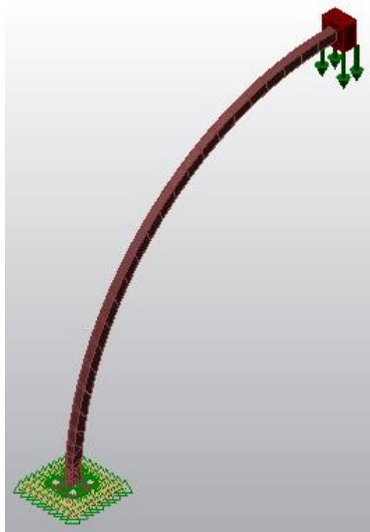
Slika 26. Nosač ukliješten te opterećen silom tereta
