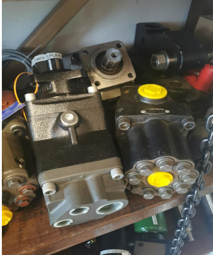
Slika 3. Klipno aksijalna pumpa
