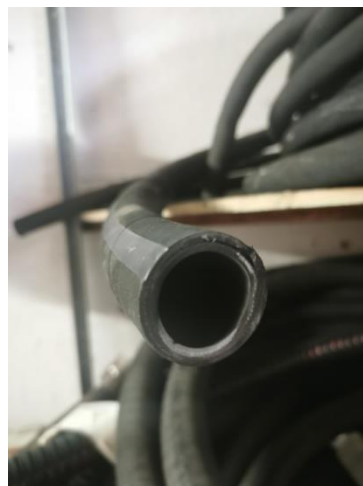
Slika 25. Fleksibilni hidraulični cjevovod jednostruko armiran čeličnom mrežicom
