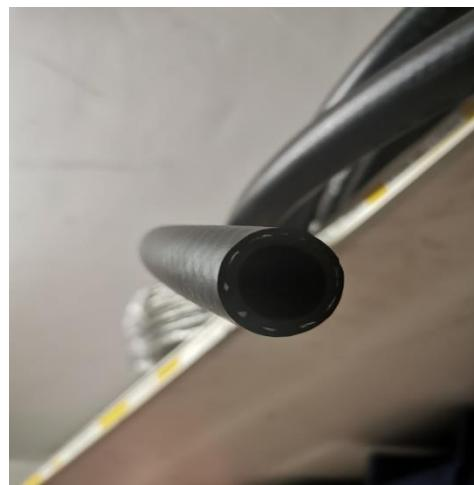
*Slika 24. Fleksibilni hidraulični cjevovod armiran tekstilnom mrežicom*
