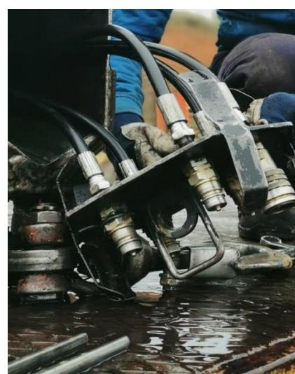
Slika 65. Fleksibilni hidraulični vodovi i brze spojke
