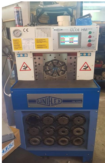
Slika 68. Hidraulična preša za izradu hidrauličnih fleksibilnih cjevovoda
