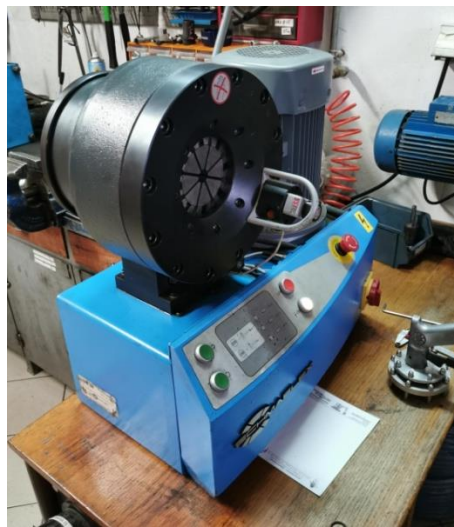
Slika 29. Hidraulična preša za izradu fleksibilnih cjevovoda
