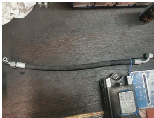
Slika 23. Primjer savitljivog hidrauličnog cjevovoda
