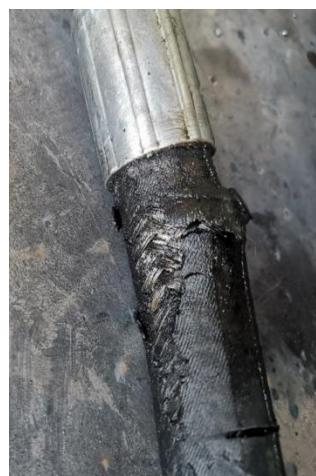
Slika 64. Oštećenja hidrauličnog fleksibilnog voda
