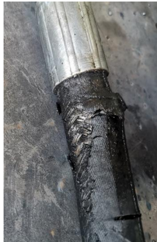
Slika 64. Oštećenja hidrauličnog fleksibilnog voda
