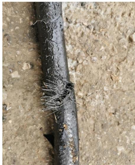
Slika 62. Pucanje fleksibilnog hidrauličnog voda
