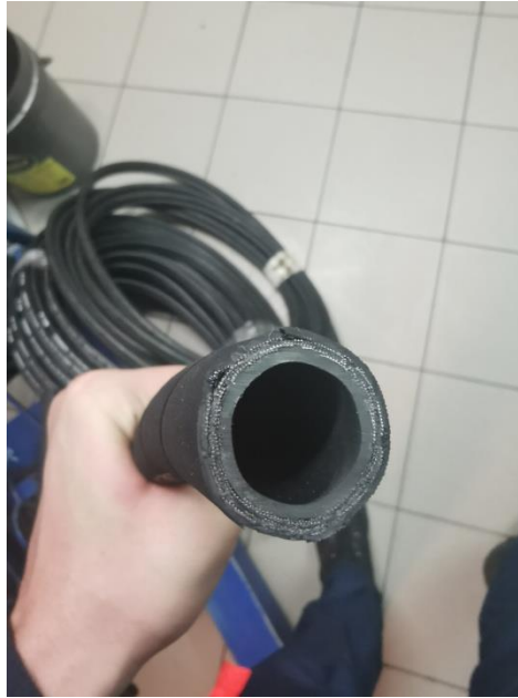
Slika 26. Dvostruko armiran čeličnom mrežicom fleksibilni cjevovod
