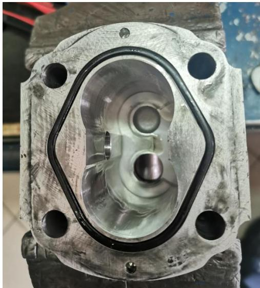
*Slika 55. Unutrašnjost zupčaste pumpe*
