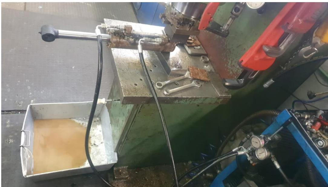
Slika 72. Proces ispitivanja nepropusnosti
