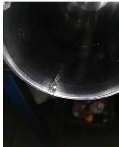
*Slika 43. Udubljenje cijevi cilindra*
