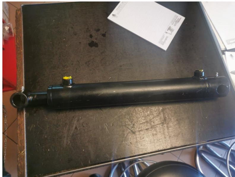
Slika 9. Dvoradni cilindar s provrtima na oba kraja
