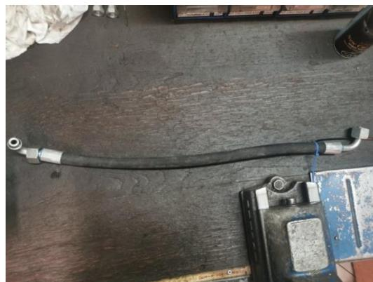
*Slika 23. Primjer savitljivog hidrauličnog cjevovoda*
