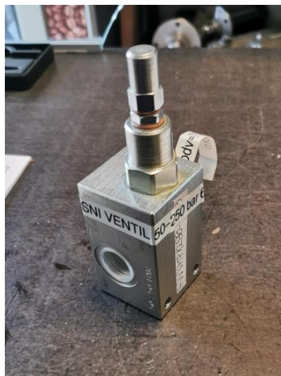
Slika 13. Ventil za ograničavanje tlaka "sigurnosni ventil"
