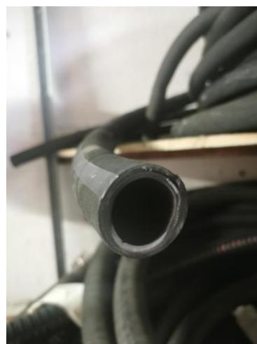
*Slika 25. Fleksibilni hidraulični cjevovod jednostruko armiran čeličnom mrežicom*
