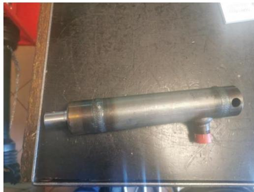
Slika 6. Jednoradni cilindar s oprugom
