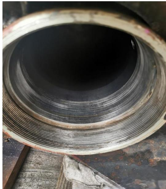
*Slika 41. Oštećenja riseva po cijevi cilindra*
