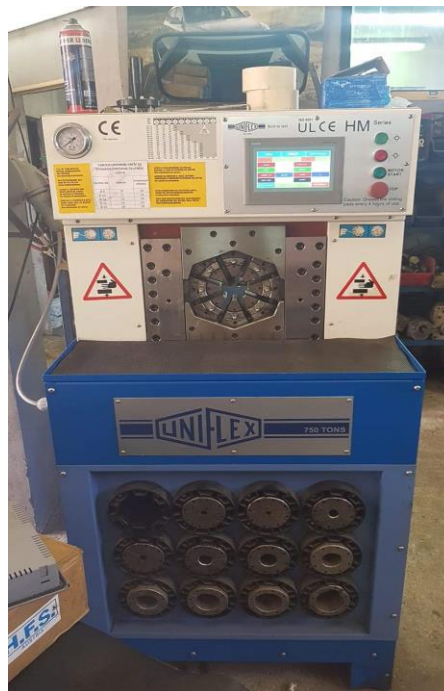
Slika 68. Hidraulična preša za izradu hidrauličnih fleksibilnih cjevovoda
