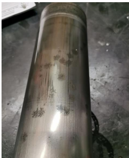
Slika 48. Klipnjača prije poliranja
