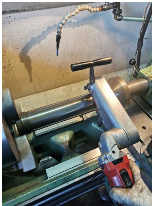
Slika 47. Proces poliranja klipnjače
