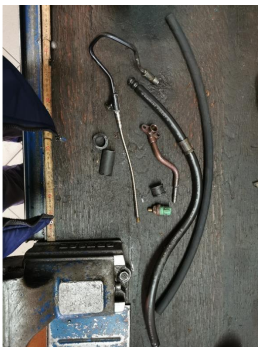
Slika 66. Promjena fleksibilnog hidrauličnog voda na servo crijevu
