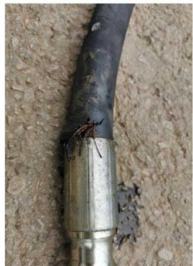
Slika 63. Oštećenje voda
