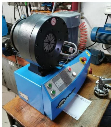
Slika 29. Hidraulična preša za izradu fleksibilnih cjevovoda
