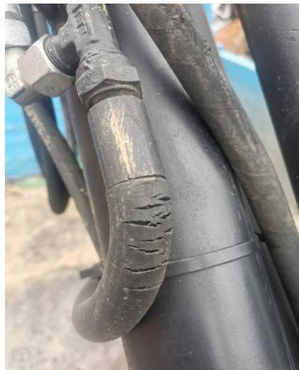
Slika 61. Nepravilno izveden hidraulički vod
