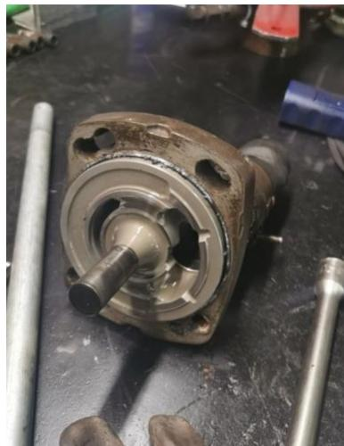
Slika 58. Prikaz oštećenja osovine pumpe
