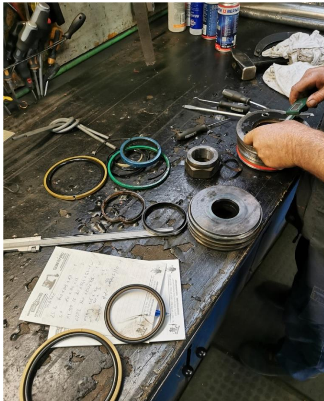
Slika 34. Promjena brtvi cilindra
