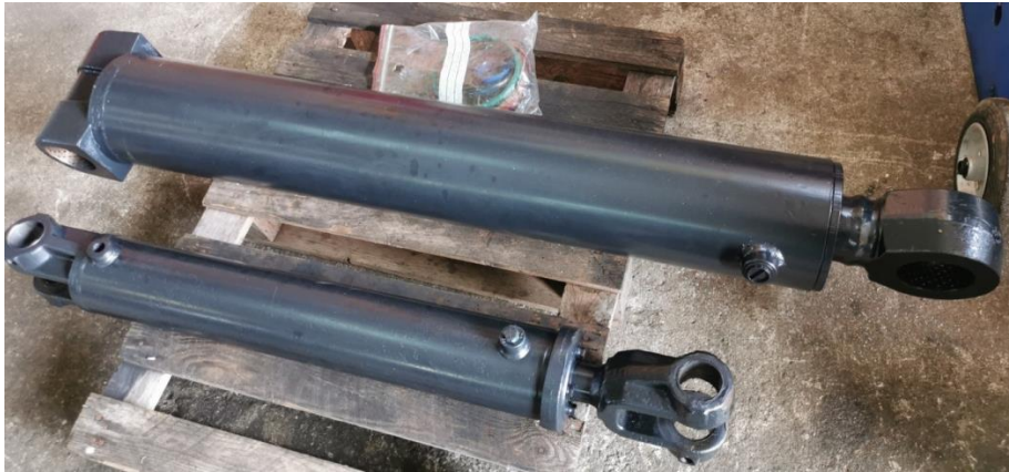
Slika 50. Završen postupak reparacije hidrauličnih cilindara
