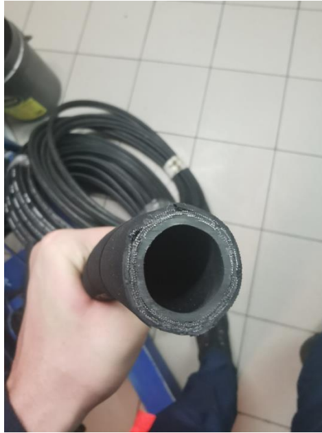
Slika 26. Dvostruko armiran čeličnom mrežicom fleksibilni cjevovod
