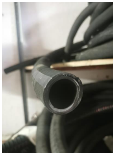
Slika 25. Fleksibilni hidraulični cjevovod jednostruko armiran čeličnom mrežicom
