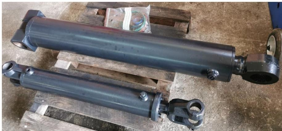
*Slika 50. Završen postupak reparacije hidrauličnih cilindara*
