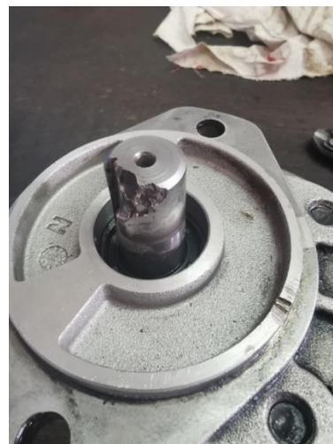
*Slika 52. Oštećenje osovine pumpe*
