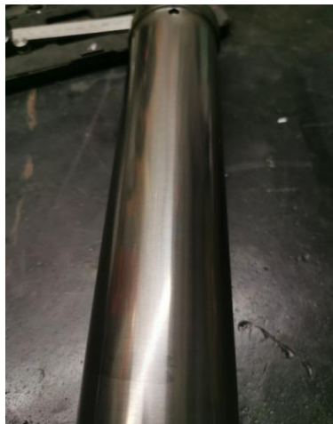
Slika 49. Klipnjača poslije poliranja
