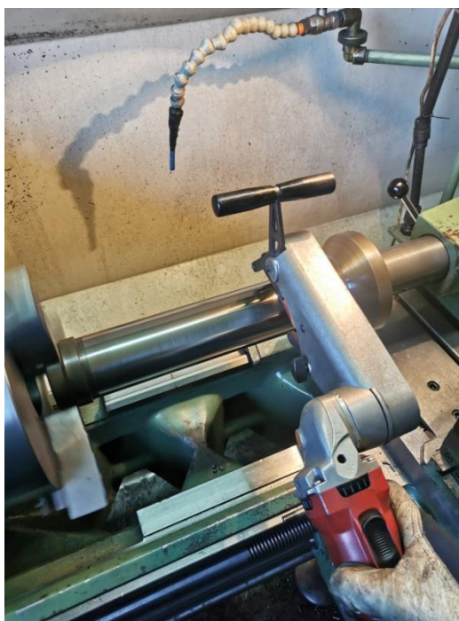
Slika 47. Proces poliranja klipnjače
