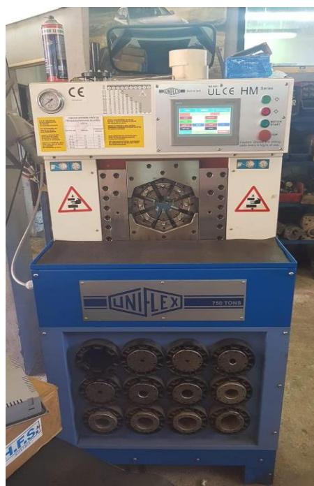
Slika 68. Hidraulična preša za izradu hidrauličnih fleksibilnih cjevovoda
