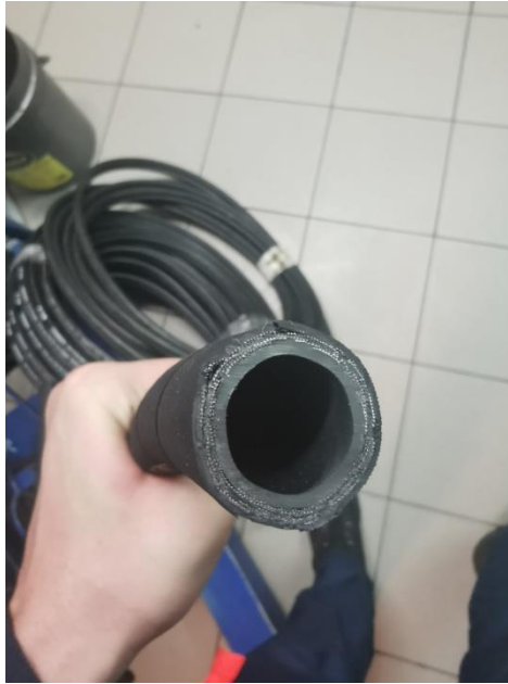
Slika 26. Dvostruko armiran čeličnom mrežicom fleksibilni cjevovod
