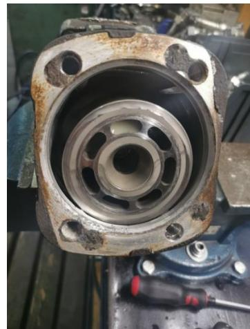
Slika 59. Oštećenje pumpe
