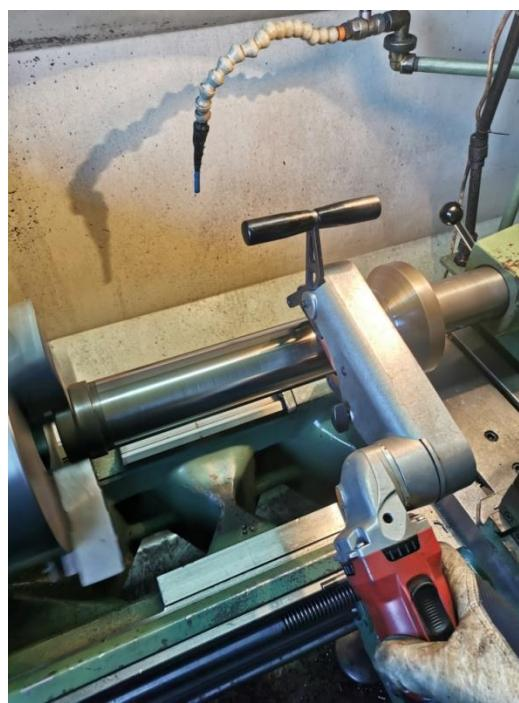
*Slika 47. Proces poliranja klipnjače*
