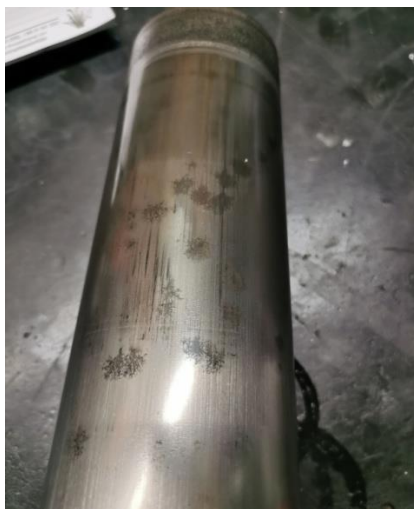
Slika 48. Klipnjača prije poliranja
