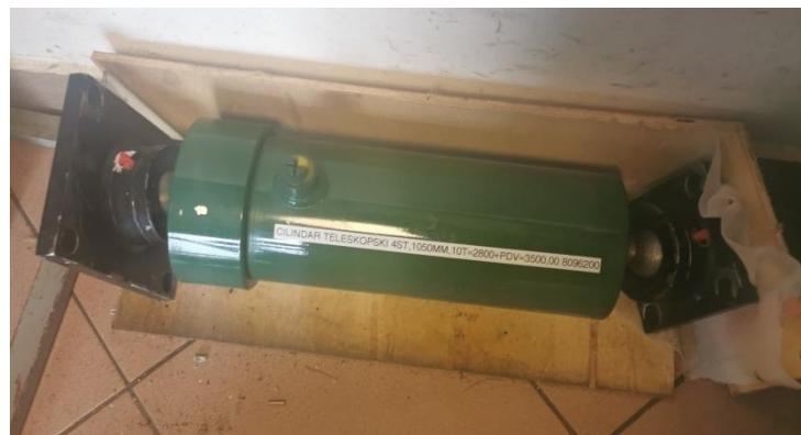
Slika 7. Teleskopski cilindar
