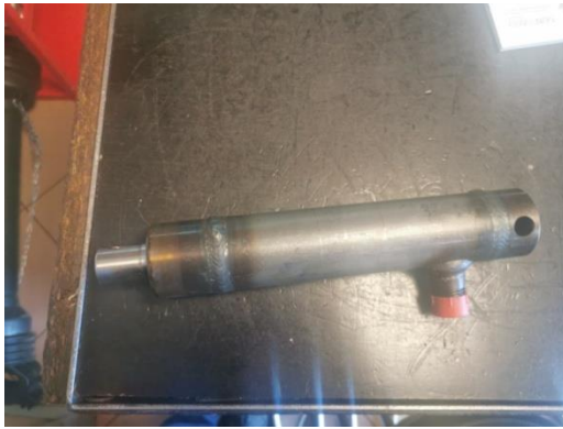
Slika 6. Jednoradni cilindar s oprugom
