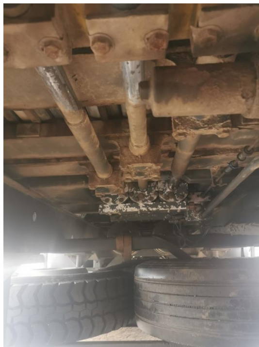
Slika 45. Cilindri prikolice s pomičnim podom
