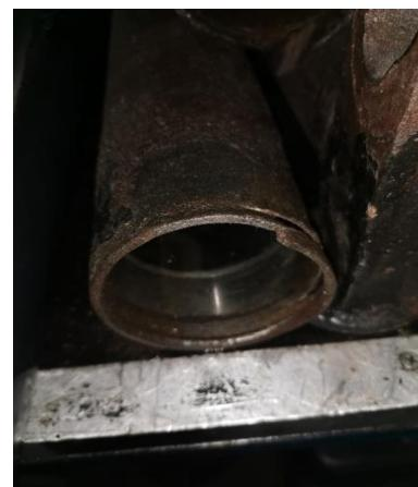
*Slika 44. Korozija cilindra*
