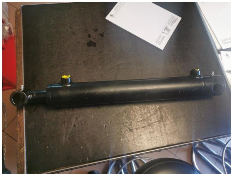
Slika 9. Dvoradni cilindar s provrtima na oba kraja
