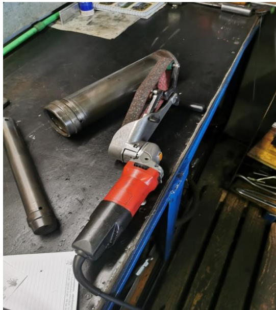
Slika 46. Uređaj za poliranje klipnjače
