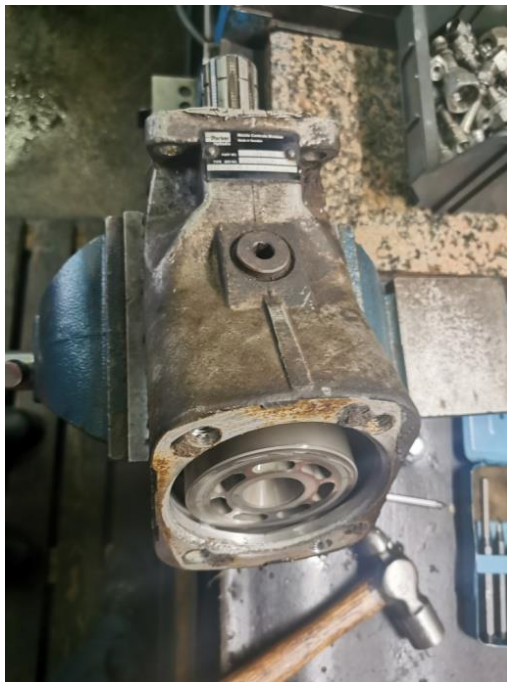
Slika 57. Aksijalno klipna pumpa
