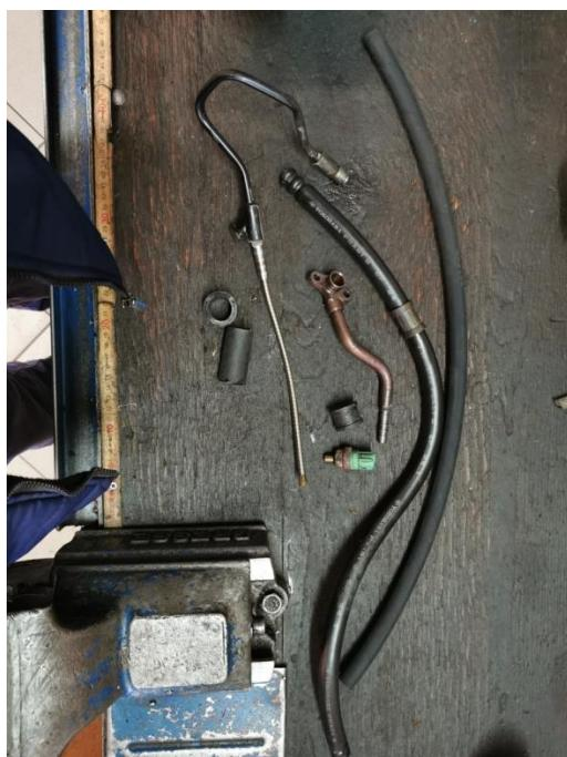
*Slika 66. Promjena fleksibilnog hidrauličnog voda na servo crijevu*
