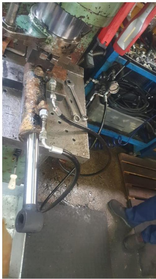
Slika 73. Proces ispitivanja nepropusnosti [2]
