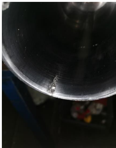
Slika 43. Udubljenje cijevi cilindra
