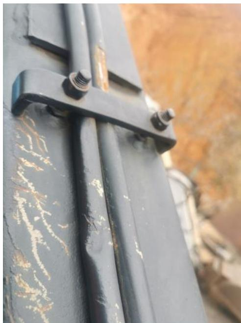
*Slika 70. Kruti hidraulični vod*
