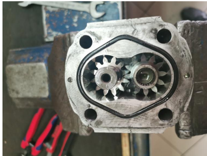
Slika 53. Zupčanici zupčaste pumpe
