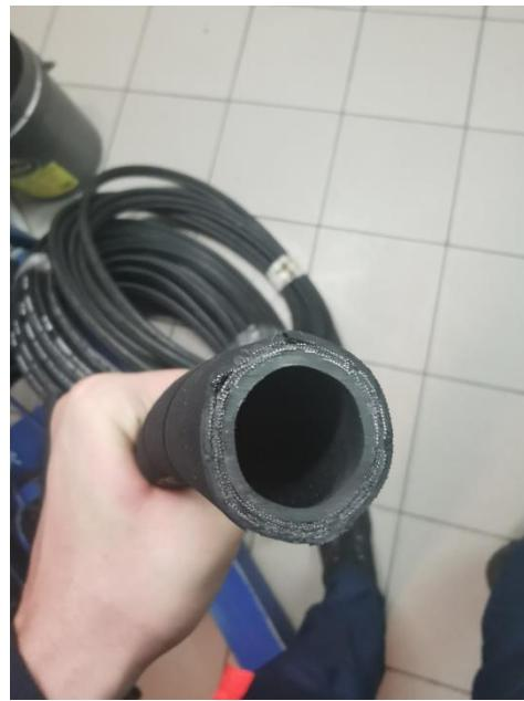
Slika 26. Dvostruko armiran čeličnom mrežicom fleksibilni cjevovod
