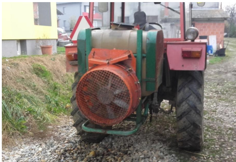
Slika 4 Traktor sa priključnim mehanizmom raspršivanje
