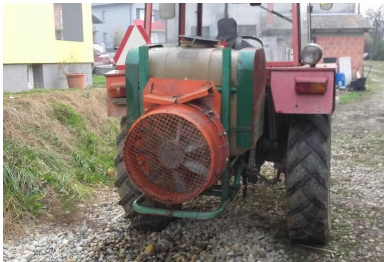
**Slika 4 Traktor sa priključnim mehanizmom raspršivanje**
