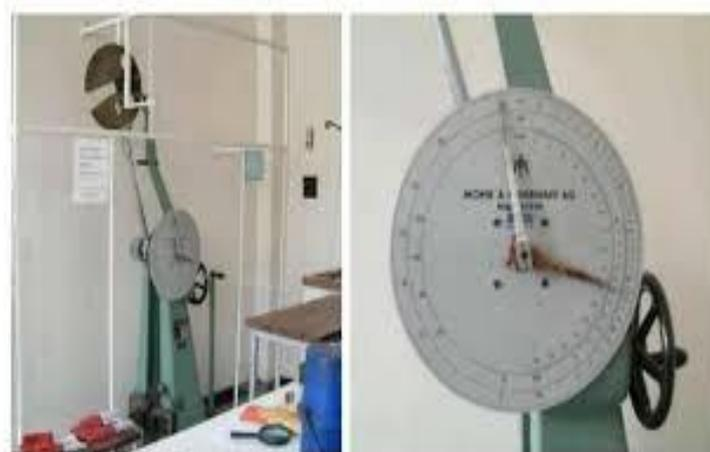
Slika 18. Charpyjev bat s mjernom skalom
