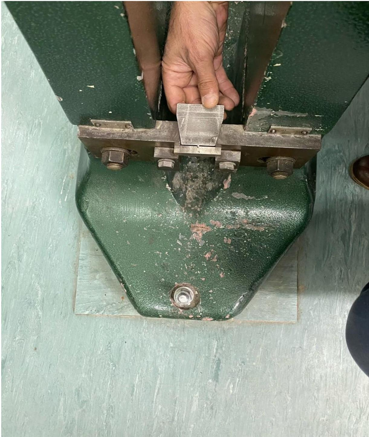
Slika 27. Etalon i postavljeni ispitni uzorak na Charpy batu
