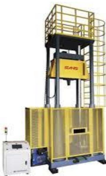
Slika 10. Suvremena izvedba Pellinija za srednje iznose energija ( raspon energije od 6500 J do 30000 J )
