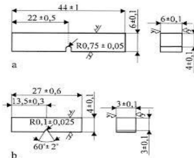
Slika 22. Posebne epruvete za ispitivanje udarnog rada loma
