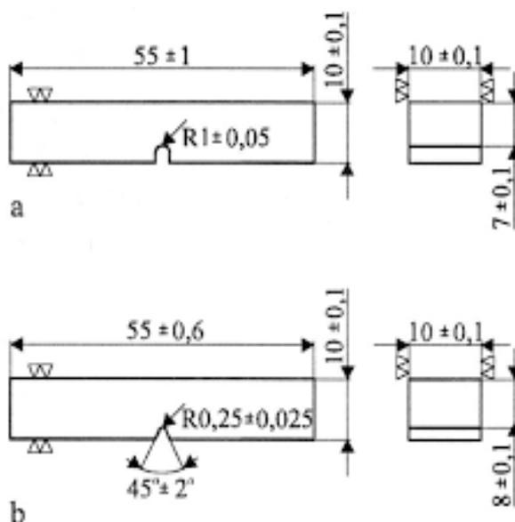
Slika 21. Ispitni uzorci za ispitivanje udarnog rada loma:
