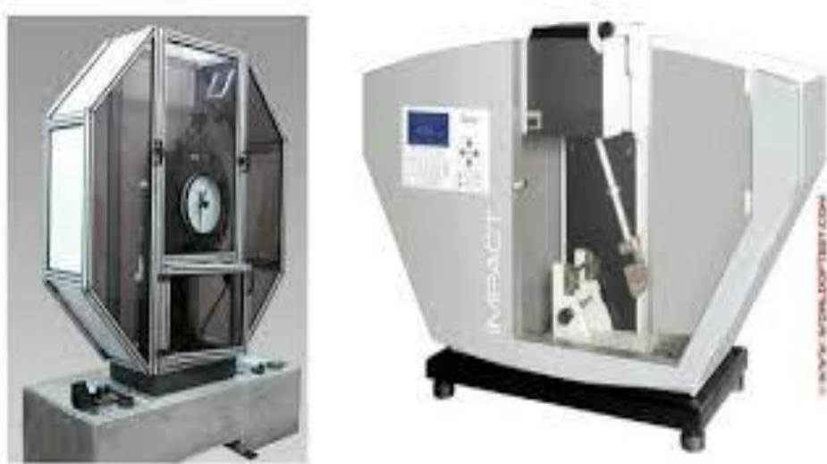
Slika 20. Suvremena izvedba Charpyjevog bata za velike iznose energija
