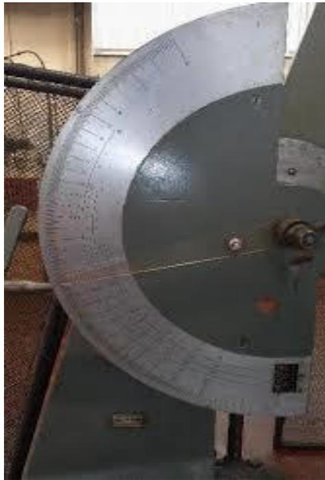
Slika 17. Mjerna skala Charpyjevog bata
