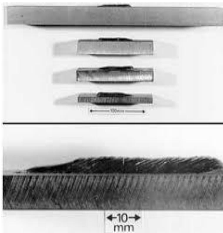
Slika 8. Ispitni uzorci za ispitivanje udarnog rada loma po Pelliniju
