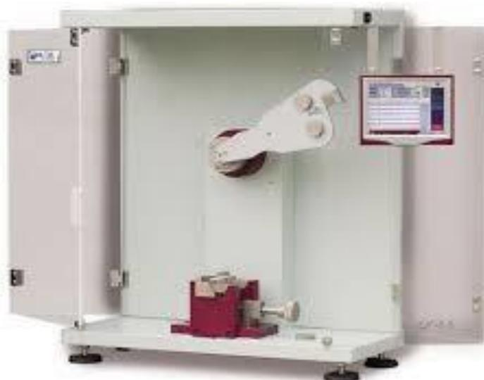
Slika 12. Višefunkcionalni uređaj za ispitivanje po Bruggeru i Charpyju
