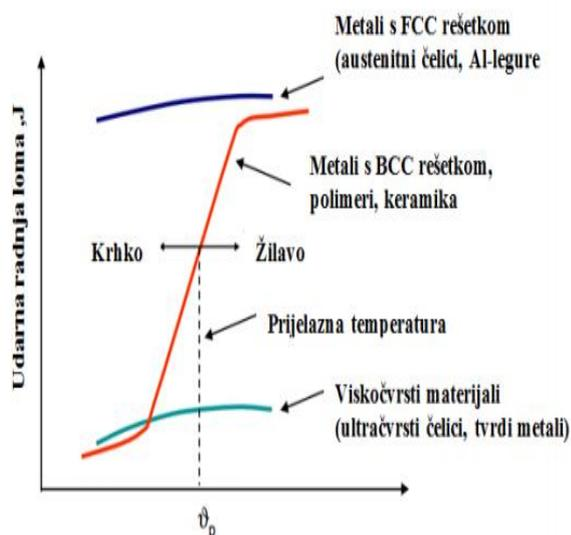
Slika 5. Dijagramski prikaz ovisnosti udarnog rada loma o temperaturi
