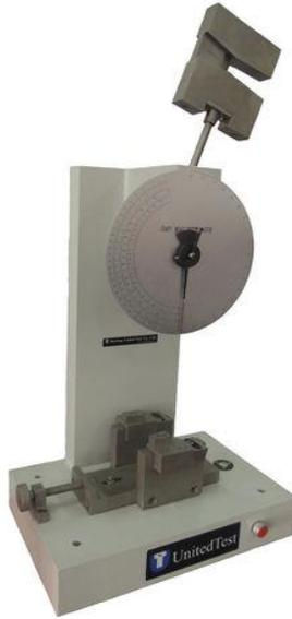
Slika 1. Charpyjev bat s mjernom skalom
