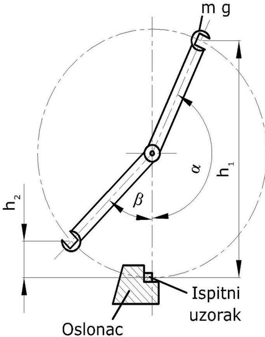
Slika 15. Ispitivanje udarnog rada loma na Charpyjevom batuu
