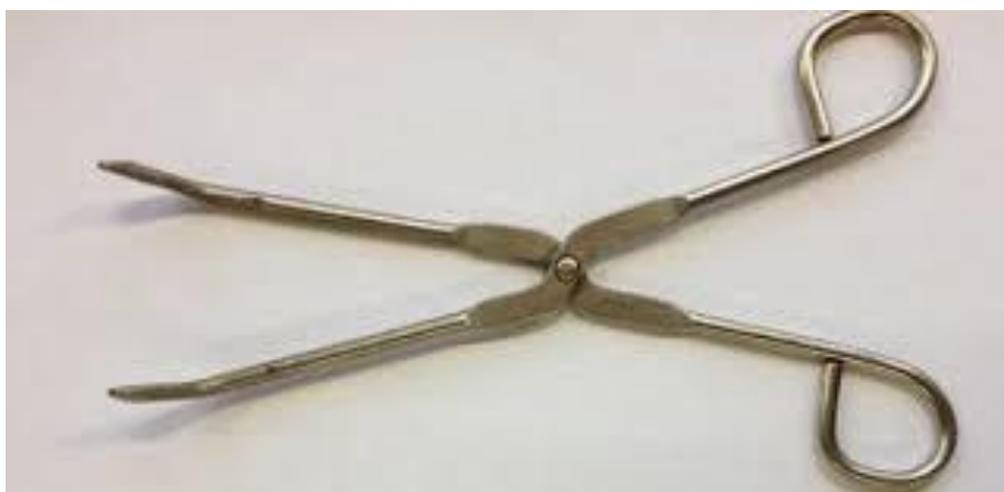
Slika 24. Hvataljka za prenošenje ispitnog uzorka
