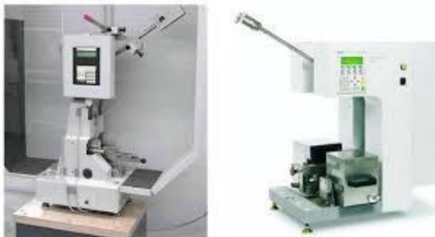
Slika 19. Suvremena izvedba Charpyjevog bata za male iznose energija
