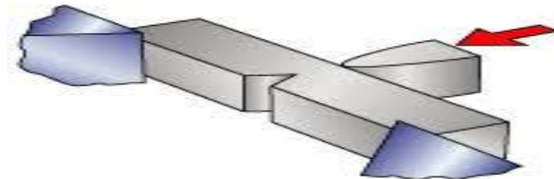
Slika 13. Udarno opterećenje epruvete na Charpyjevu batu
