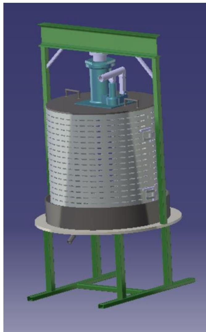
**Slika 50.** Preša sa hidrauličnom dizalicom (3D model).
