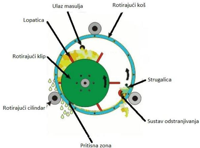
Slika 4. Shematski prikaz kontinuirane preša.[7]
