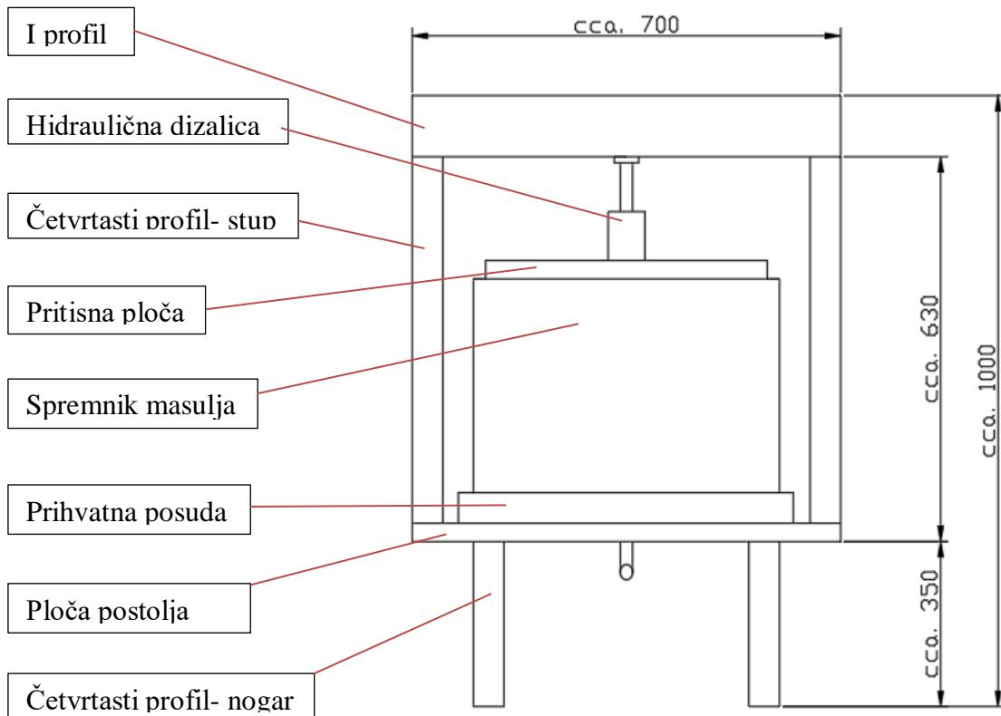
**Slika 16. Shematski prikaz preše sa okvirnim dimenzijama.**
