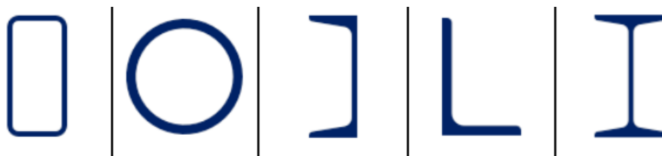
Slika 21. Osnovni oblici greda. [13]
