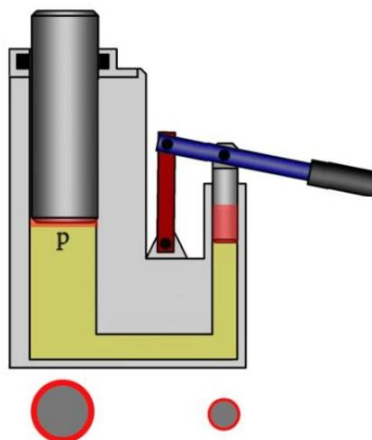
**Slika 24.** Shematski prikaz površine klipova te njihovi pomaci.[15]
