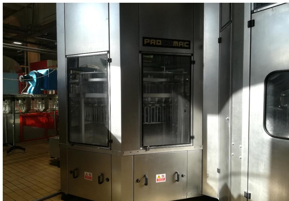
Slika 19. Prikaz stroja sa čvrstom zaštitnom napravom.
