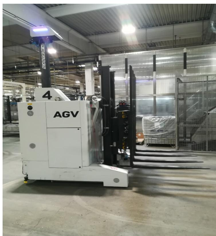
Slika 16. Robot viličar za pogonski dio firme.
