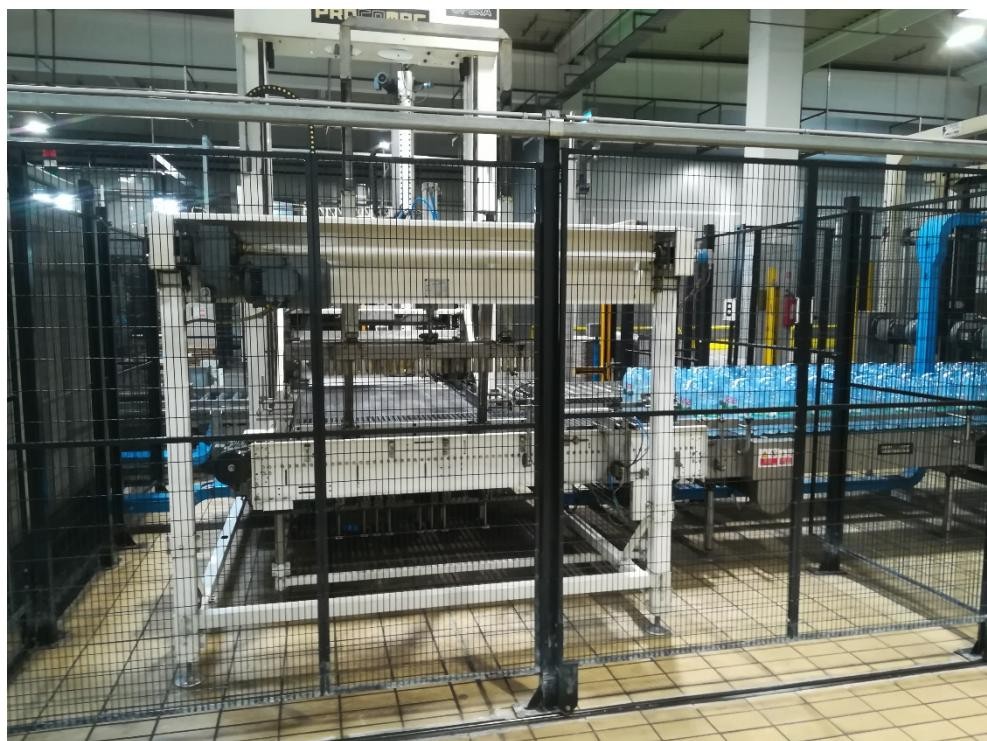
Slika 13. Zaštitna ograda između stroja i radnog prostora.
