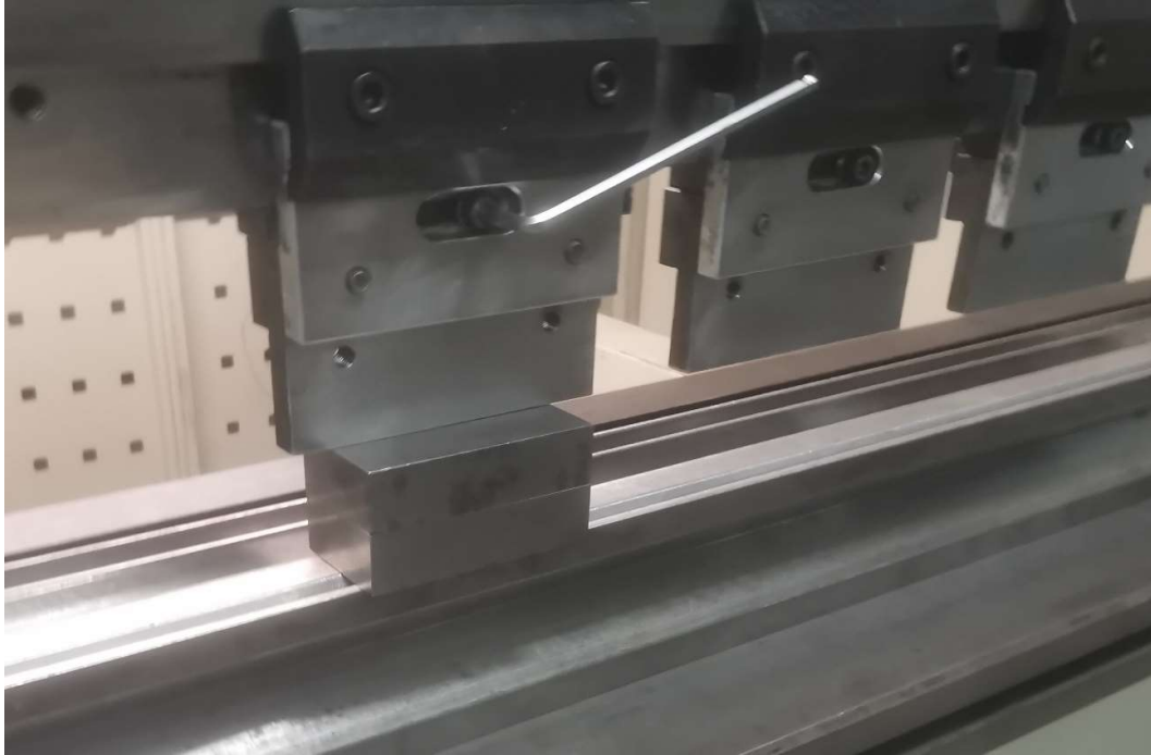
Slika 38. Montaža prihvatnika žiga pomoću etalona
