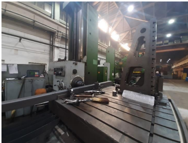
Slika 3. Horizontalna bušilica i glodalica WHN 13 A
