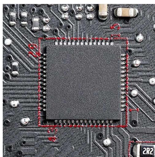
Slika 4. Kontroler napajanja [4]
