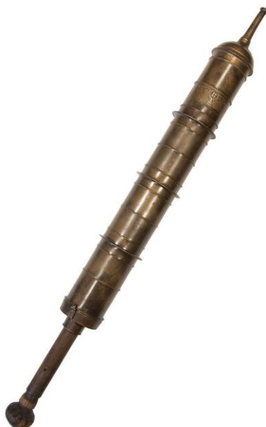
Slika 2: Ručna jednostapna ručna pumpa za gašenje požara
