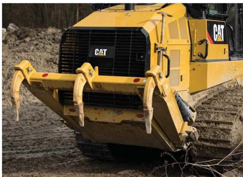
Slika 15. b Utovarivač stražnja strana prikazuje višestrani podrivač
