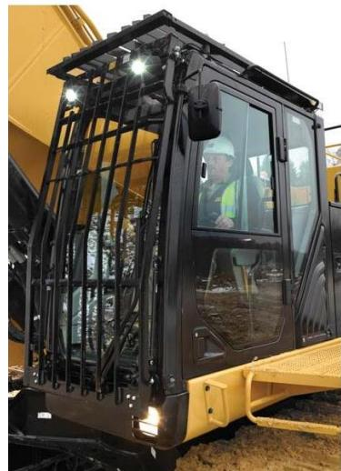
Slika 20. b Zaštitna naprava na velikom bageru metalni štitnik kabine
