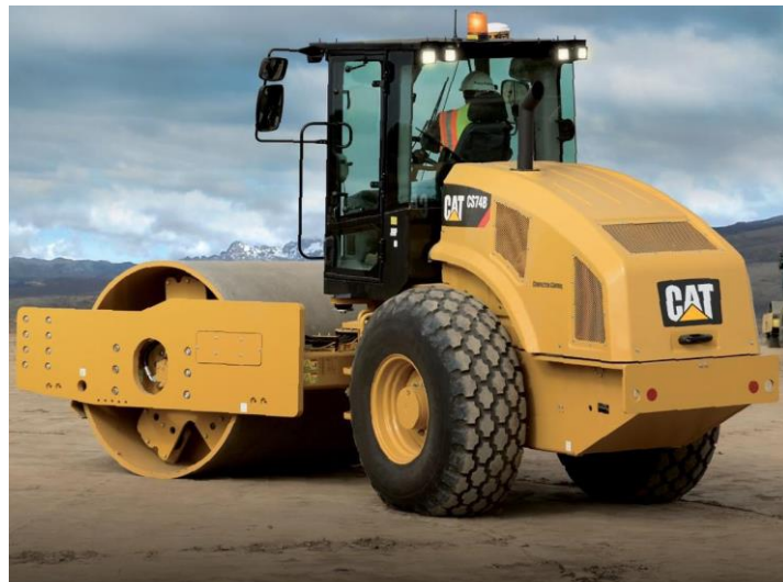
Slika 16. Cat nabijač zemlje (tla) s jednim valjkom
