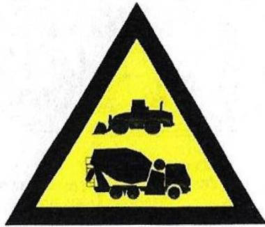
Prilikom dolaska u zonu radova radnih strojeva, kamiona i ostalih vozila, potrebno je o svojoj prisutnosti obavijestiti operatera / vozače te se kretati i zadržavati u vidnom području operatera / vozača i na sigurnoj udaljenosti od radnih strojeva, kamiona i ostalih vozila.
