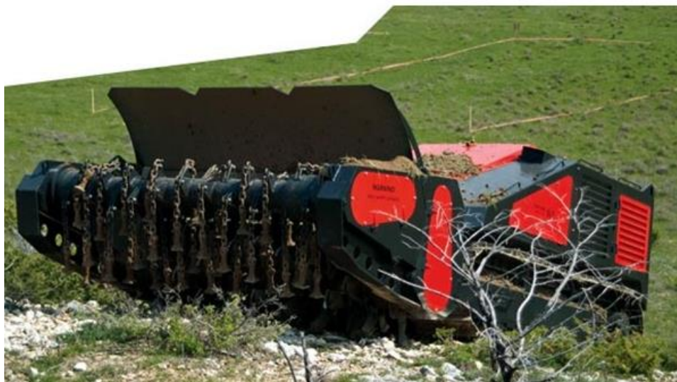
Slika 1. Stroj za razminiranje s mlatilicama [9]
