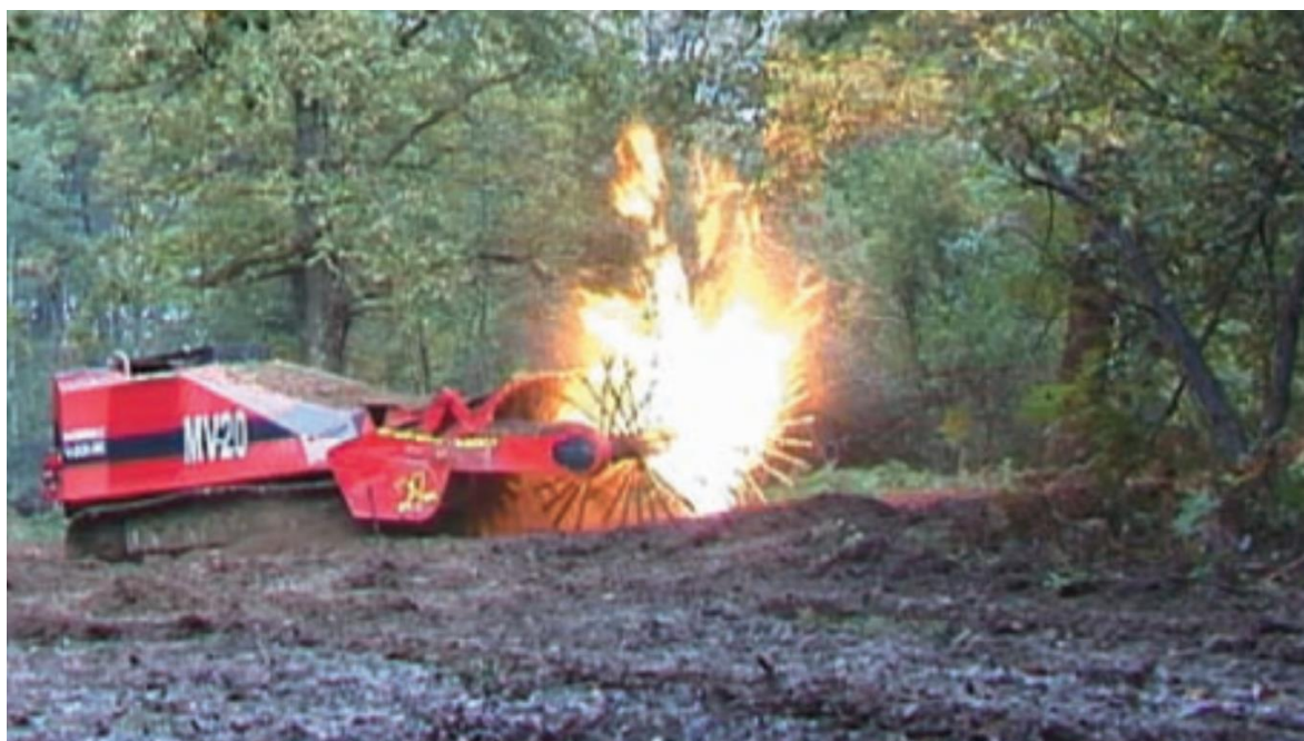
Slika 11. Detonacija mine ispod mlatila [4]
