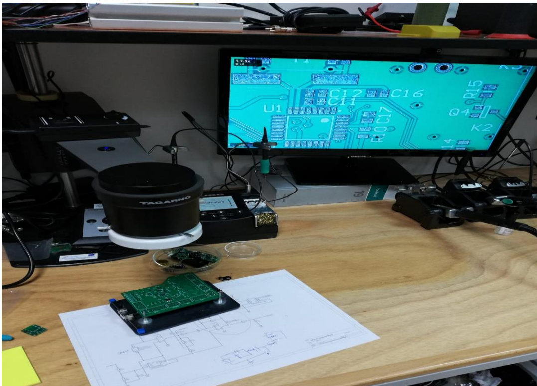
Slika 16: Provjeravanje lemnih mjesta na Tagarno uređaju.
