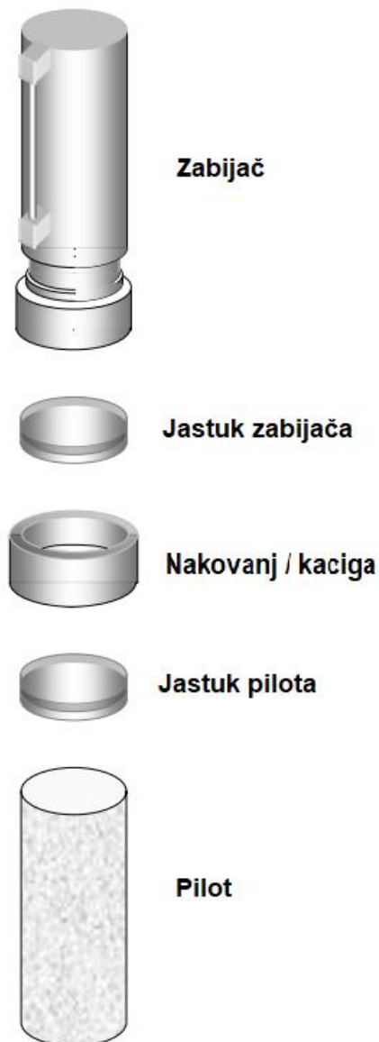
Slika 14. Sustav zaštite pilota [22]
