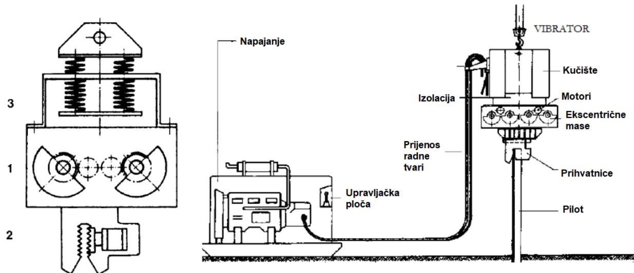
Slika 22. Komponente zabijača (lijevo): 1.) Ekscentrične mase 2.) Stezaljke 3.) Izvor
