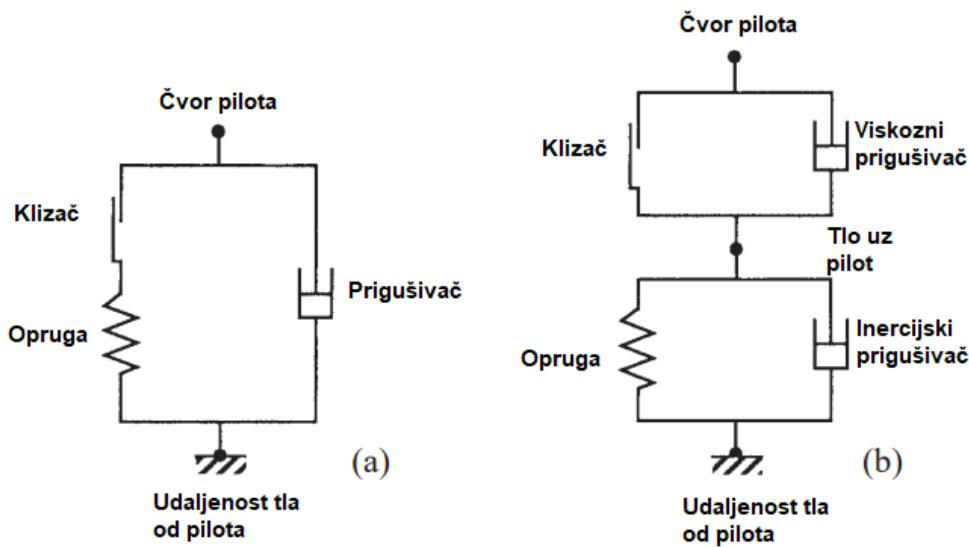
Slika 32. Modeli tla za dinamičko testiranje: (a) izvorni model tla autora Smith, 1960
