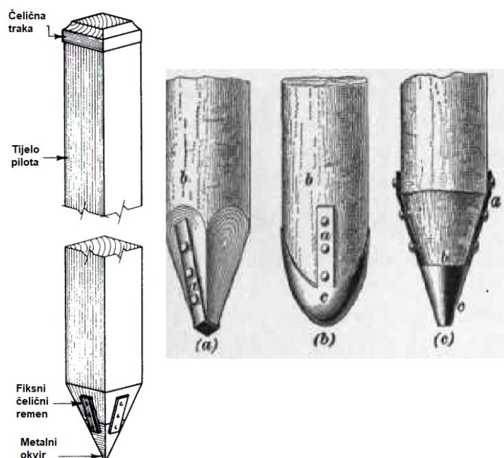
Slika 12. Primjer zaštite drvenog pilota [2]
