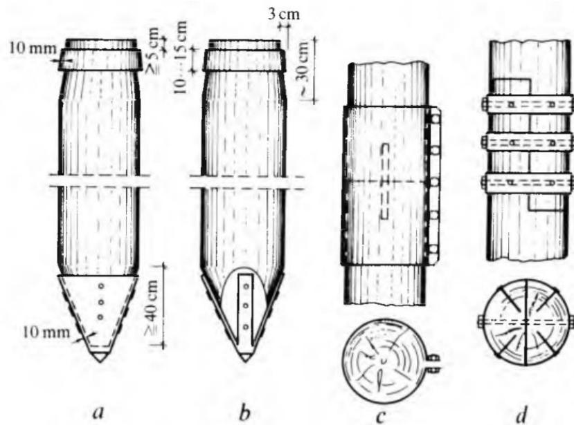
Slika 11. Okivanje glave, vrha i nastavljanje drvenih pilota [10]
