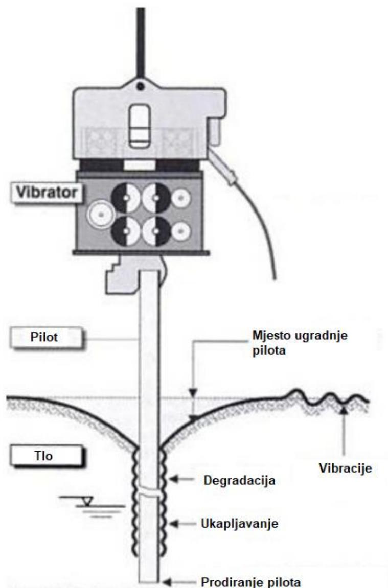
Slika 19. Ilustracija vibracijskog zabijanja [16]
