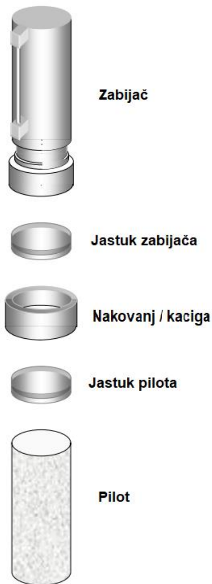
Slika 14. Sustav zaštite pilota [22]
