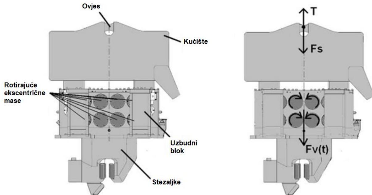
Slika 20. Komponente vibracijskog malja [17]
