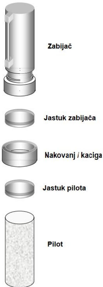
Slika 14. Sustav zaštite pilota [22]
