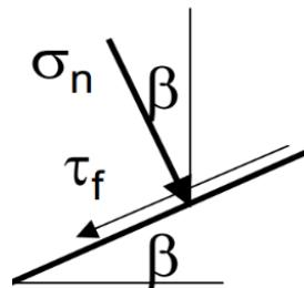
Slika 1. Prikaz Mohr-Coulombovog zakona posmične čvrstoće [26]
