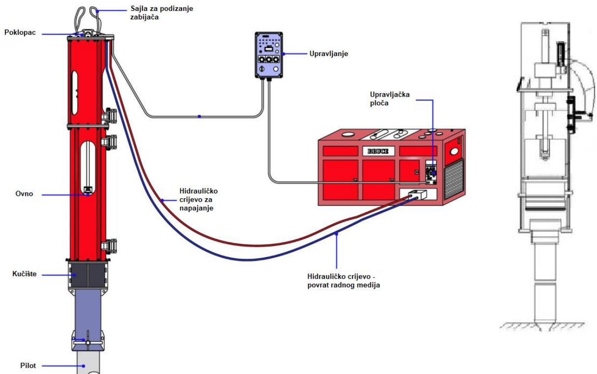
Slika 17. Hidraulični čekić [26]
