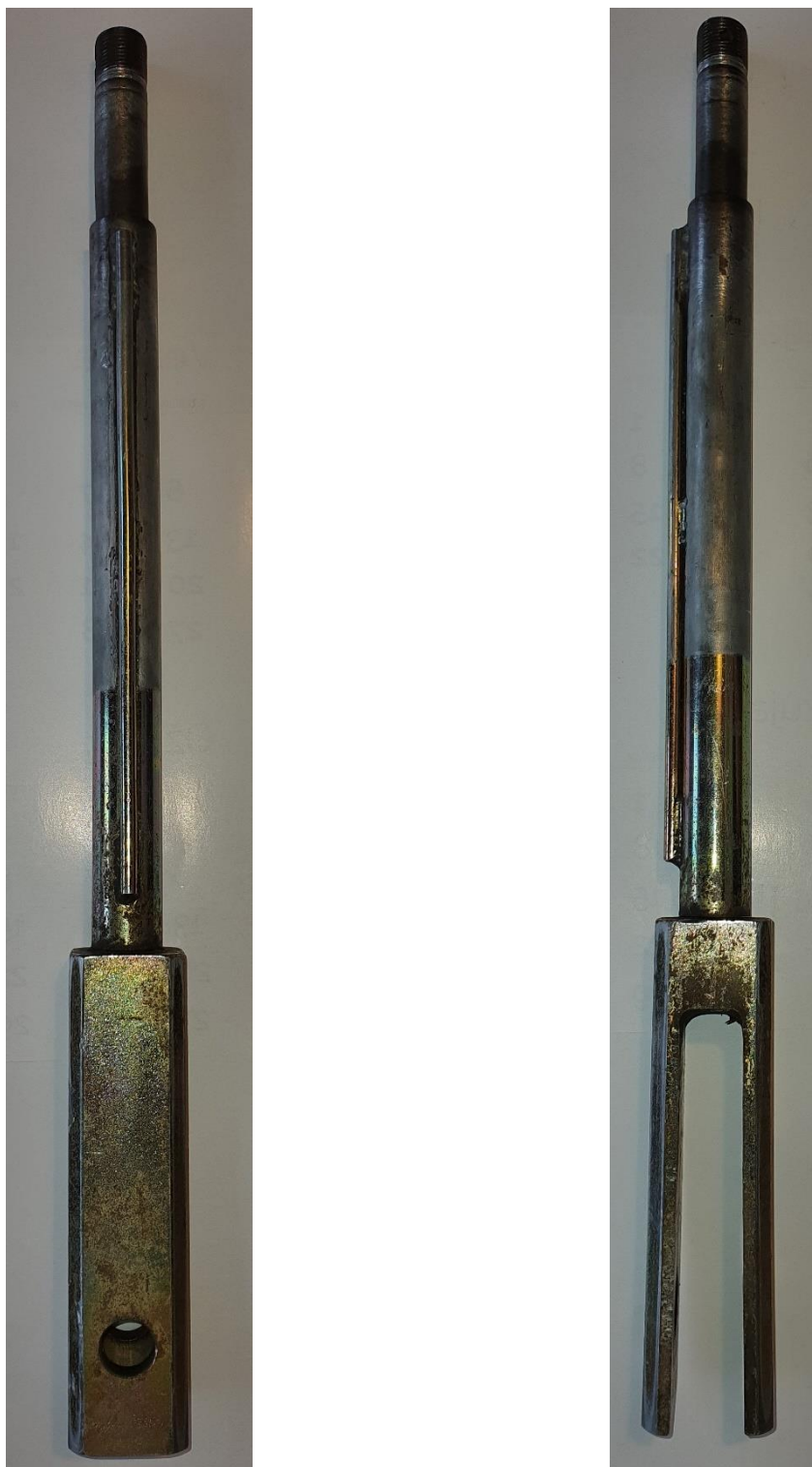
Slika 21. Pozicija 6 i 7 - Vreteno i vilica
