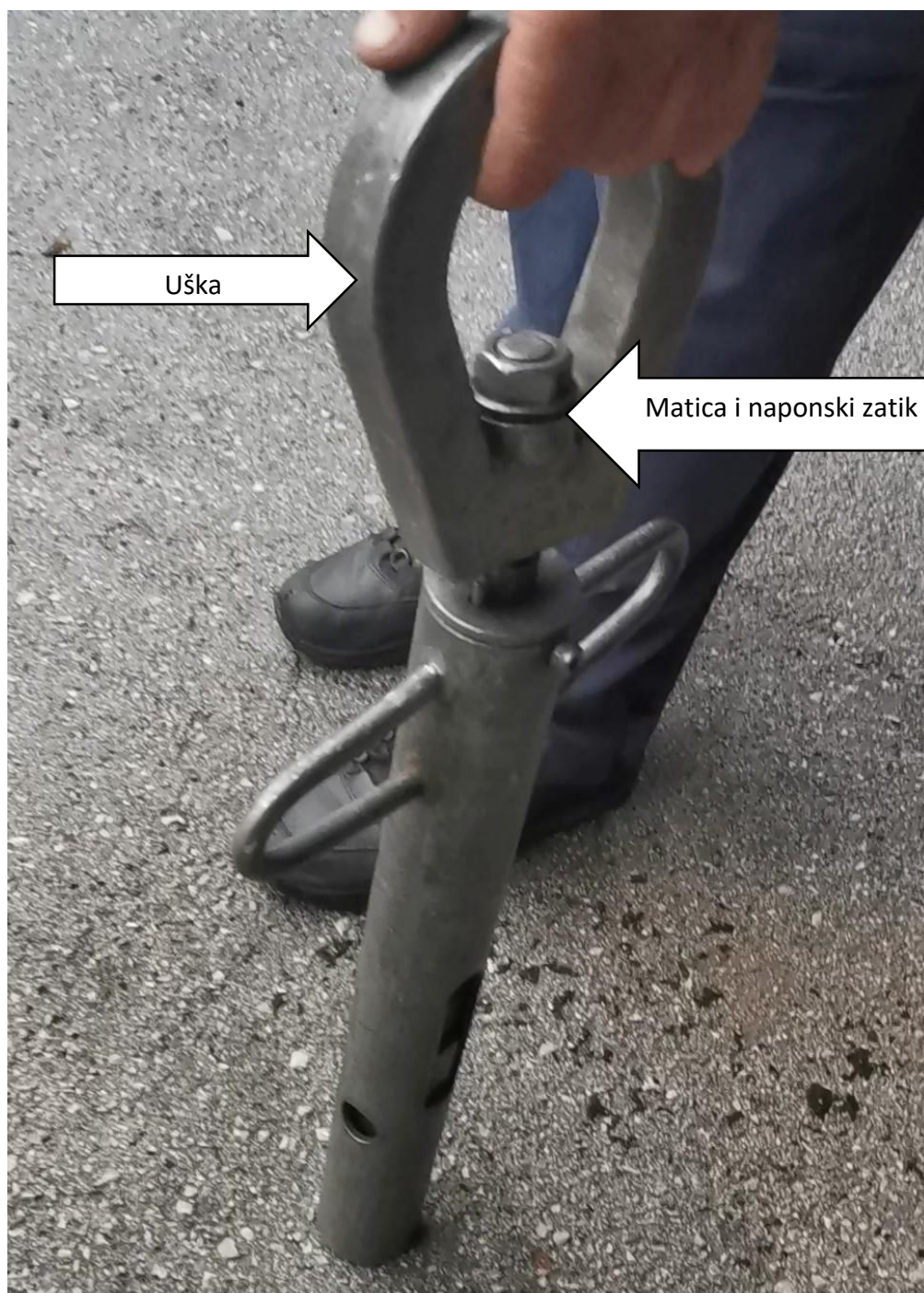
Slika 17. Naprava za podizanje bubnjeva u početnom položaju
