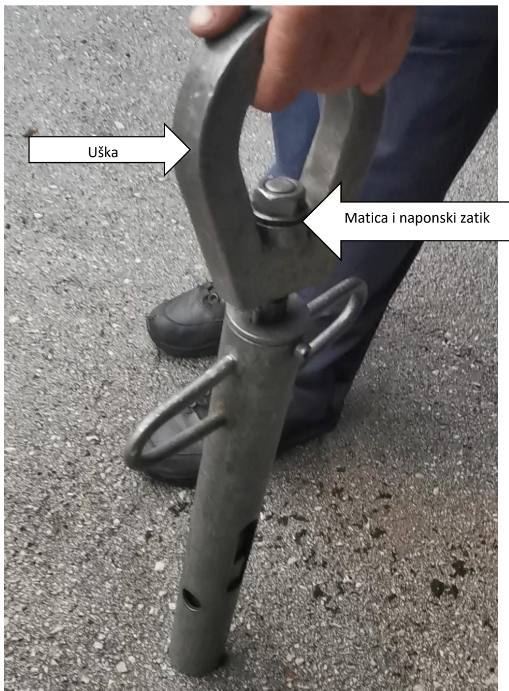
Slika 17. Naprava za podizanje bubnjeva u početnom položaju
