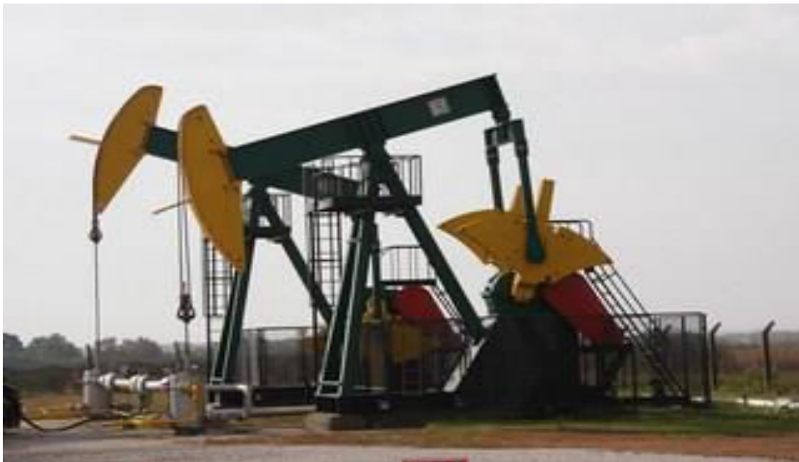
Slika 1 Podizanje nafte dubinskim sisaljka [7]
