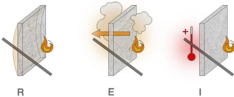
Slika 5. - Shematski prikaz svakog pojedinog REI faktora vatrootpornosti[10]
