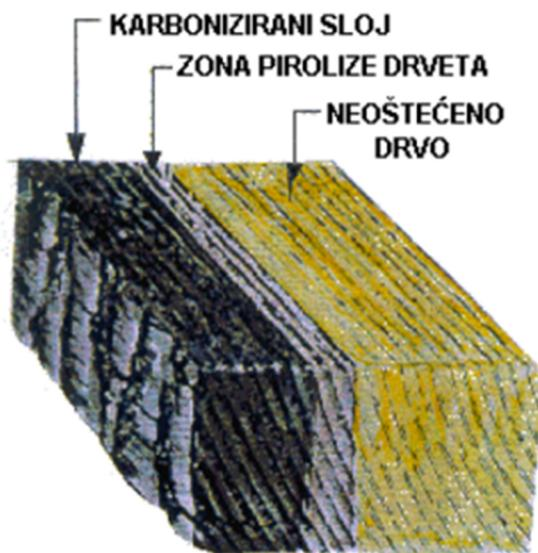
Slika 15. - Vrste zona drveta koje nastaju djelovanjem požara[6]
