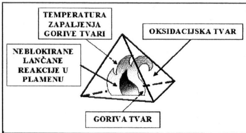
Slika 2. - Shematski prikaz nužnih uvjeta za zapaljenje i održavanje nesmetanog/neprekinutog izgaranja gorivih tvari koje izgaraju isključivo plamenom ili kombinacijom plamčenja i žarenja[2]
