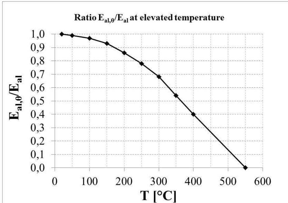
Slika 19. - Grafički prikaz međuvisnosti modula elastičnosti i temperature za aluminij[35]
