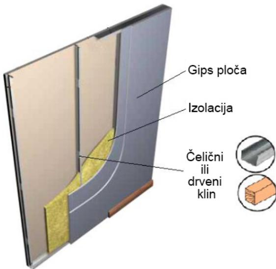
Slika 24. - Presjek tipičnog sklopa ziđa od gipsanih ploča[40]
