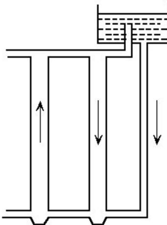
Slika 11. - Shematski prikaz primjene protočnog sustava opskrbe rashladnom vodom na presjeku čelične konstrukcije[23]
