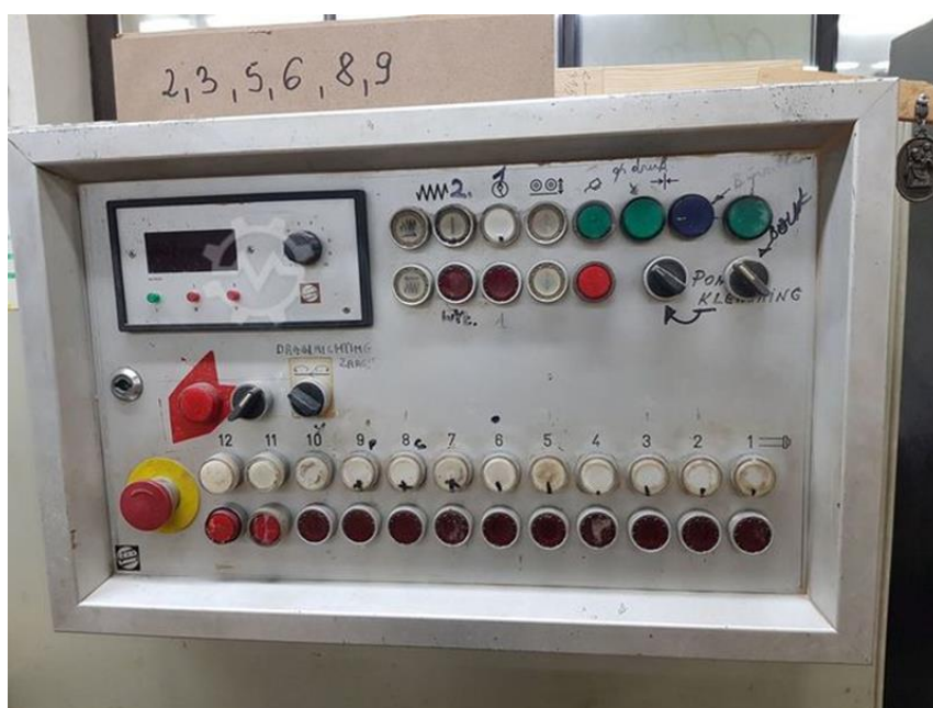
Slika 28. Komandna ploča za pomicanje vretena i kontrolu dimenzija obradka (Stolarija Jakopčin)
