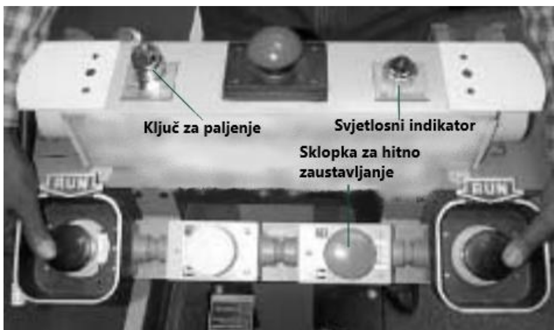
Slika 10. Primjer dvoručnog sustava za pokretanje hidrauličke preše [5]
