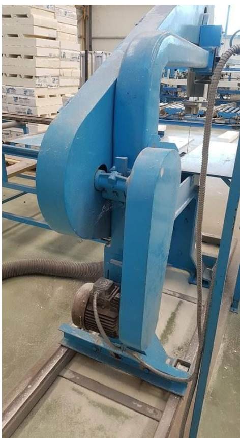
Slika 5. Zaštita na remenici elektromotora (Stolarija Jakopčin)
