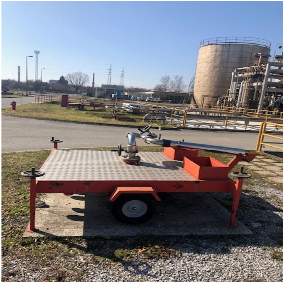
Slika 14. Mobilni bacač voda/pjena tip "Juring" na KP-6 [7]
