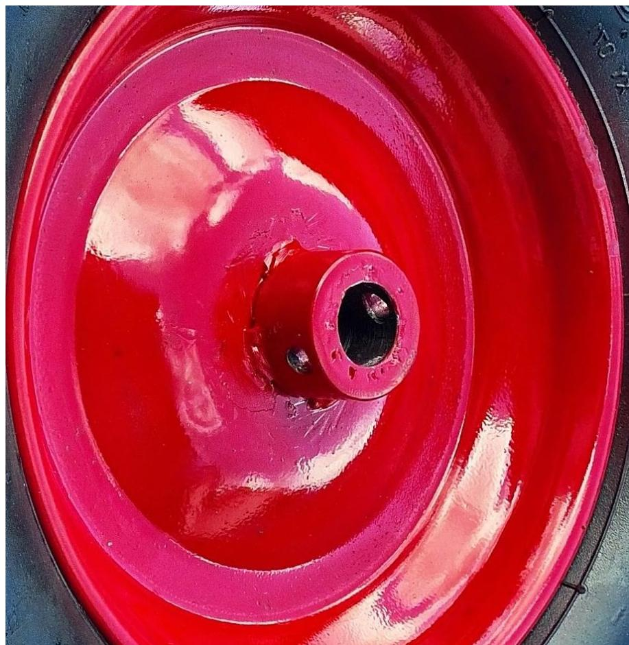
Slika 47 – Prikaz navlake zavarene na središte kotača.
