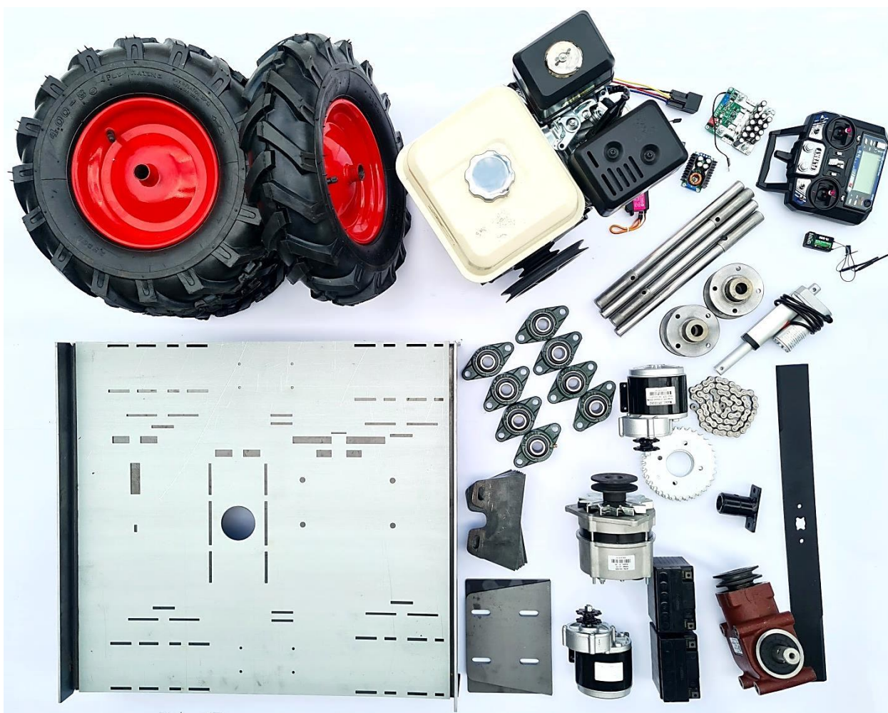
Slika 2 – Prikaz korištenih komponentata za izradu prototipa kosilice.
