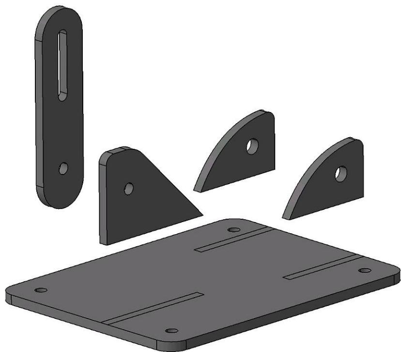
Slika 70 – 3D eksplodiran prikaz elemenata postolja alternatora.
