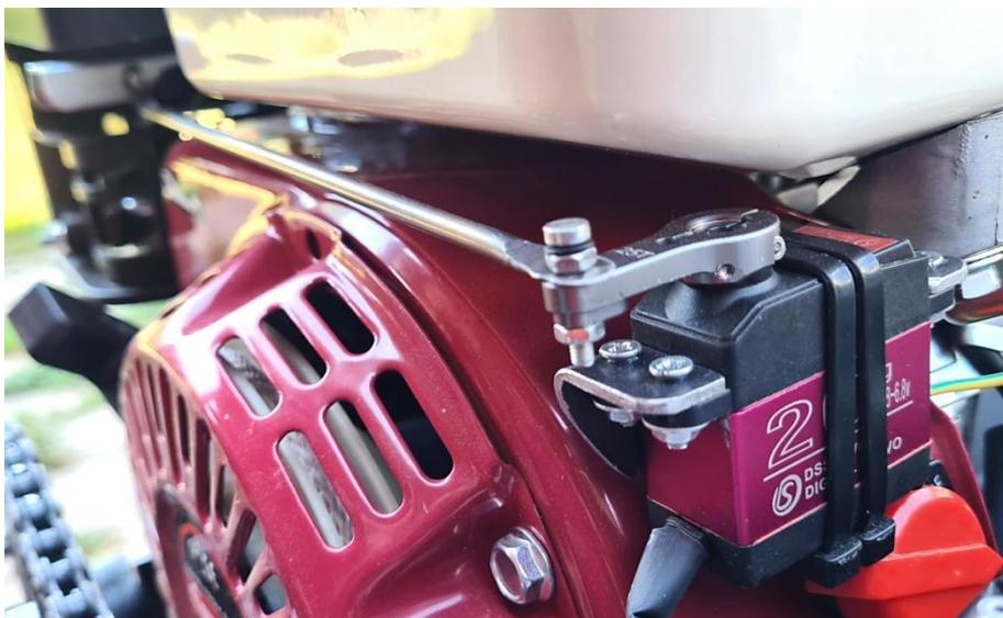
Slika 75 - Model pomicanja poluge „gasa“ benzinskog motora pomoću servomotora.
