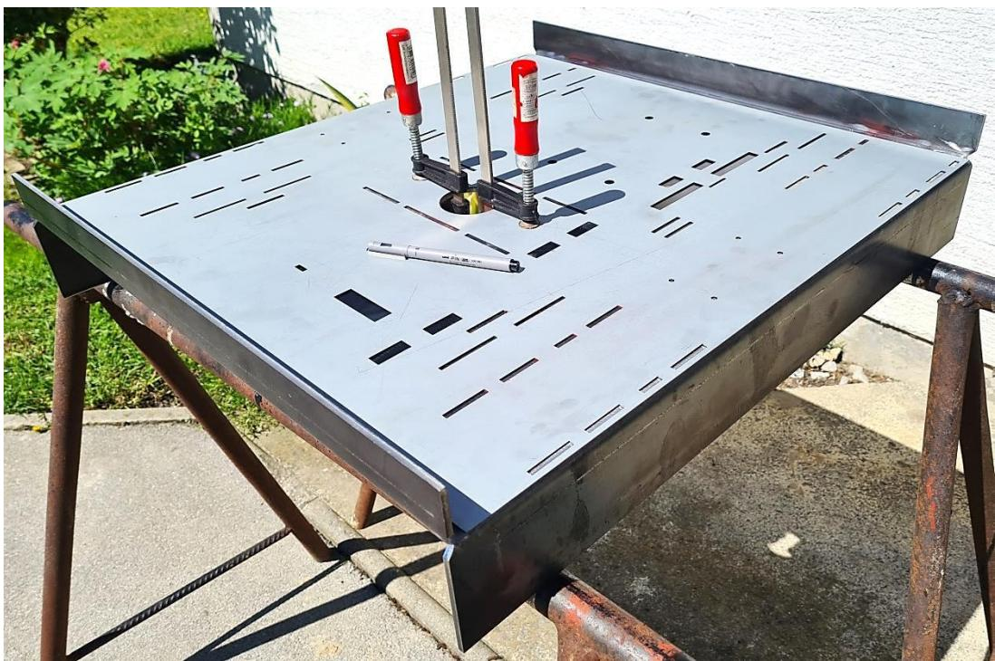
Slika 96 - Preslikavanje šablone na izrađeno glavno kućište kosilice.
