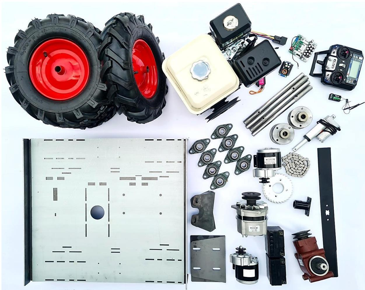
Slika 2 – Prikaz korištenih komponenata za izradu prototipa kositice.
