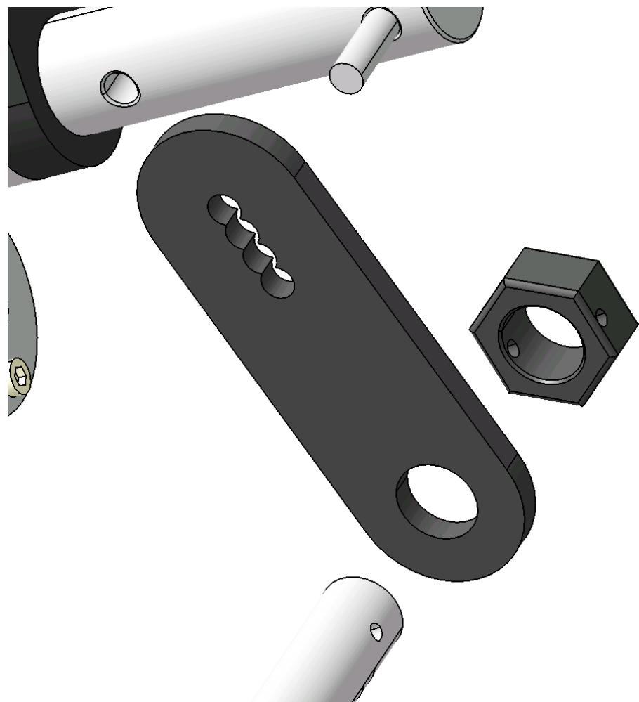
Slika 56 – 3D eksplodiran prikaz poluge linearnog aktuatora i matici M14.
