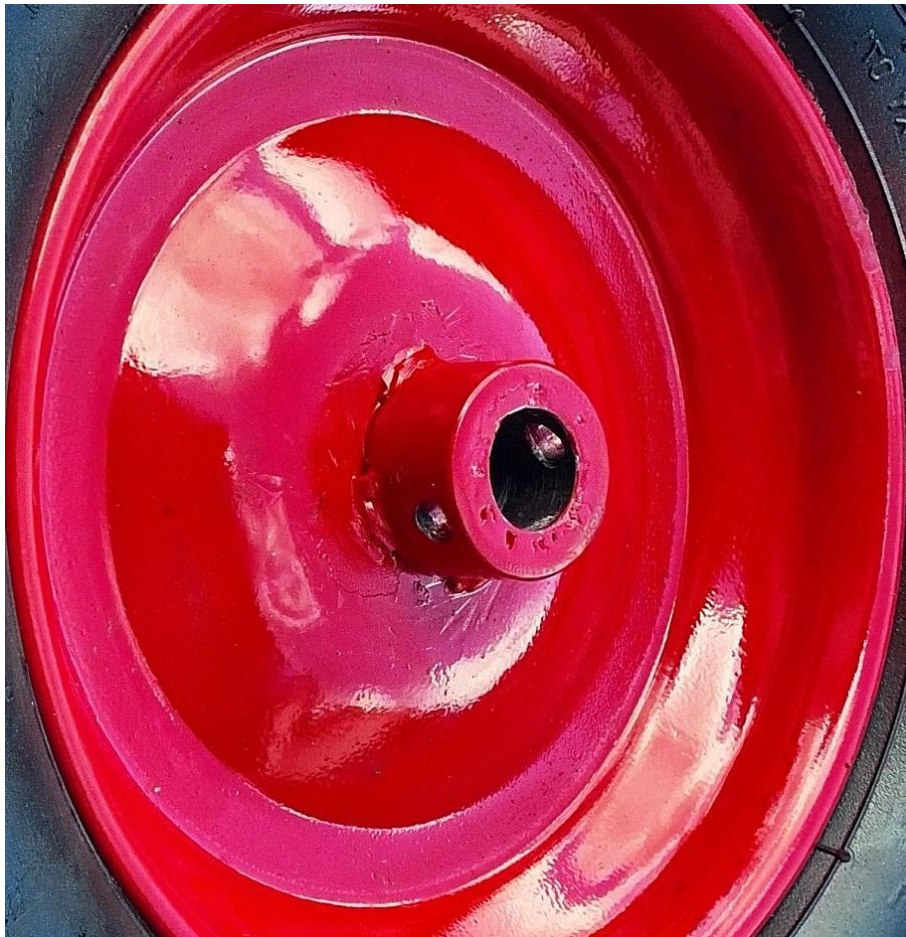
Slika 47 – Prikaz navlake zavarene na središte kotača.
