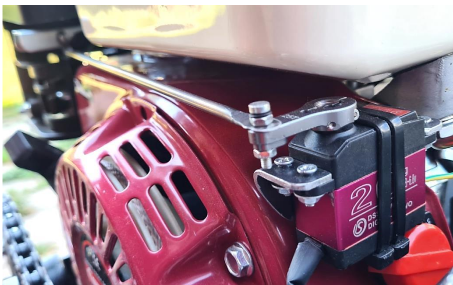
Slika 75 - Model pomicanja poluge „gasa“ benzinskog motora pomoću servomotora.
