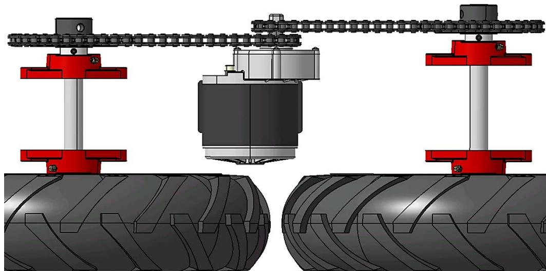
Slika 78 – 3D prikaz lijeve pogonske strane kosilice.
