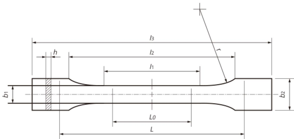
Slika 24. Ispitna epruveta prema ISO 527 [33]
