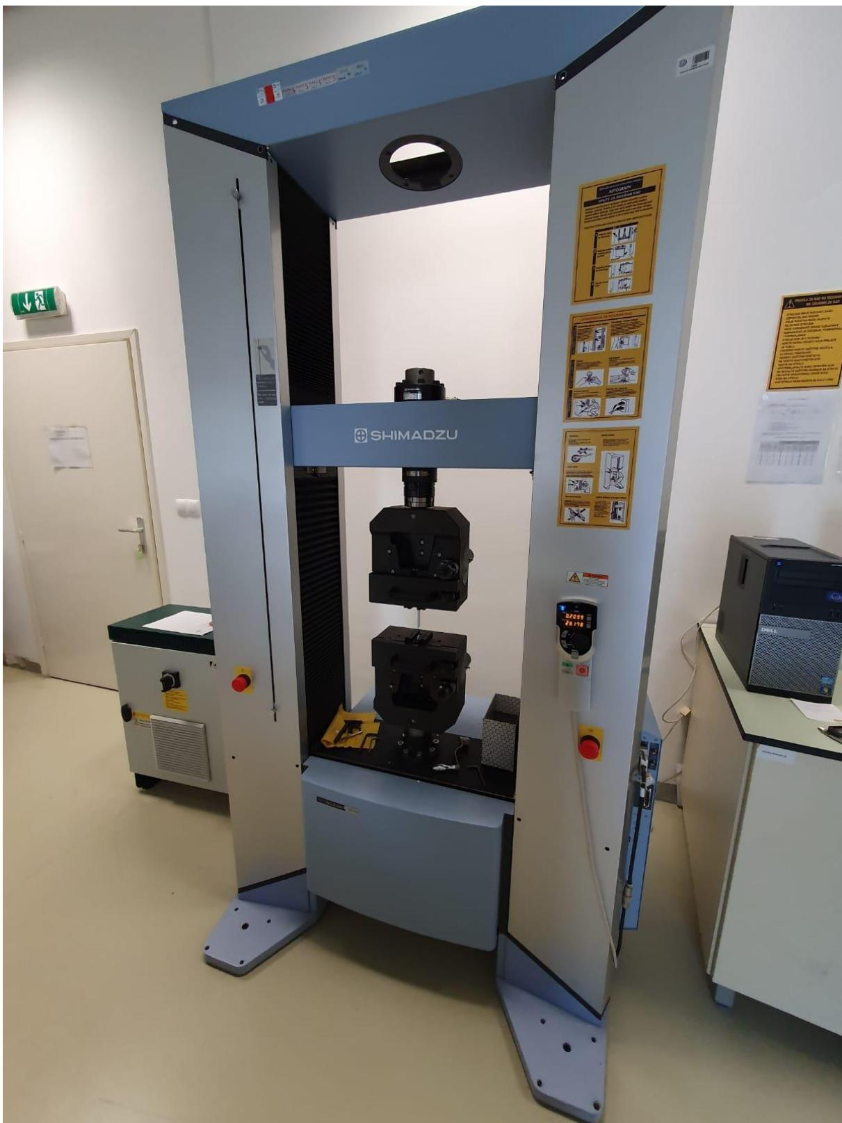
Slika 26. Prikaz Shimadzu AG-X kidalice
