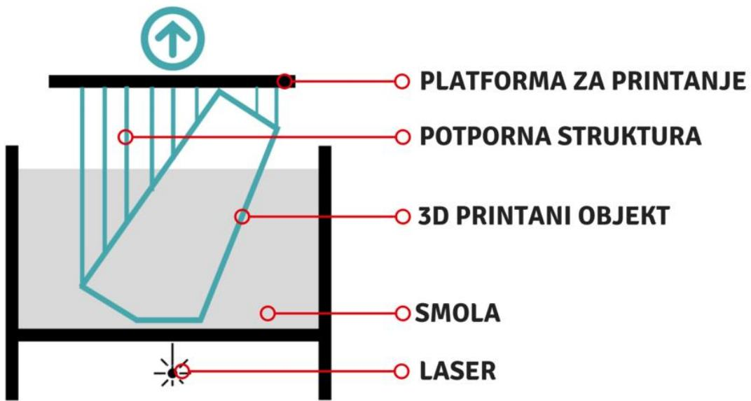
Slika 8. Primjer "Bottom up" SLA 3D printer-a [11]
