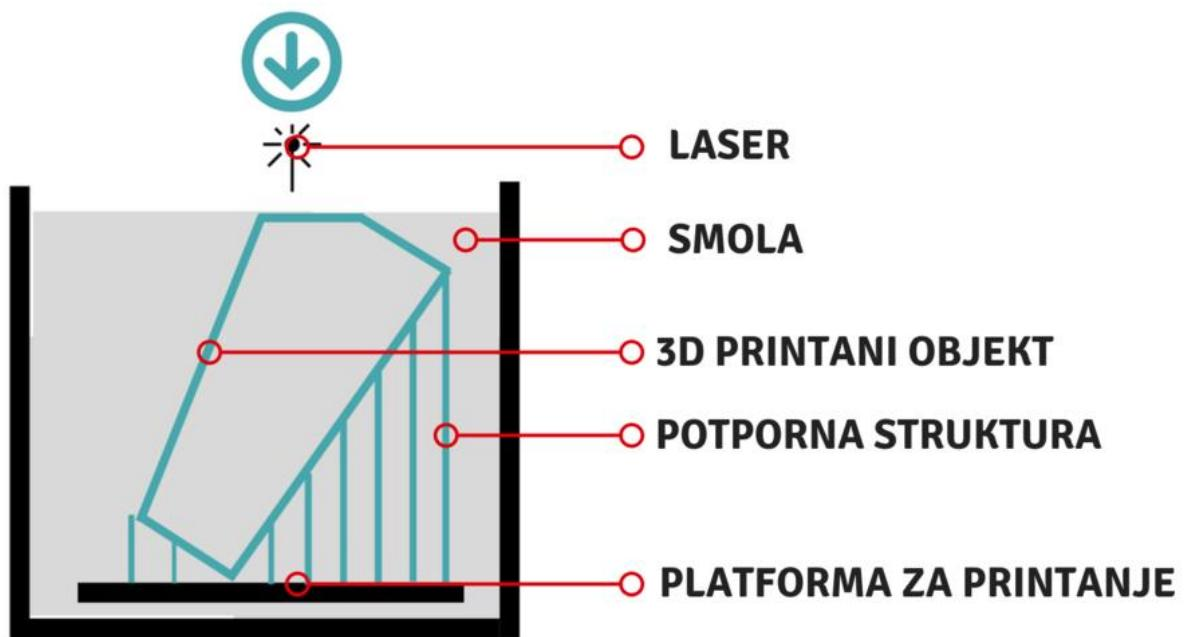
Slika 9. Primjer " Top down " SLA 3D printera [11]
