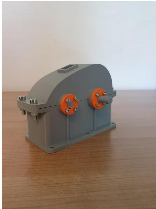
Slika 1. Primjer reduktora izrađenog FDM / FFF tehnologijom
