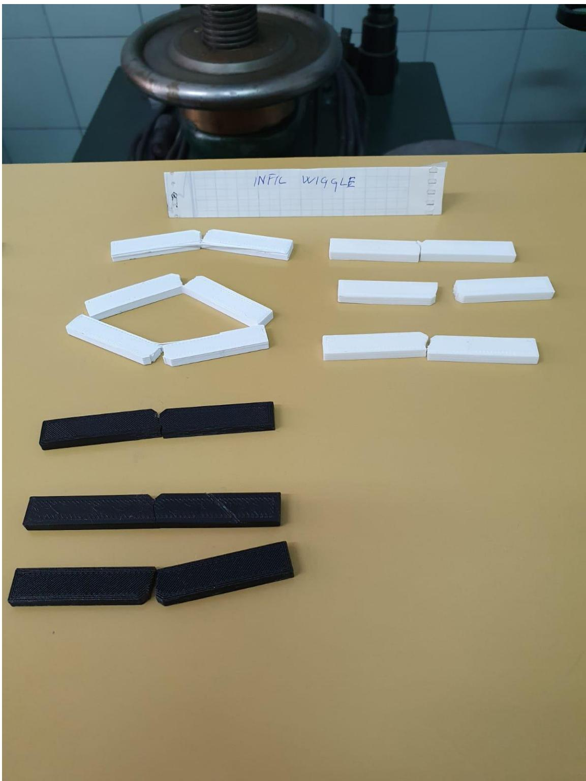
Slika 34. Prikaz ispitanih epruveta sa geometrijom ispune ( wiggle )
