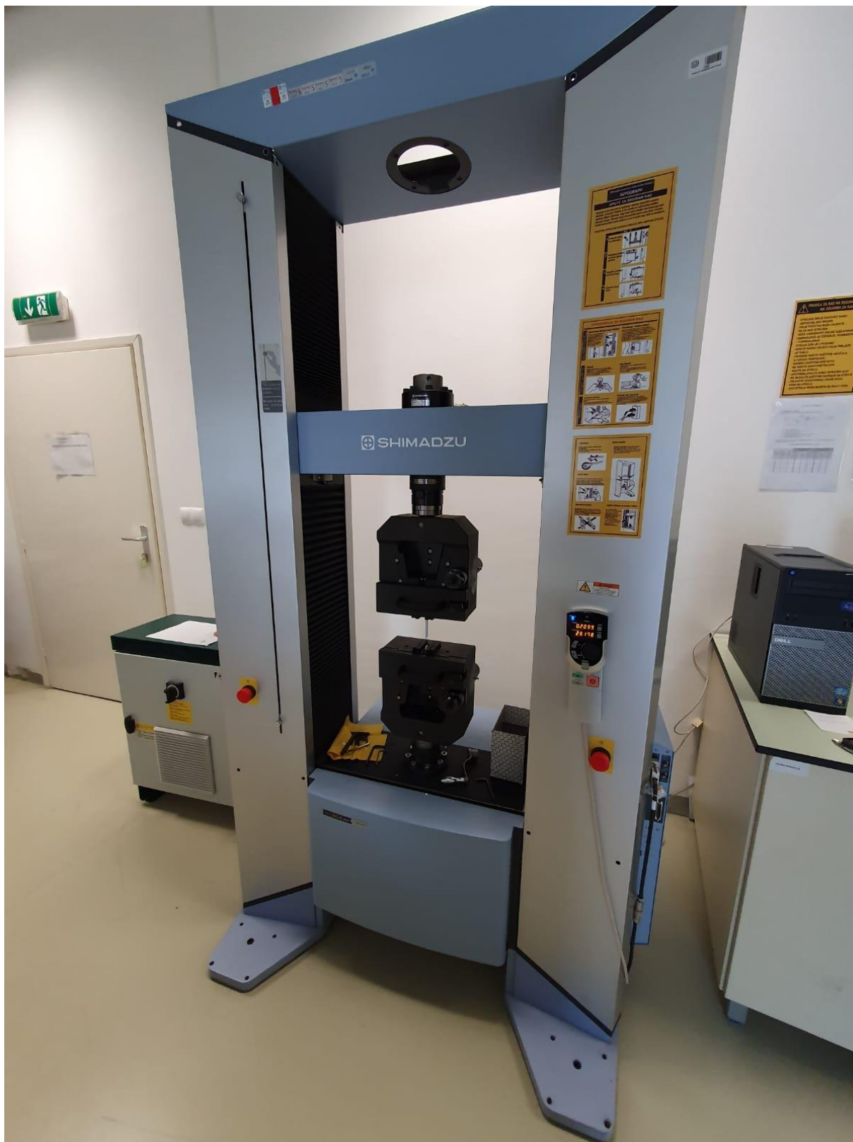
Slika 26. Prikaz Shimadzu AG-X kidalice
