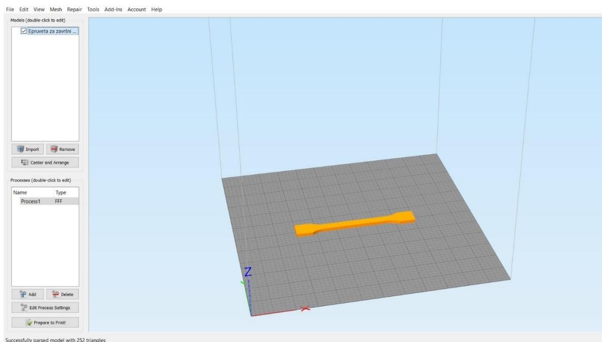
Slika 28. Prikaz Simplify3D sučelja sa učitanom epruvetom za statički vlačni pokus
