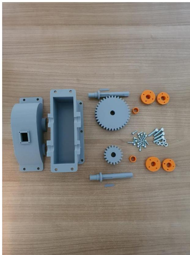
Slika 2. Primjer rastavljenog reduktora izrađenog FDM / FFF tehnologijom
