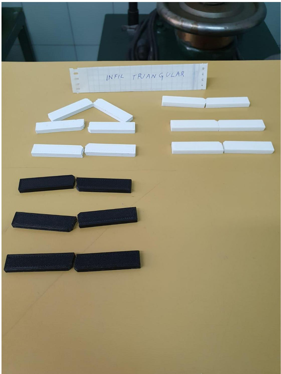
Slika 35. Prikaz ispitanih epruveta sa geometrijom ispune ( triangular )
