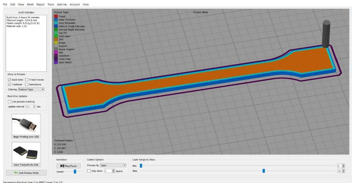
Slika 29. Prikaz "Slic-ane" epruvete spremne za 3D printanje
