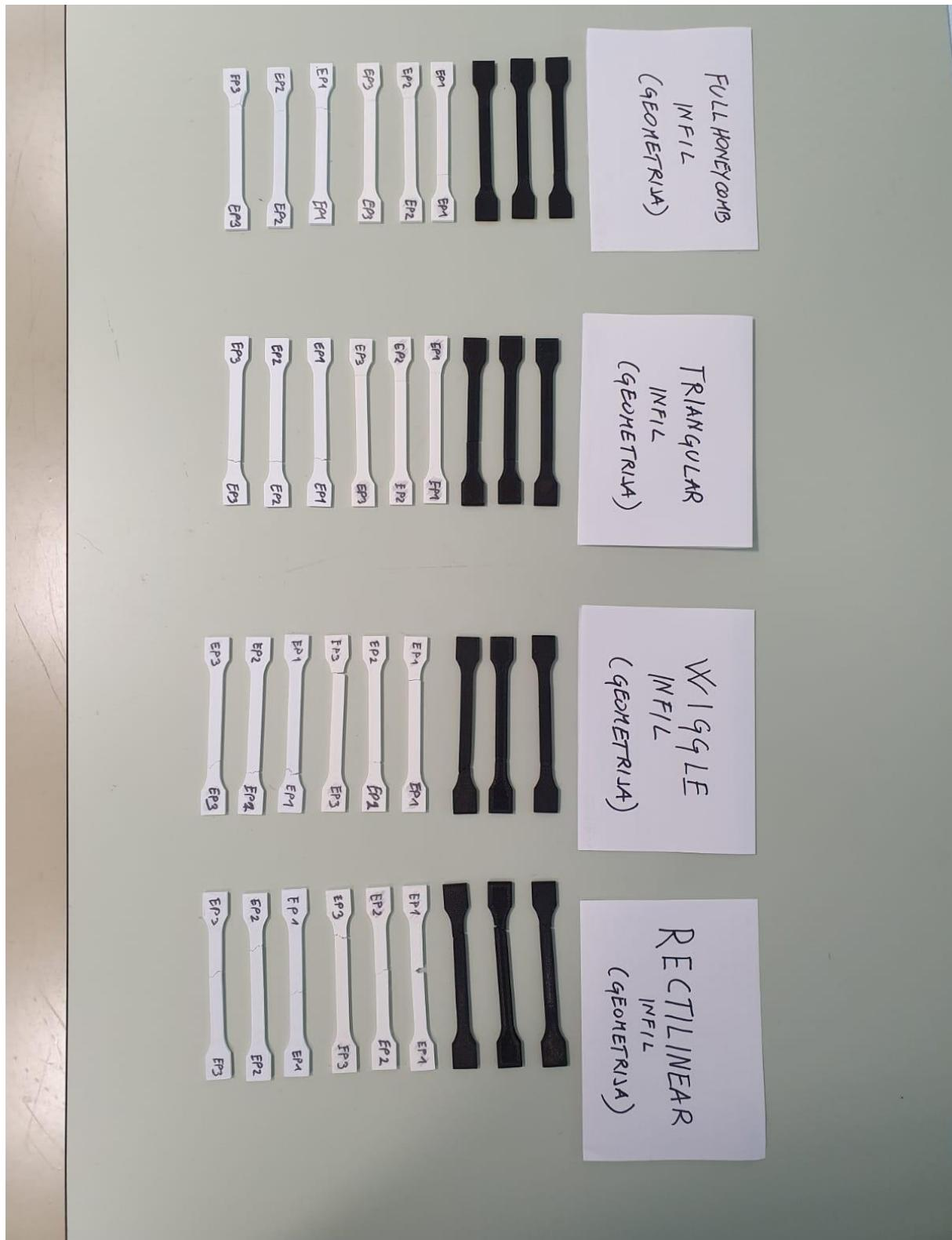
Slika 38. Prikaz ispitnih epruveta nakon provedenog ispitivanja
