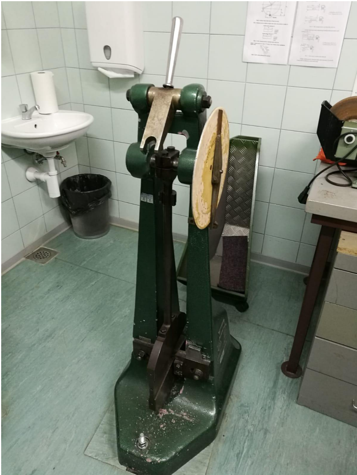
Slika 27. Otto wolpert werke uređaj za ispitivanje žilavosti
