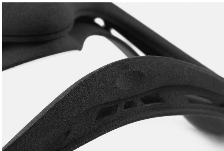
Slika 12. Primjer zrnaste površine, posljedica ispisa na SLS uređaju [13]
