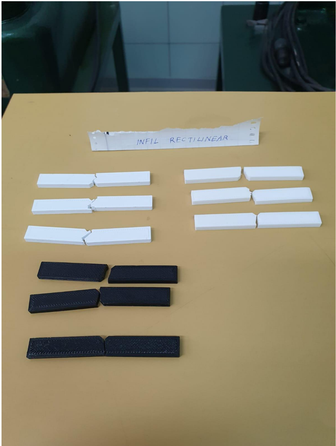
Slika 36. Prikaz ispitanih epruveta sa geometrijom ( rectilinear )
