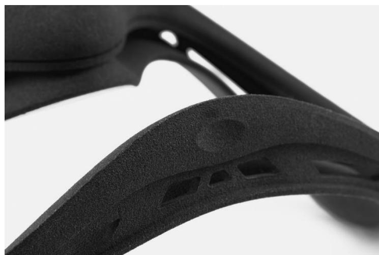
Slika 12. Primjer zrnaste površine, posljedica ispisana na SLS uređaju [13]
