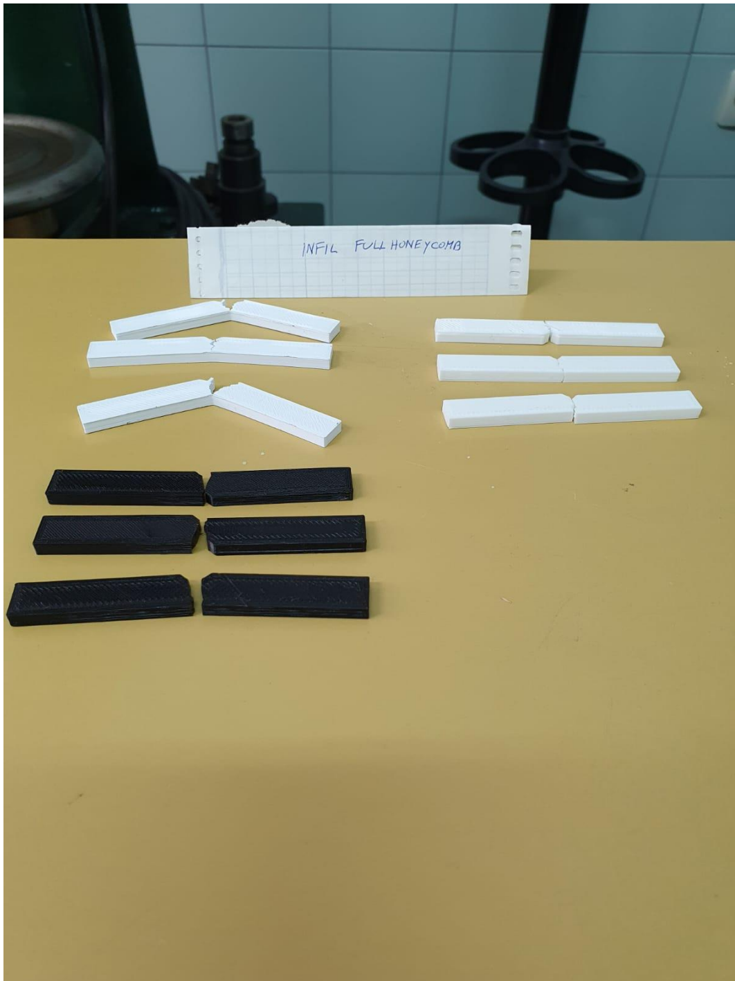
Slika 33. Prikaz ispitanih epruveta sa geometrijom ispune ( full honeycomb )
