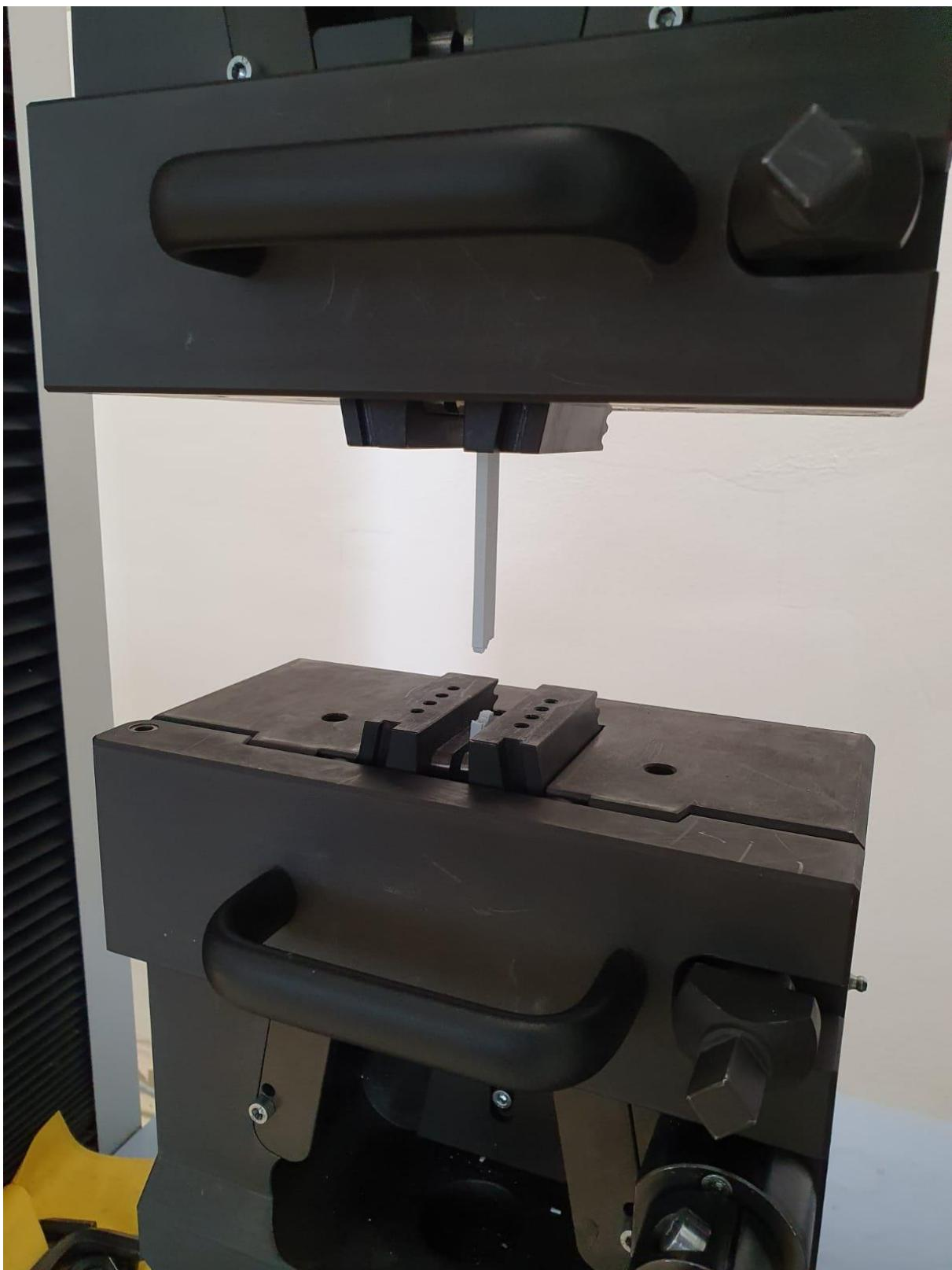
Slika 37. Prikaz ispitne epruvete nakon provedenog ispitivanja
