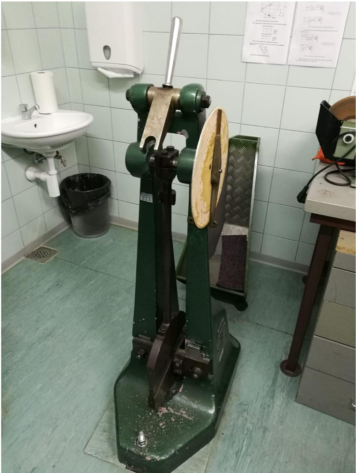
Slika 27. Otto wolpert werke uređaj za ispitivanje žilavosti
