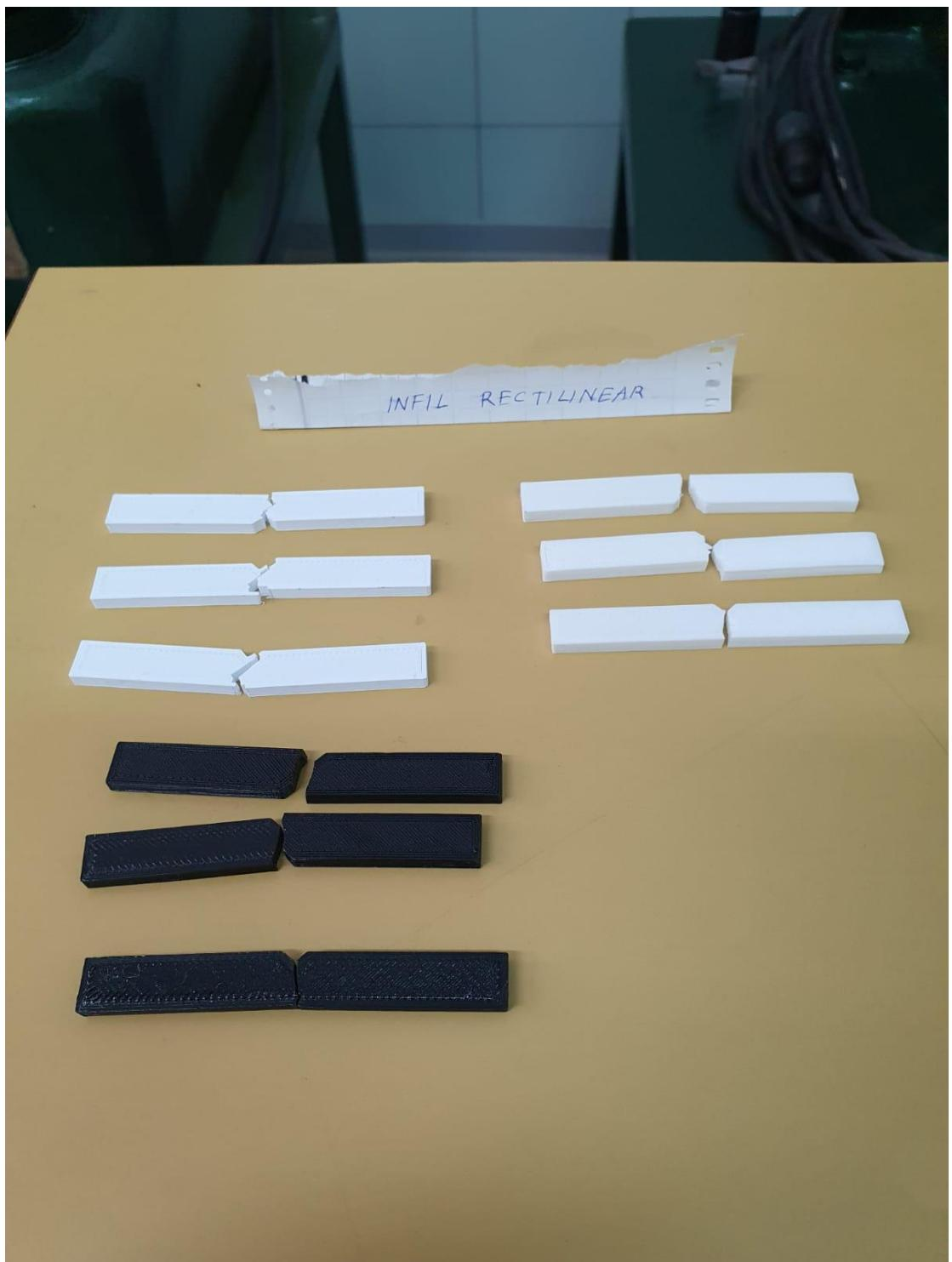
Slika 36. Prikaz ispitanih epruveta sa geometrijom ( rectilinear )
