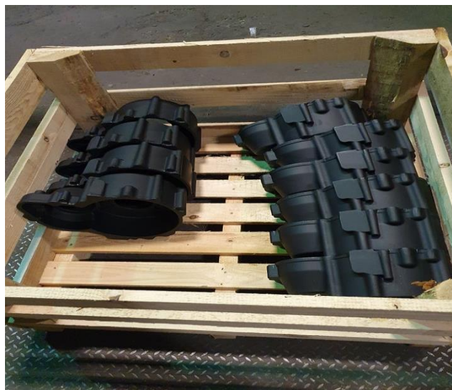
Slika 42.: DANA 104 nakon nanošenja premaza[10]
