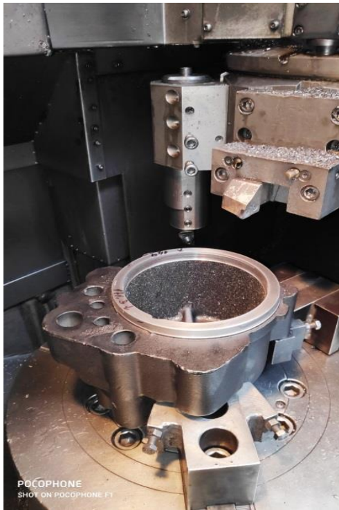
Slika 36.: DANA 104 nakon obrade (gruba i fina obrada, provrti) [10]
