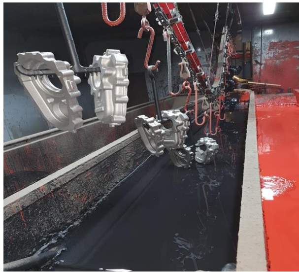
Slika 41.: Uranjanje odljevaka u bazen sa bojom[10]
