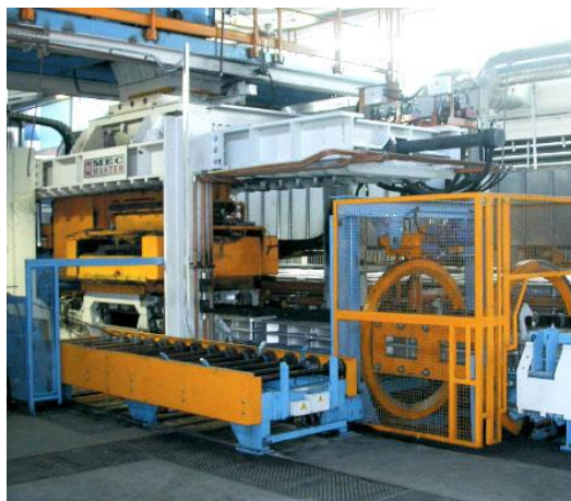
Slika 18.: MM automatska linija za kalupljenje[10]
