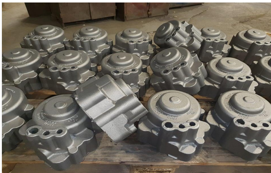
Slika 39.: Odljevci DANE 104 prije nanošenja premaza[10]
