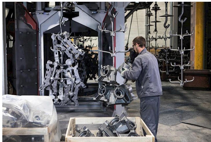
Slika 25.: Stroj za pjeskarenje[10]
