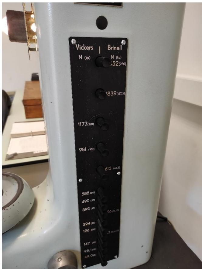
Slika 22. : Skala tvrdoće po Vickersu i Brinellu
