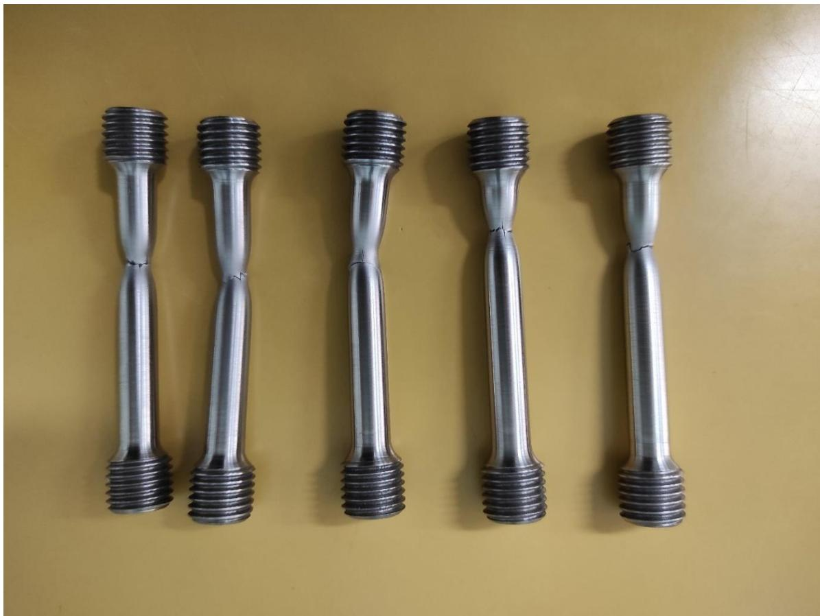
Slika 28. : Prikaz epruveta nakon provedenog statičkog vlačnog ispitivanja
