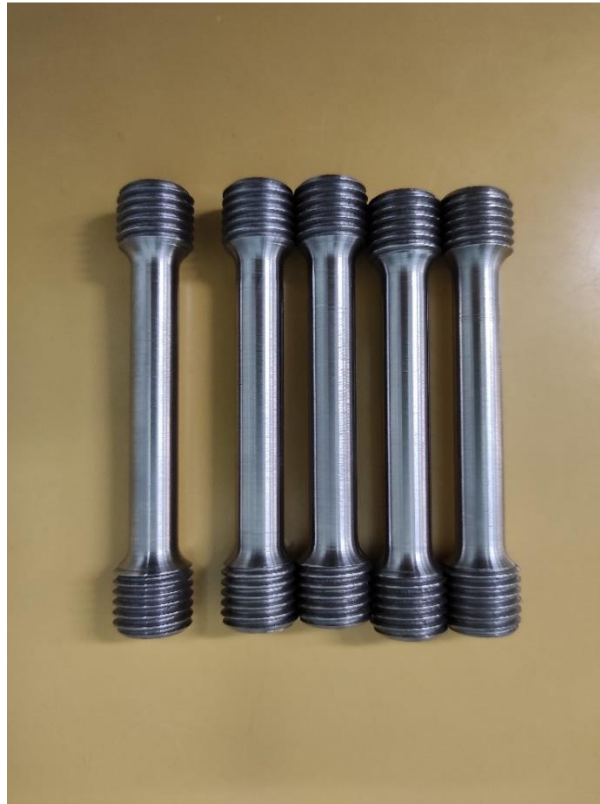
Slika 24. : Prikaz epruvete prije ispitivanja vlačne čvrstoće
