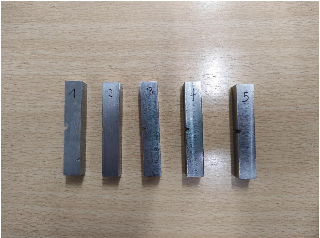
Slika 18. : Prikaz uzorka prije ispitivanja udarnog rada loma
