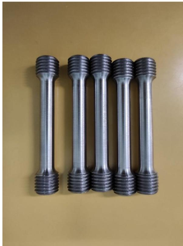
Slika 24. : Prikaz epruvete prije ispitivanja vlačne čvrstoće
