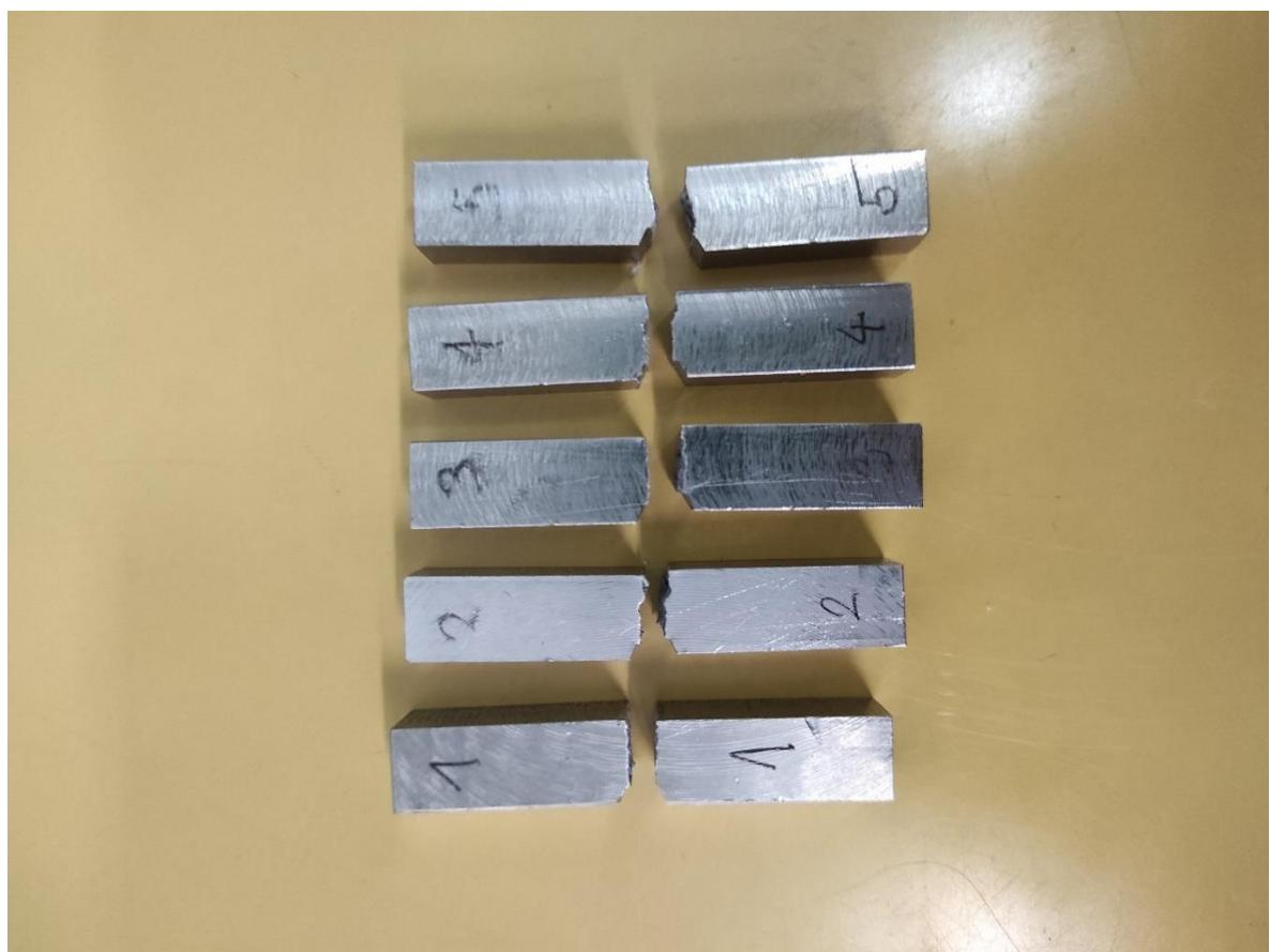
Slika 20. : Prikaz uzorka nakon provedenog ispitivanja udarnog rada loma
