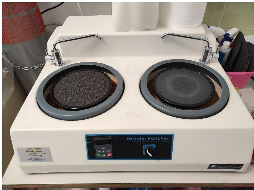
Slika 29. : Uređaj za brušenje i poliranje
