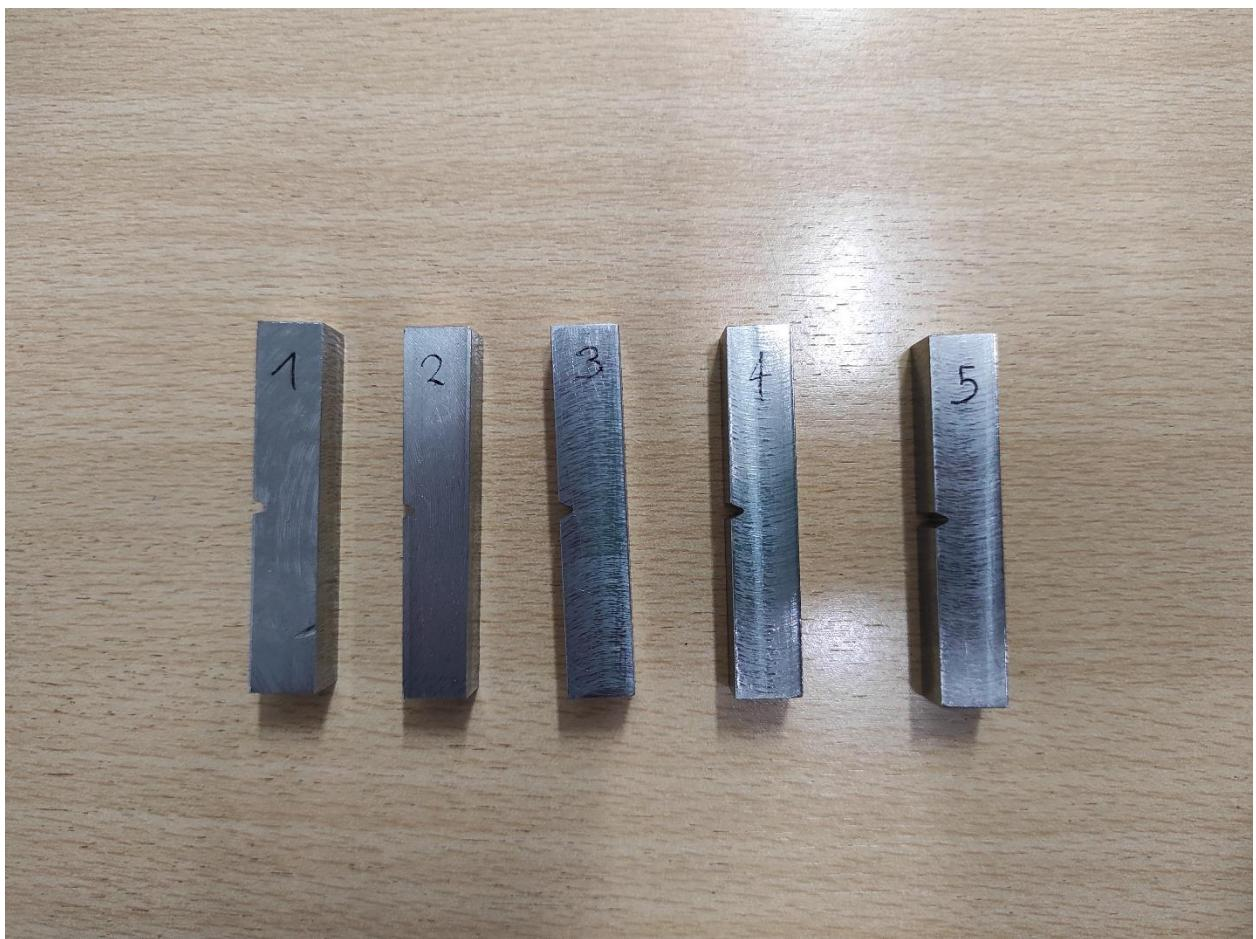
Slika 18. : Prikaz uzorka prije ispitivanja udarnog rada loma
