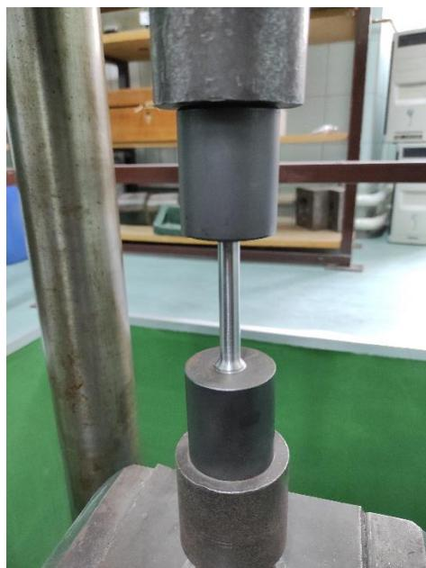
Slika 25. : Postavljanje epruvete u čeljust kidalice
