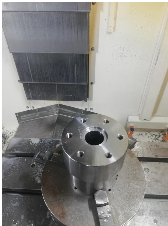
Slika 48. Cilindrični obradak sa 6 provrta
