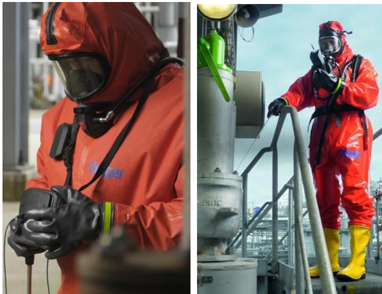
Slika 7: Mjerenje koncentracije amonijaka u zraku 71
