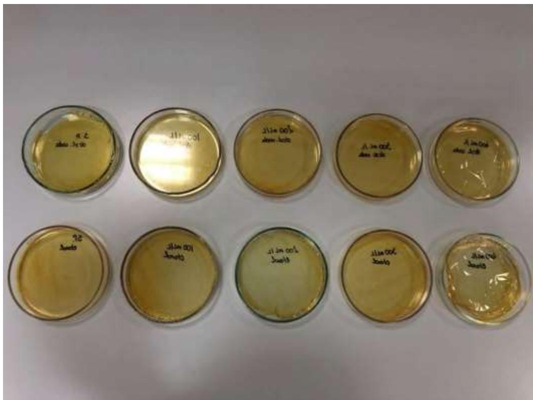
**Slika 10.** Pripremljeni filmovi nakon sušenja u Petrijevim zdjelicama.
