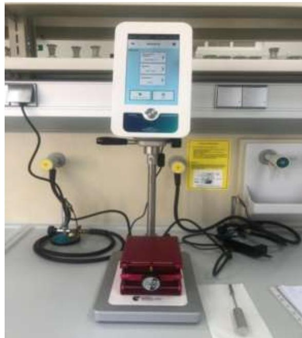
**Slika 7.**Rotacijski viskozimetarFirst plus LR.
