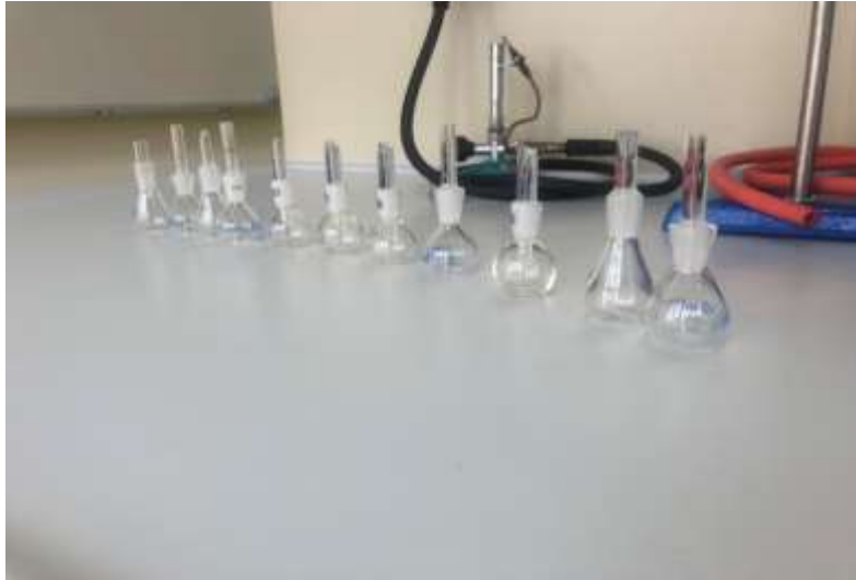
Slika 6. Piknometri korišteni za određivanje gustoće otopina.
