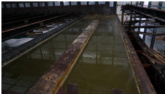
Slika 34. Kada za odmašćivanje[7]
