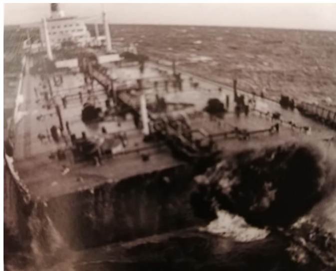
Slika 2. Primjeri brodoloma zbog korozije [1].
