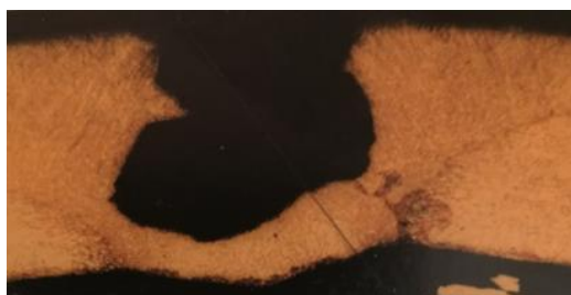
Slika 8. Propagacije pita (Rupičasto oštećenje zaštite cijevi grijača vode u bojleru za toplu vodu)[1].
