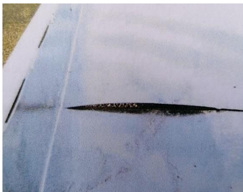
Slika 49. Toplinske deformacije lima [8]
