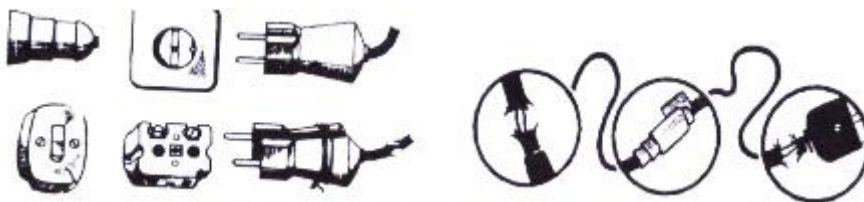
Sl.3.2.4. Neispravne utikačne naprave i električni vodovi
