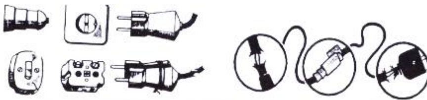
Sl.3.2.4. Neispravne utikačne naprave i električni vodovi
