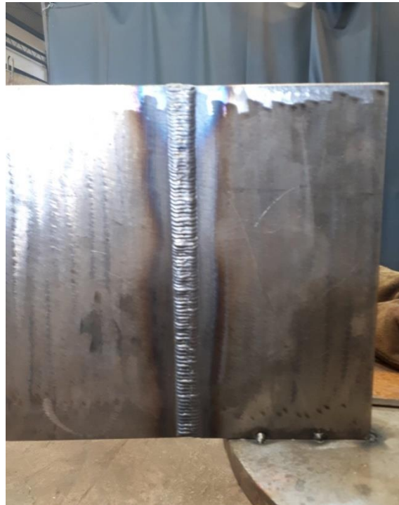
Slika 19. Treći prolaz i kompletno zavareni testni uzorak
