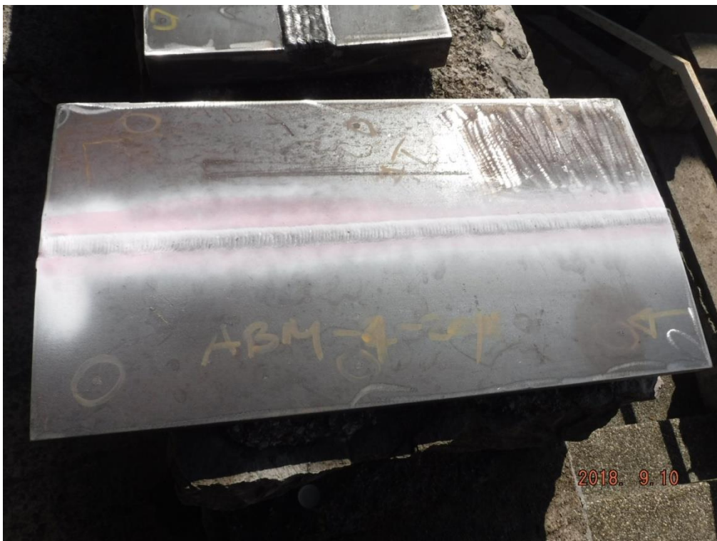
Slika 24. Nanešen razvijlač, držati 10-15 min, evidentirati indikacije nakon isteka vremena
