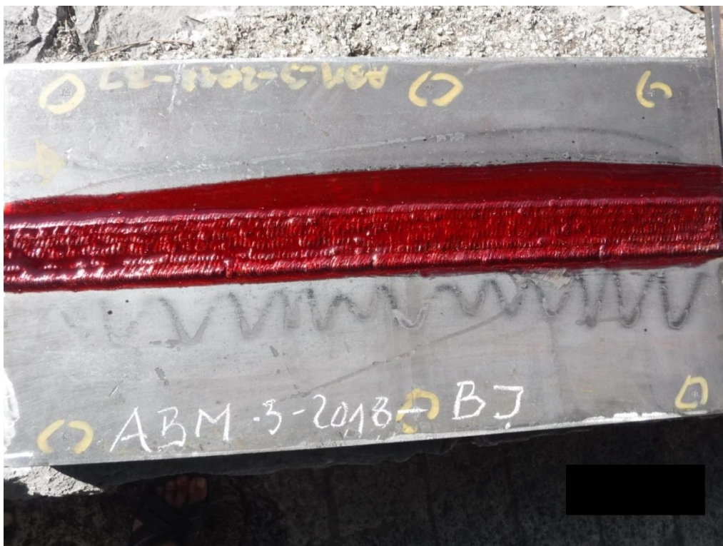
Slika 20. Testni uzorak 1 - Nanešen penetrant, držati 10-15 min.
