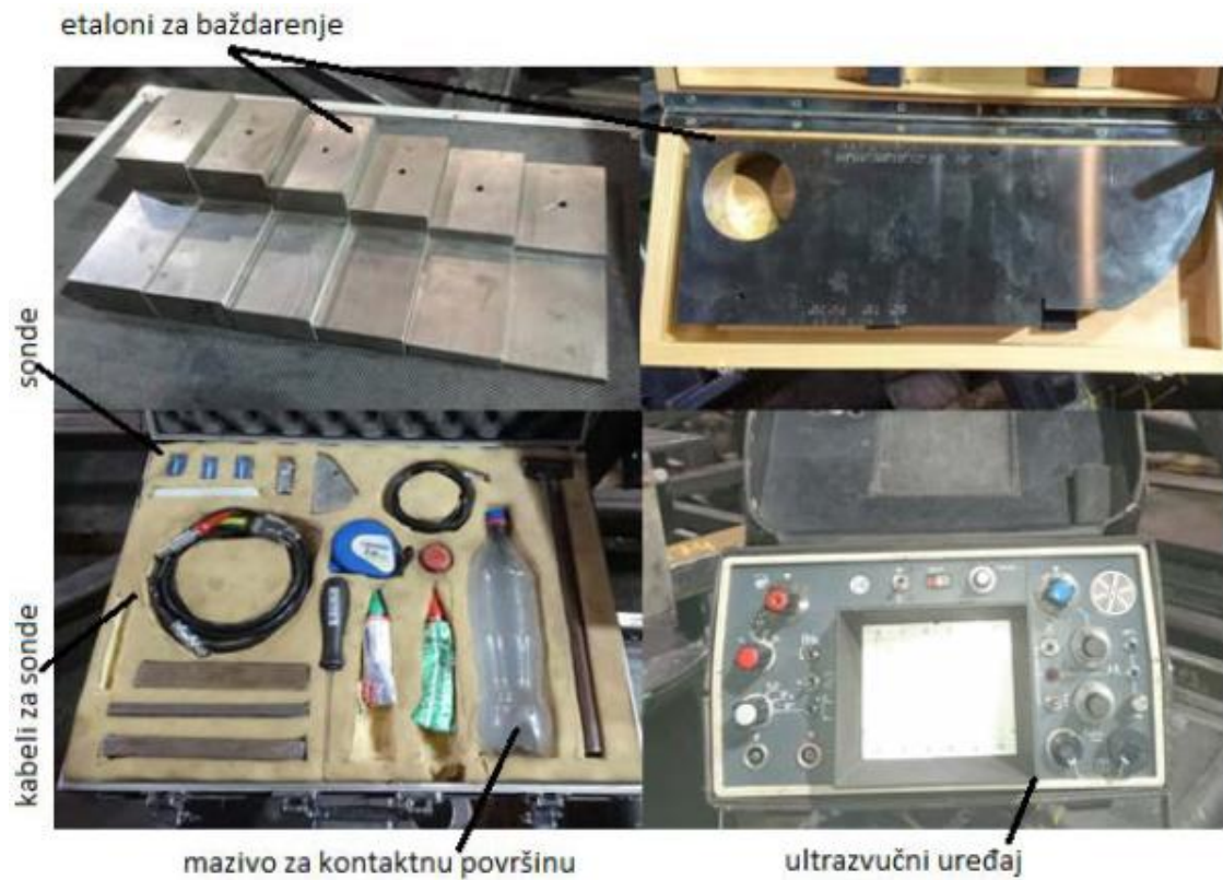
Slika 28. Oprema za ispitivanje ultrazvukom
