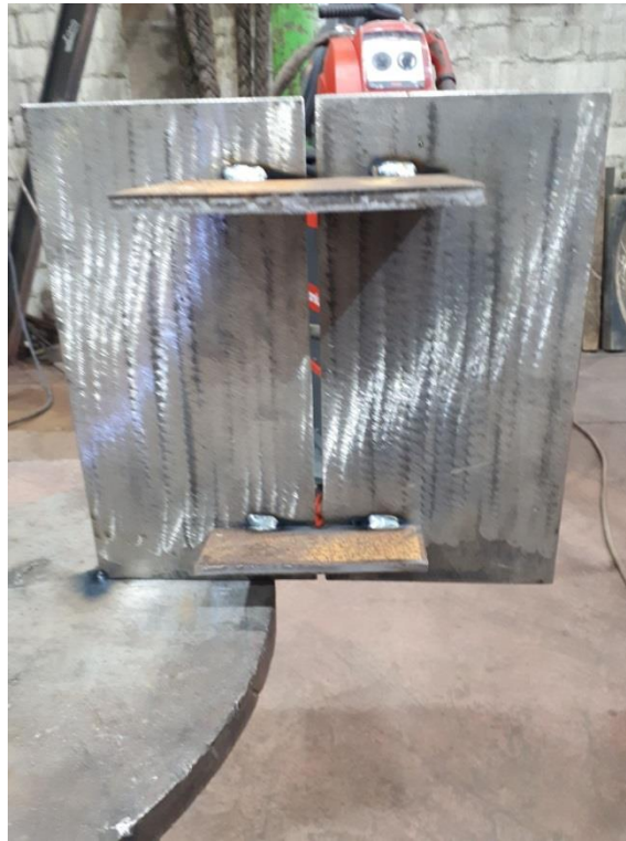
Slika 14. Testni uzorak – pomoćni limovi za održavanje razmaka
