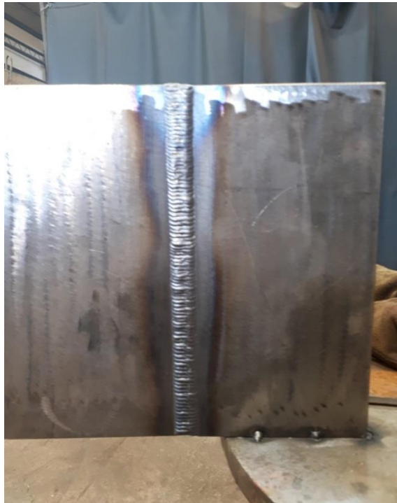
Slika 19. Treći prolaz i kompletno zavareni testni uzorak
