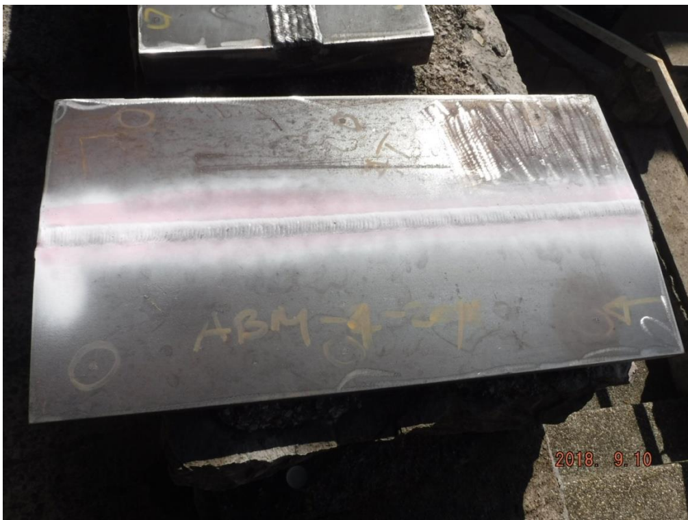
Slika 24. Nanešen razvijač, držati 10-15 min, evidentirati indikacije nakon isteka vremena
